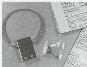
▲スワロー誘電のプリアンプはアマチュアでも頻繁に利用されている(これは1200MHz帯用)。
