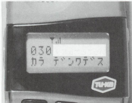
▲デジタル式携帯電話では、かかってきた電話の番号を表示する機能がある。ただし、表示されるのはデジタル式携帯電話かISDNの一般回線（ただし、かける側の設定が必要）。
