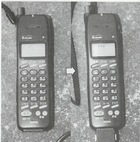
▼ベースアンテナを付けていない状態では1くらいしか振っていないかったものが、付けたとたんにフルスケールだ！
