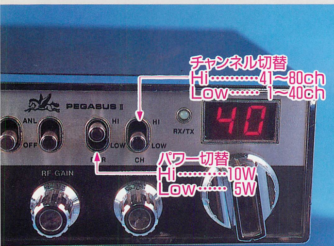
▲アマチュア無線でAMモードはVFO方式だが、CBはチャンネル式になっている。チャンネル番号はLEDでデジタル表示される。
