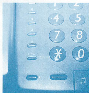
▲この「トーン」スイッチの切替ひとつで、ダイヤル回線からでもプッシュ信号を送信することができる。切替方法は電話機による。
