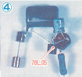
▼10Vツェナーの上に100 \mu Fケミコンをハンダ付けする。これも極性に注意。
