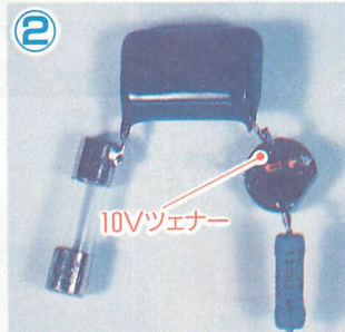
▲W02の+、-出力端子の間に10Vツェナーをハンダ付けする。極性に注意。を取り除きます。仕上げに78L05の入出力部に0.1 \mu Fの積層セラミックコンデンサをかまして高周波ノイズも取り除きます。
