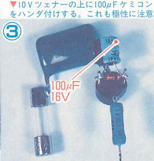
▼10Vツェナーの上に100 \mu Fケミコンをハンダ付けする。これも極性に注意。
