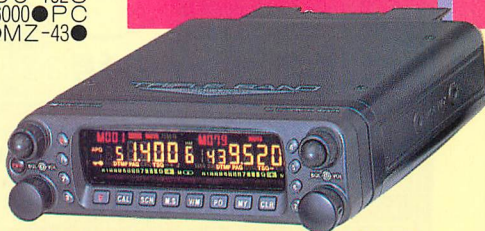
改造することでワイドFM受信もできる50/144/430MHz帯トリプルバンドモービル機「マランツC5900」
