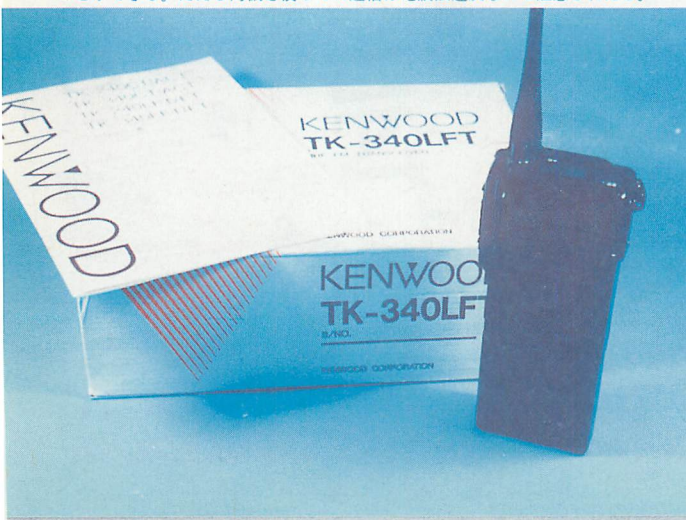
▲ケンウッドの輸出用業務無線機『TK-340LFT』。送受信周波数は固定で、なおかつトーンが一致しないとスケルチが開かない仕様になっている。
