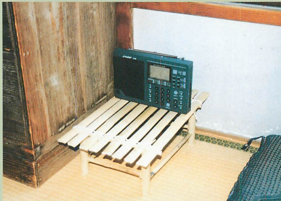
◀ラジオはただ置けばいいわけではなく、受信する局によって置く方向を変えると感度がよくなります。
