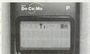
▲正常に動作していたときはSが3つくらい振っていたのに、Sが1つになって圏外表示が出ている。
