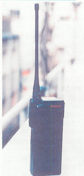
▲ケンウッドの輸出用業務無線機『TK-340LFT』。送受信周波数は固定で、なおかつトーンが一致しないとスケルチが開かない仕様になっている。
