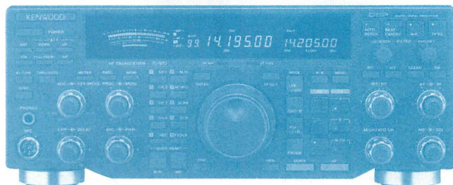
▲ケンウッドのTS-780。受信部にデジタル技術を用いて混信除去に威力を発揮する。こうした高性能機でHF帯にチャレンジしたいものだ。
