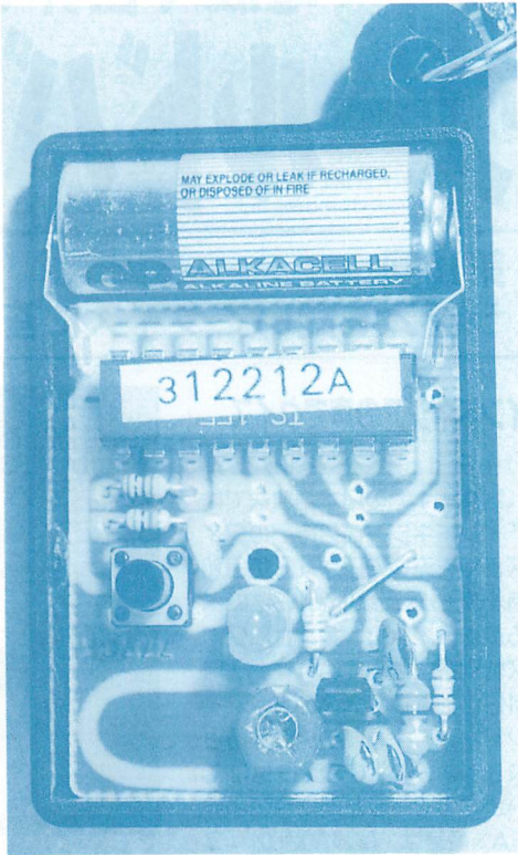
▲無線リモコンの内部。信号はデジタル式で、誤動作を防いでいる。小さくまとめているのはさすが無線メーカー。
