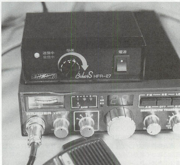
▲シンワ無線(☎0775-86-5780)から販売されている26~28MHz帯受信アンプ、HFR27。感度調整ツマミでゲインコントロールができるので重宝する。"DX通信=パワー"と思っている人には受信アンプを試して欲しい。
