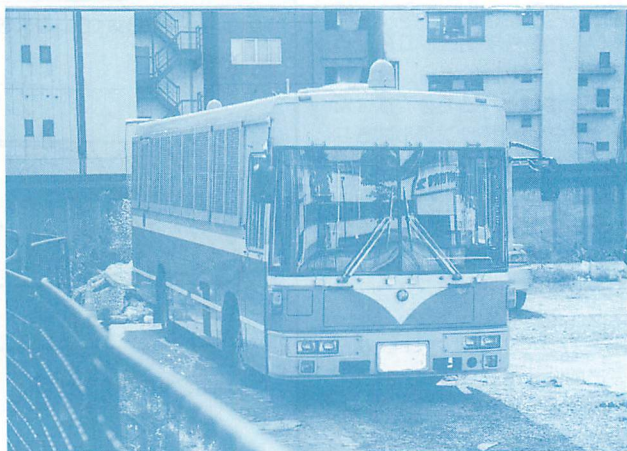
▲よく街でみかけるこの車両は護送車ではなく、大型輸送車。窓につけられた金網は、暴徒の投石対策でつけられている。護送車は窓には金網はつかず、窓の内側に鉄格子が横むきに取付けられている。
