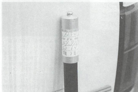
▲マッチング調整はアンテナ先端のねじを緩め、キャップを回すだけ。キャップに貼ってあるのは電波測定調査証だ。
