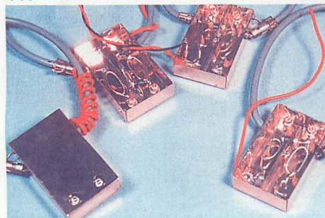
◀ HEMT (FHX35LG) を使用したスワロー誘電のプリアンプキット。製作といってもHEMTハンダ付けするだけなので、比較的簡単に作ることができます。50/144/430/1200MHz帯の4種類あります。価格は4,300円（秋月電子・千石電商）でした。
