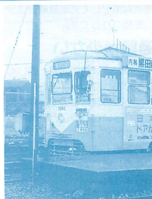
▲路面電車にも無線機が。アンテナがh型で高能率ですから受信できる範囲も広がります。
