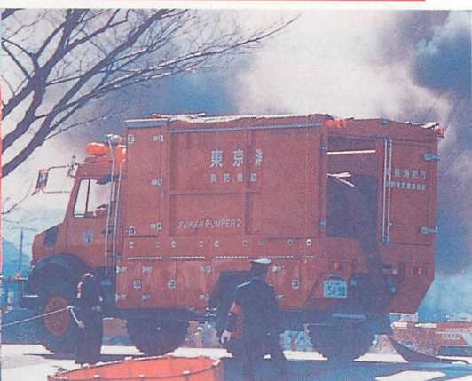
▲今回は行進などは省略して、車両のピックアップを中心にいたします。まずこちらは消防救助機動部隊の遠距離送水を可能にしたスーパーポンパー、2本部送水2ホースが太いのが分かりますか？ 後ろと前からホースが出ています。
