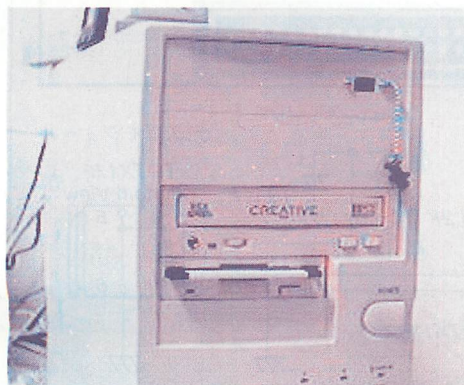
▲完成した光伝送モジュールボード。ジャンクのプロピディスクドライブから外した電源コネクタを使ったので見栄えもよく、すっきりしました。
