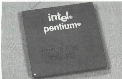
▲パソコンの頭脳、CPU。これは、Pentium-133MHz。外部66MHzを内部で2倍にして、約133MHzで動作しています。現在では、66MHzを3倍した200MHz品が最高。
