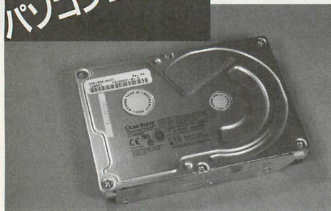
▲E-IDEインターフェイスのハードディスク。容量1.2GB。既に半分埋まっている。インターネットで画像を取り込むとあっという間に一杯になってしまう。
