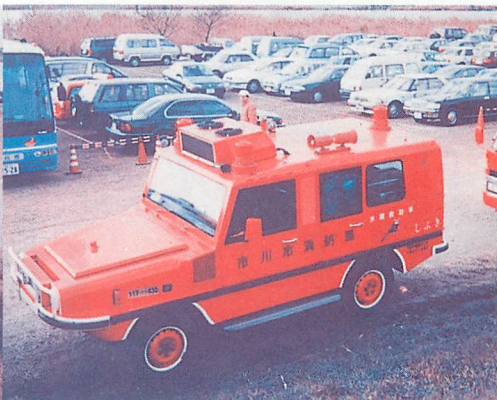
▲ボンネット型で前輪の前がえぐれていて舟の舳先のような ですが、それもそのはず市川市消防局自慢の水陸両用車、しぶ きなのです。
