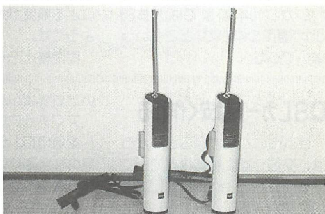
▲ジャン、ストーブの点火用ライターを彷彿とさせますがれっきとしたCB。それも免許申請がいる本格的なもの。スピーカとマイクは当時のことですから当然兼用です。
