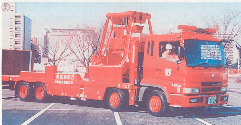
▲今回は行進などは省略して、車両のピックアップを中心にいたします。まずこちらは消防救助機動部隊の遠距離送水を可能にしたスーパーポンパー、2本部送水2ホースが太いのが分かりますか？ 後ろと前からホースが出ています。
