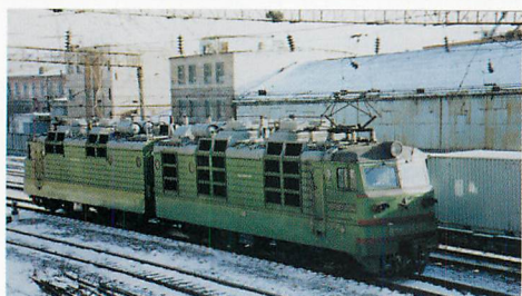
▲B7（ヴェーエリ）80型電気機関車。交流型で出力は6000 kW以上もある超強力型。
