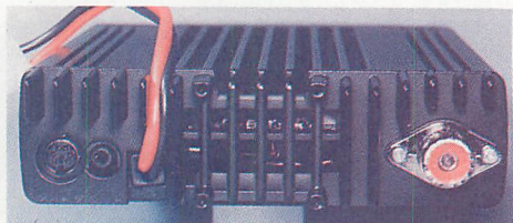
▲背面は20W化やハイパワー化を受けて放熱をよくするように工夫されています。
