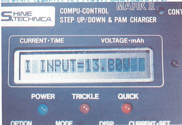
▲これはインプット電圧を測定表示しているところ。上の写真のように積算電力も表示する。
