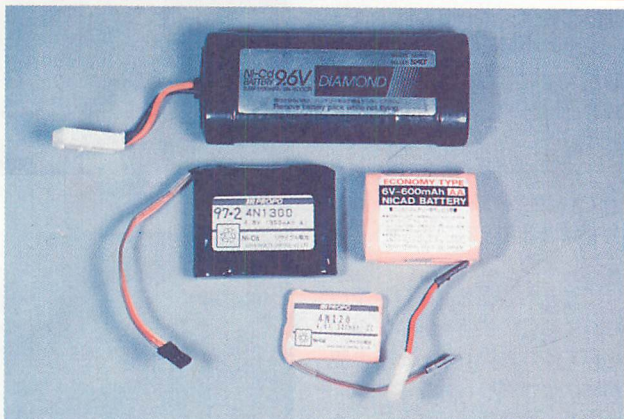
▲ラジコン用バッテリーにはいろいろな種類がある。写真上から9.6V1100mAh。中左は4.8V1300mAh。右が6V600mAh。下が超小型軽量の4.8V120mAh。
