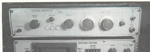
▲これがトラッキングジェネレータ。ペラのスペアナの測定範囲の周波数帯域を発振しながら周波数を高くしていくもの。
