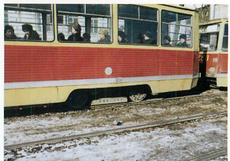
▲市電は大きさがまちまちのまま連結されています。さて台車の下に四角い部品が見えますが、これは電磁石で、凍結滑走を防ぐ為のレールブレーキというものです。
