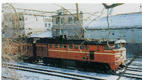
▲こちらは極東鉄道の車両。ディーゼルで電気を発電してモーターを回す方式の電気機関車。
