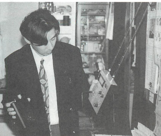
◀▼盗聴発見器が反応した窓際付近を再度DTMFや周波数カウンタによって調査する。
