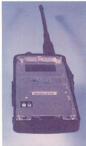
▲アルミダイキャストシャーシには、バッテリー固定の突起が設けられている。この突起がバッテリーケースにしっかりとはまり込むので、簡単には外れない?
