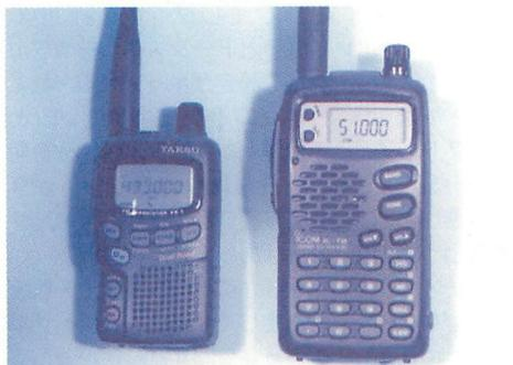
▲ヤエスVX-1(左)とアイコムIC-T8(右)のキー配置を比較。VX-1は縦に配置するキーを左側に寄せているが、IC-T8は右側に寄せている。設計方針の違いだ。
