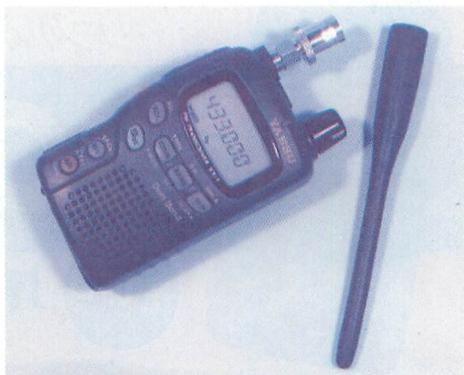
▲これ1台でハンディ、モバイル、固定と活躍してくれるVX-1。最大1W送信は十分実用になるだろう。固定やモバイルでは、外部アンテナを付けて欲しい。VX-1はアンテナコネクタがSMAだが、写真のような変換コネクタでBNCに変換可能。
