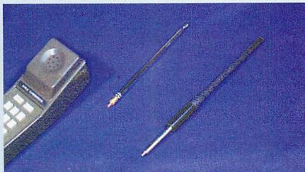
▲子機のアンテナはロッドタイプと小型ヘリカルアンテナの2タイプが選べる。
