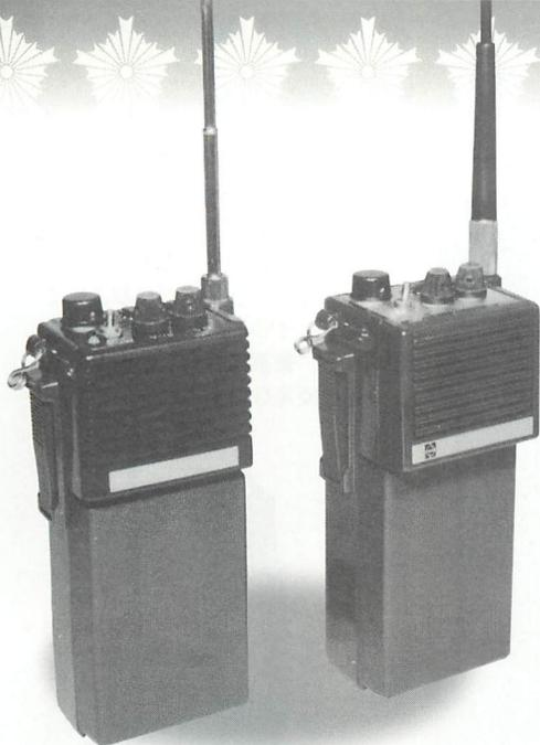
▲左がナロー化前のEK-3110NT。右がナロー化対応のEK-3110NPT。アンテナは、ロッドかホイップの好きな方に付け替えられる。
