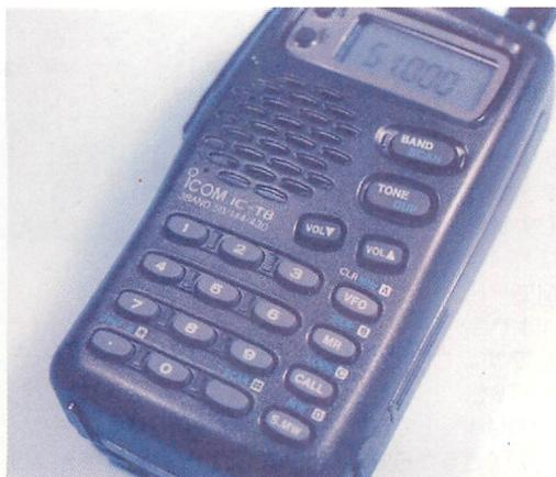
▲ツマミは回転選局ダイヤルにとどめて、操作は主にキーで行なう。ファンクションキーを使わず、キーを押す時間の長さで、ひとつのキーを2通りに使えるようにしている。
