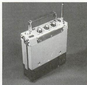
▲可搬時は、ロッドアンテナとキャリングハンドルを引き出して使用する。
