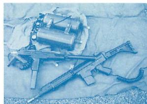
▲90年代初頭まで主流だったフルオートガスガン。当初はフロンガス缶十空き缶プースターが主流だったが、外気温に影響されないエアタンクが主流となる。現在は電動ガンにその座を奪われ、使用者も減った。パワーアップが簡単であるためパワーゲームを好むゲーマーに愛用される携行が強い。
