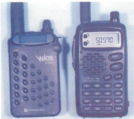
▲ハンディタイプで3バンドといえば144/430/1200MHzが定番だったが、アイコムのIC-T8は50/144/430MHzとローバンドVHF帯を内蔵した。60MHzの防災無線は受信できるトランシーバーがなく、レシーバーの独壇場だったが、IC-T8の登場でAX400Bの地位も安泰ではなくなった!?
