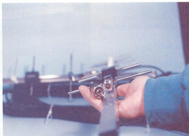
▲アンテナ給電部はTNCコネクタを使用して800MHzという高周波のロスを最小限に押さえている。
