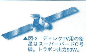
▲図-2 ディレクTV用の衛星はスーパーバードC号機。トラボン出力90W。
