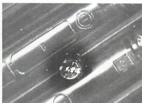
▲RJ-480の電池ボックス内にある封印。
