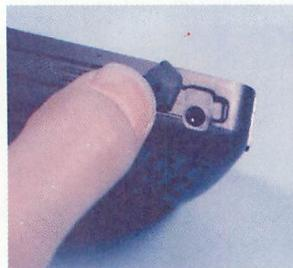
▲IC-T8には外部電源端子が設けられている。
