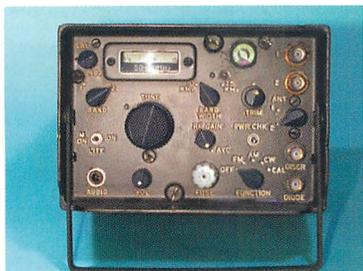
▲外部電源以外はすべて正面にレイアウトされている。
