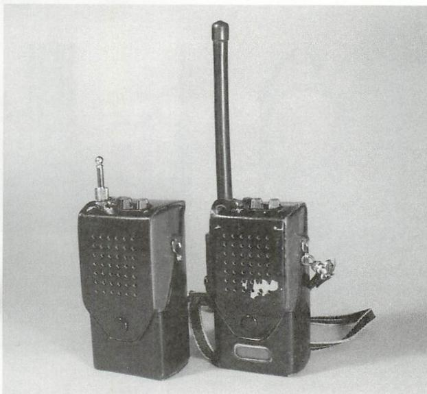
▲アンテナはロッドとヘリカルの2種用意された。革ケースは警察仕様と同じ。右は電力会社で使用していたもので、ユーザーの要望によりコールサイン差しが設けられ、革ケースにも穴があげられている。
