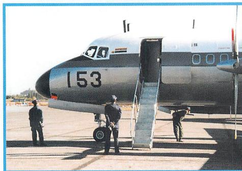
▲タラップの無い飛行場でも乗り降りができるように機体にタラップがセットされている。写真でも分かるように、機内のスペースを取らないように複雑に折り畳まれて収納されている。
