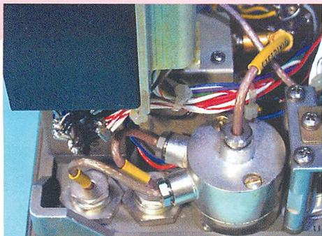
▲まるで測定器なみのアンテナ切替器。アンテナはBNCとTNCの2系統が選択できる。
