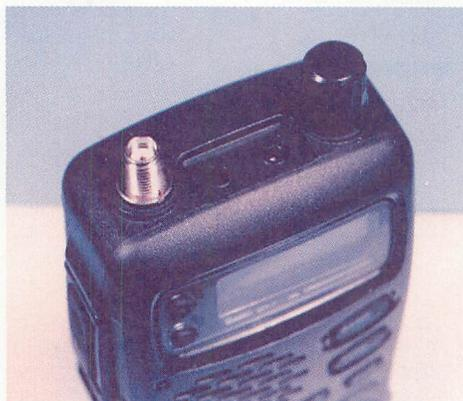
▲SP/MIC端子の防水キャップを外すと、SMAコネクタの止めネジが現れる。このネジを先細のペンチ等で慎重に外し、ダイヤルツマミを抜き取ります。
