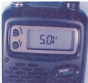
▲電源を投入すると、電圧表示される。電池の消耗度をチェックできるので便利だ。
