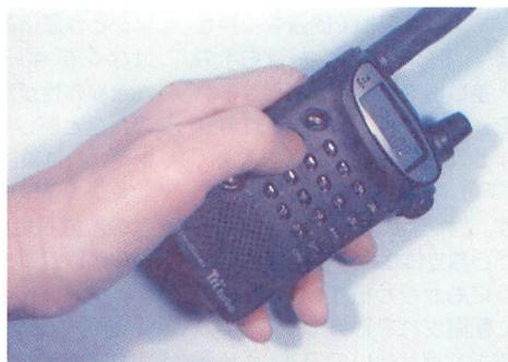
▲マランツのC710は、テンキー両脇に機能キーを縦に配置しているが、操作頻度の多いキーを左に寄せて、左手だけで主要な操作ができるようになっている。
