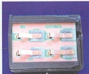
▲子機の底面には外部アンテナ端子がある。オプションのバッテリーユニットを使用すれば子機も外部アンテナが使用可能。
