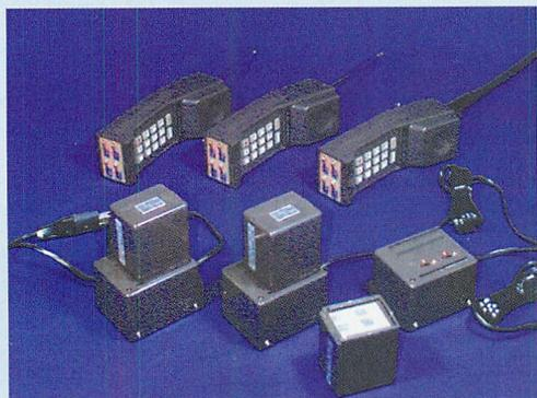
▲フルセットモデルは3台の子機と各個に専用充電器がセットされている。
