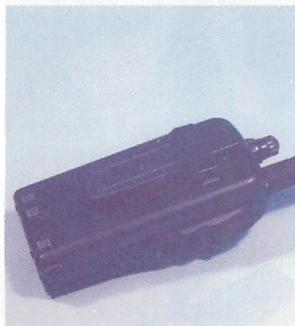
▲簡単に脱着できるベルトクリップ。バッテリーケースと共に、本体同様ポリカーボネイト樹脂製で耐久性はバッチリだ。
