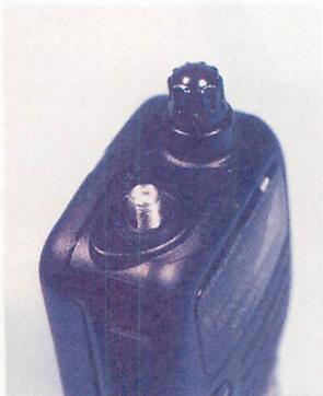
▲アンテナ端子はSMA。ツマミは上側がメインダイヤル、下側が音量調整用だ。
