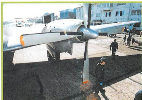
▲英国ロールスロイス社製ダートMk542-10。ターボプロップエンジンからは、15,000rpmもの力を絞り出す。
