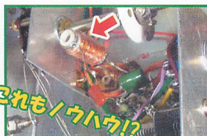
▲最短配線が基本の高周波部分だが、入出力の結合による異常発振などを防ぐため、RFCの配置には気をを使う。
