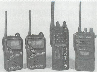
▲422MHzFMの電波を用いる特定小電力トランシーバー。近距離連絡用無線だ。
