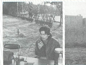
▲800mを超えた地点では、外部アンテナを繋ぐことで通話が可能となった。長距離交信を可能とするには、アンテナが重要となる。
