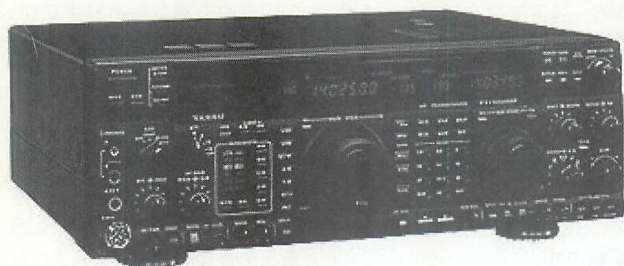
▲HF帯オールモードトランシーバー「FT-1000MP」(価格：370,000円)。2アマ以上の資格が必要。
