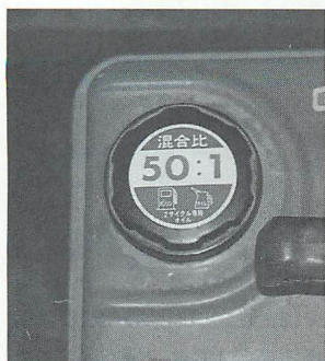
▲各部の調整・清掃が済んだので、給油をしていざ始動。しかし発電機は混合なので注意が必要。
