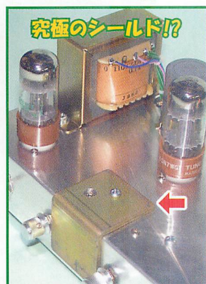
▲電源ハムを避けるため、シールド板を取り付けた。電源トランスとシールド板の位置関係の様子。磁束方向の考察とテストの結果、この位置に収まった (詳しくは本編参照)。
