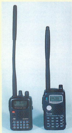
▲ヤエスの50/144/430MHz機、VX-5(左)とアイコムの50/144/430/1200MHz機、IC-T81(右)。どちらもローディングコイル入りの長いホイップアンテナが特徴。
