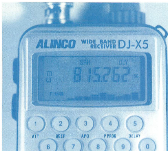
▲DJ-X5の優れた機能の一つ、9チャンネルスコープ機能。この機能を使うことで、受信している周波数以外にも、どこで電波が出ているのかが、耳ではなく目で知ることができる。
