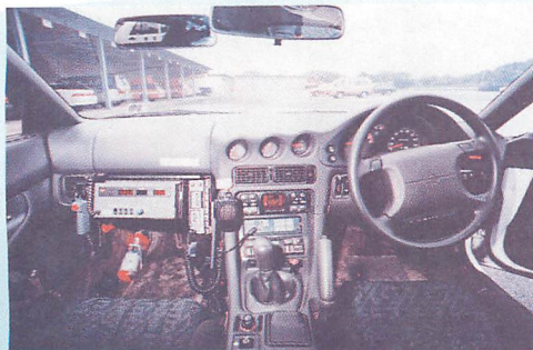
▲助手席に、レーダー装置と警察無線機が取り付けられているので、足元はかなり窮屈。サイレンアンプはパトライト製。
