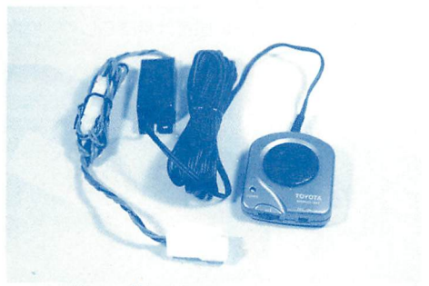
▲トヨタ製アンプ付スピーカーは700円！ちょっとした改造（改造資料は付いていた）で、無線機などの拡声用に利用できる。電源は13.2Vなので車載用だ。
