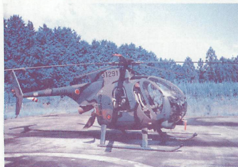
▲OH-6D ローター直径8.05m、胴体長7.06m、全高2.73m、最大全備重量3000kg、巡航速度129kt、航続距離278nm。
