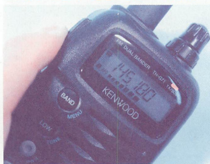
▲TH-G71の送信インジケータはパワー表示ではなかった。バッテリーの状態を示すのだ。
