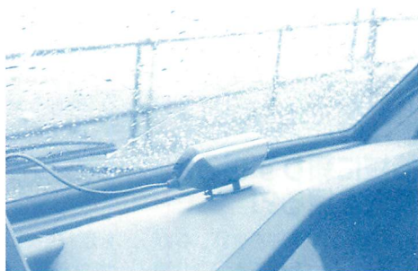
▲赤外線ビーコンからの信号は、コントロール上にセットした受光器がキャッチ。
