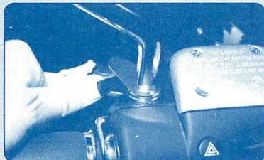
▲PTTスイッチはハンドルに取り付けてハンドリングの邪魔にならない様にする。
