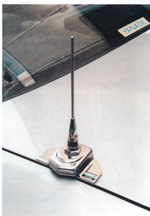
▲トランクリットアンテナ基台を使用すればスマートな運用が可能。
