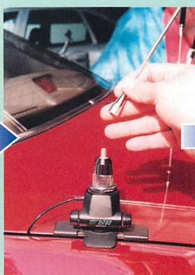
▲M型基台に取り付けただ変換コネクタの上に取り付けるだけ。
