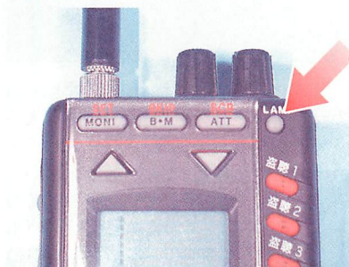
▲周波数入力中にLAMPキーを押すと周波数が確定する。例えば、1と入力した状態で、LAMPキーを押すと100.000MHz、11と入力した状態でLAMPキーを押すと、110.000MHzに固定される。
