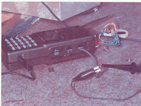
▲IF信号外部出力改造を施したAR8000。
