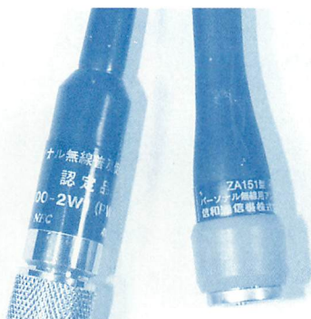
▲HR-8にはTNC、PR-6はBNC型のアンテナ接栓が採用されている。
