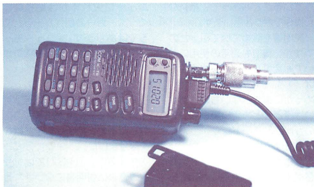
▲外部アンテナとスピーカーマイクを取り付けるとこういう状態になる。M-SMA端子の場合、スピーカーマイクジャックとくっついてしまう。
