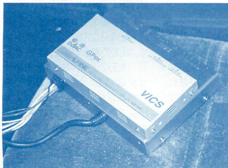
▲VICS対応カーナビに専用FMチューナーを取り付けるとFM多重方式のVICSに対応する。写真はアルパイン製のもの。
