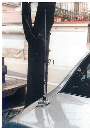
▲トランクリットアンテナ基台を使用すればスマートな運用が可能。
