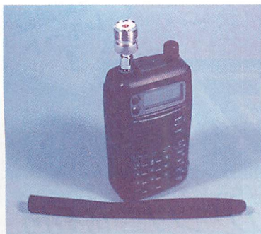
▲外部アンテナを付けたときは、変換コネクタを用いる。写真はM-SMA端子を取り付けたところ。SMA端子は細いので、根元部分に不用意に力を加えないようにしよう。
