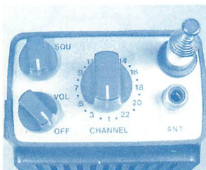
▲トップパネルの様子。スケルトンツマミと電源スイッチ兼用のボリュームつまみが並んでいる。中央がチャンネル切換ツマミ。
