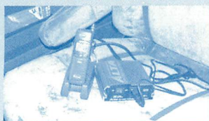
▲携帯電話の充電もインバータがあればお手のもの。車用の充電器を用意しなくても、付属充電器が使える。
