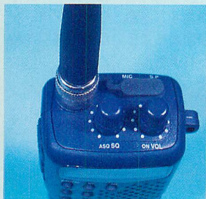
▲QSLツマミを左に回しければ、オートスケルチが動作。
