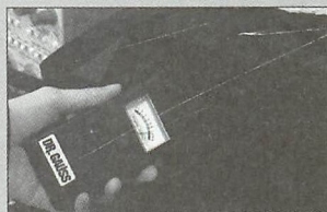
▲モニタから発生する低周波領域の電磁波には遮蔽効果が少ない。
