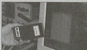
▲対象物に向けて計測します。メーターの振れと音で磁界の強さを判断します。
