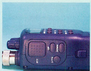
▲本体側面にあるPTT-SW部にはチャンネル切換やバックライトSWを装備。PTTはマイクロSW採用で感触は最高！
