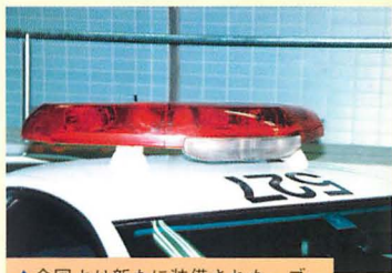
▲今回より新たに装備された、ブーメラン型の散光灯。空力特性を考えた最新モデルでは、GTOなどの高速型のパトカーでは、その性能が発揮されるであろう。
