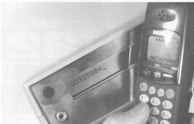
▲マイクから拾ったDTMF信号を解読してくれるのがD-MON32のいいところ! 携帯電話のダイヤリング時、スピーカーから聞こえるDTMF信号も難なく解読。
