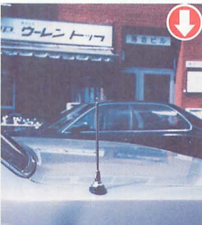
▲今回は撮影用にF-1アンテナを取り付けているが、平成元年以降警察無線用アンテナは、自動車電話型のTLアンテナに変わっているの、最近では取り付けている車が少なく、アンテナの跡の穴はゴムキャップで蓋するのがベスト。納入時にはF-1アンテナを取り付けていたがアンテナ切り替えのため取り外したというドラマが生まれる。
