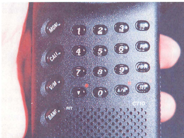
▲C710の操作キーは、透明キーの下に文字が置かれている。長年使っても、文字がすり減ることのないような工夫だ。他メーカーを見ても、ここまで気を使った機種はないのでは。
