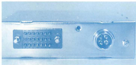
▲本体正面には、コントロール部接続用のコネクタとマイクコネクタがレイアウトされている。
