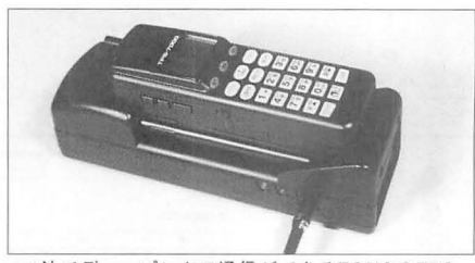
▲1波でデュプレックス通信ができるTONOのTPS-7000。現行の製品では電話回線と接続することはできないが、フォーンパッチ解禁で対応バージョンが発売されたら、この上なく便利な活用ができるはず!
