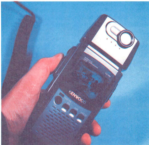
▲多機能マイクの究極の姿？ これはケンウッドのSSTV用端末VC-H1。映像の伝送機能はともかく、液晶テレビを用いた大きなディスプレイに周波数表示などのデータが映し出されたら面白いと思う。
