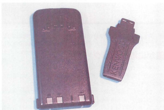
▲背面式バッテリーは評価が別れるのではないだろうか。背面バッテリーを交換するときはベルトフックを取り外さなければならない。ベルトフックの取り外しは堅くて心配。
