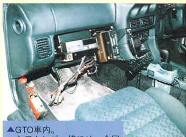
▲GTO車内。シフトレバー横には、全国で初めて導入された、Hシステム映像受信機が装備されている。このHシステム受信機は、Hシステムにより発見された違反車両の映像を瞬時にパトカーに電送し、その映像をプリントアウトできる装置で、違反車両検挙威力を発揮する。
