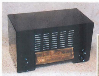
▲EMERSON 米国 1940年代 ¥36,000 AM/FM切り替え。GT管7球スーパー。ループアンテナ内蔵。
