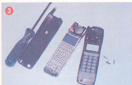
▲基板と前面部を外します。 ツメで固定されているので気を付けて。
