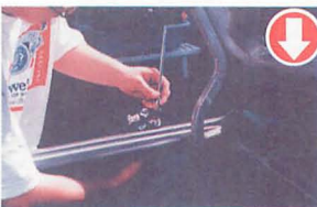
▲ラジオアンテナを外した後は穴が残るのでF-1アンテナを取り付ける。
