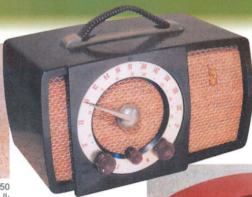
▶SPARTAN 米国 1950年代 ¥28,000 GT/MT管5球スーパー。ループアンテナ内蔵。
