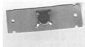
▲GaAs FETの3SK113が採用されている (144MHz用)。他のバンド用は3SK121。
