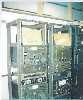
▲旧タイプのUHF対空無線機 AN/GRC-27
