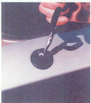
▲ラジオアンテナの上部をラジオペンチで外す。
