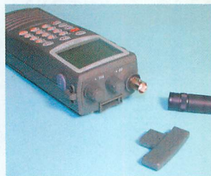
▲通常のアンテナはBNC端子だが、中波用のTバーアンテナを別途差し込むことができる。Tバーアンテナは付属する。
