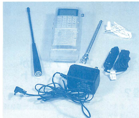
▲箱を開けた瞬間から受信が楽しめるセット。アンテナ2 本・ACアダプター・シガーソケット・イヤホン・ニッカ ド電池がセットされている。
