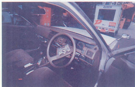
▲運転席周り全てを交換するので、助手席前のグローボックスとハンドルを外す。
