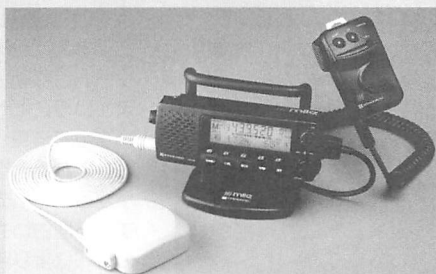
▲日本マランツから8月下旬に発売されるC5750。144/430MHz帯の小型・ミニパワーモバイル機という位置づけだけでなく、オプションのGPSレシーバーをセットすれば位置情報のデータ送受信が可能になる。
