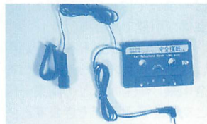
▲左がマイクとサンバイザー用クリップ(これは取り外し可能)、右がカセットアダプタ、下が携帯電話との接続プラグ。
