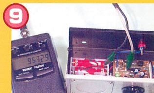
▲周波数カウンタを使って、メインダイヤルの周波数合わせを行いました。周波数カウンタがない場合は実際の放送を受信しながら局発コイルの調整を行います。
