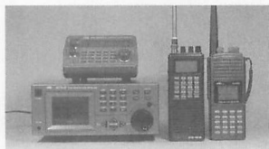
▲530KHz～1300MHz以上の受信帯域を持つ「広帯域受信機」。これさえあれば、有益情報がゲットできる。
