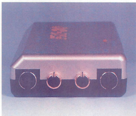
▲FX-30 Specialのプラグ面。左から、S端子入力、ビンプラグ入力、ビンプラグ出力、S端子出力。
