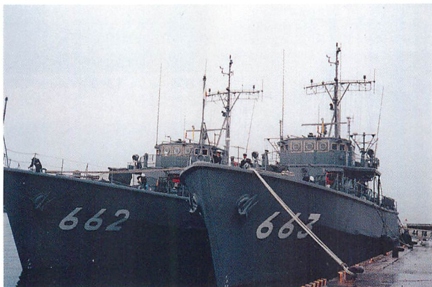
▲第44掃海隊所属「えたじま 663」「ぬわじま 662」。ともに全長55m、基準排水量440t、最大巾9.4m、速力14ノット、1440馬力、乗員43名。
