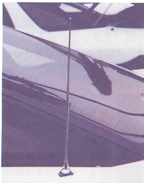
▲警察無線アンテナは、覆面パトカーに多く導入されていた、F-1型アンテナをリヤスポイラー脇に設置。なぜパトカー用アンテナを使用しなかったのかは不明。
