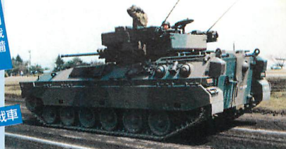
◀78式戦車回収車 74式戦車をベースに開 発。故障・破損した戦 車・装甲車の回収・整備 に使用。
