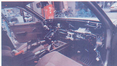
▲全てのネジを外し。配線に気を配りながらダッシュボード全てを外す。この作業は、気合と根性があるので、よほどのことがない限り行わない方が良いでしょう。改造というより、解体に近い作業となります。
