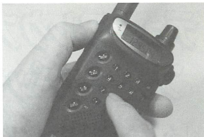
▲ハンディ機からAPC-21を遠隔操作するにはDTMF信号を利用する。DTMF信号は送信しながらテンキー操作で送信できる。ただし、旧式のハンディ機ではDTMF信号が送信できないものもあるので注意。
