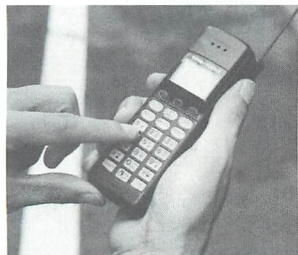
▲TPS-7000で電話をかけるのは簡単。テンキーで電話番号を押して『TALK』キーを押すだけ。すると、自動的に送信が始まり、基地局と交信可能エリアであれば同期を取った後に電話の呼び出し音が聞こえてくる。あとは通話するだけ！ 通話が終わったら『END』キーを押しておしまい。使い勝手はまさに携帯電話！
