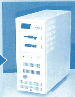
▲外観上では、CD-ROMやQICテープドライブの増設と筐体がキレイになったコトが判る。キレイになれば、一段と愛着が沸くのだ!
