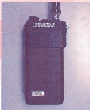
▲防水用Oリングのため少し傾くが、TR4P1W-9CTでも問題なく使用できる。
