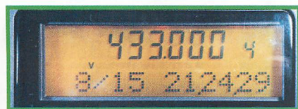
▲GPS衛星からの電波をもとに正確な日時を表示する。
