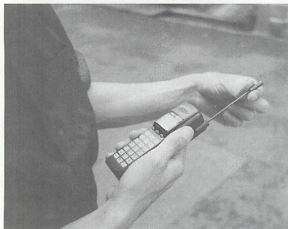
▲アンテナは伸縮式。アンテナを縮めた状態でも、問題なく着信した。なお、本機はシンプレクスモードを備え、一般のトランシーバーと交信可能（本体側面にPTTがある）。
