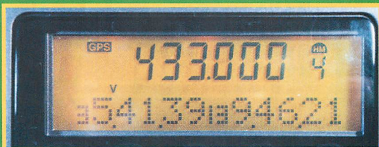
◀オプションのGPSレシーバーを接続すると位置情報を緯度と経度で表示する。写真では北緯35度41分39秒、東経139度46分21秒を表示している。
