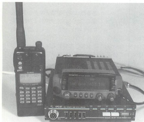
▲FT-51（移動局）、TM-V7（基地局）とフォンパッチインターフェイスAPC-21によるデュプレクス方式のシステム。
