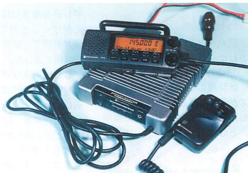
▲背面にはブースターCPB510（オプション）と接続するための端子がある。CPB510と組み合わせれば最大送信出力20W機に変身する。
