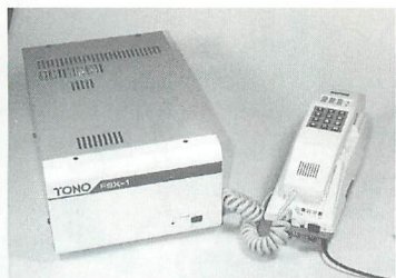
▲ベース（固定）機。固定用AC100V電源や本体のDC13.8Vを供給するための電源を内蔵し、電話回線へのインターフェイスを収納しているので大型で重い。
