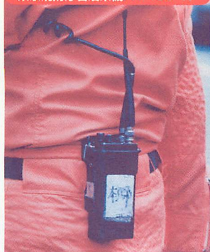
▲装着マウントにてベルトにつけられた「FR-400 1P」。バッテリーのNEC銘板に、東京消防庁のステッカーが貼られている。
