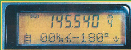
◀移動すると、自局の進行方向、速度を表示する。また、あらかじめセットした目的地や自宅、あるいは同システムを搭載した仲間の車の位置との相対距離・方向を表示させることも可能。
