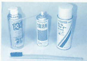
▲ホコリを吹き飛ばすダスターや接点復活剤の他に、クリーナーも必需品。筐体のしつこいヨゴレには、マジックリンを使った。
