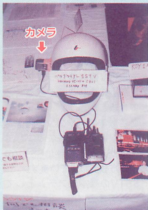
▲ケンウッドのビジュアルコミュニケーター、VC-H1とカードサイズハンディC401を組み合わせたパラグライダー用のSSTVシステム。静止画とはいえないリアルタイムの空撮映像は迫力あることだろう。
