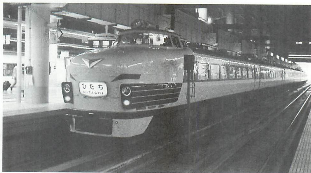
▲交流型車両の代表、485系特急電車。長距離の運行が可能なが特長の一つ。
