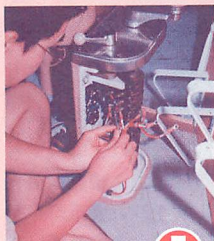
▲マスコンを分解。余計な配線を取り除きプレイできるように改造の下準備。
