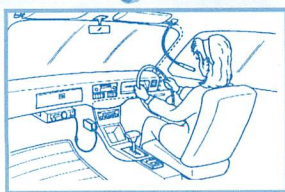
▲安全のためのモービルマイクも、昔から発売されていた。設置すれば左図のようにハンドフリーで通話が可能。
