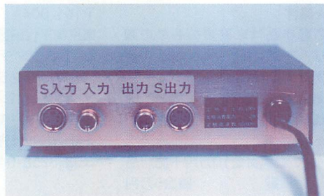
▲SD-800のプラグ面。左から、S端子入力、ピンプラグ入力、ピンプラグ出力、S端子出力。
