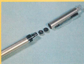
▲LR41電池が2個ないと動作しない。 電池はペンの上半分に収納される。
