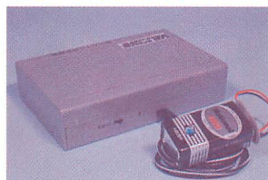
▲オプションの電池アダプターを使えば、006P電池一本でどこでも使用できる。
