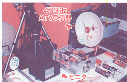
▲7GHzATV受信機。送信機からの電波をパラボラアンテナで受信し、モニターに映像を映し出していた。画像はカラーの動画映像だ。テレビのマイクロ中継回線と同様のシステム。
