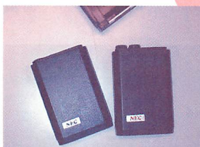
▲左がTR4P1W-9CT用のバッテリー。右がFR-400 1P用。色以外には、端子が防水仕様になっている点が異なる。
