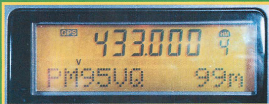
◀アマチュア機ならではの機能。緯度・経度情報をもとにグリッドロケーター表示してくれる。「99m」は高度を示す。
