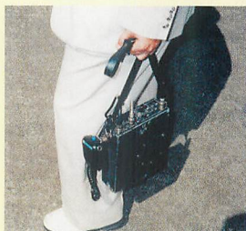
▲山陰本線では、Cタイプを使用しているが、出雲号はBタイプも使える列車無線機を使用。
