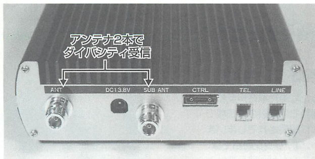
▲TPS-7000Bの裏面。電話回線用端子を備える。アンテナ端子が2系統あるのに注目。2本のアンテナでダイバシティ受信ができるのだ。
