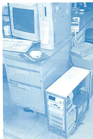
▲修理後、本体仮組みの状態で作動チェックを行う。無事起動し、ホッとしました瞬間!
