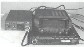
▲T・ZONEが販売するボイススクランブラーM-20と組んだ基地局。基地局の送信電波を秘話化する。基地局の電波は強く、また双方の音声に乗っているため、基地局側だけ秘話化するだけでも効果は大きいと思う。
