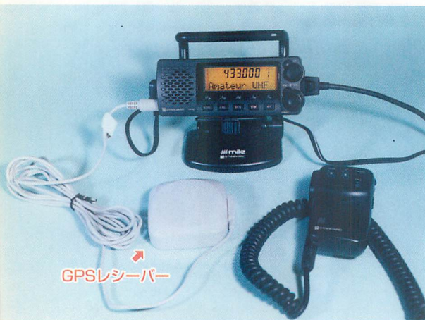
▲144/430MHz帯トランシーバー、C5750。愛称はミニステーション「マイル」。従来のモバイル機の実操作パネルの大きさに収めたコンパクトモバイルトランシーバーだ。スピーカーが正面に向いている点は実用的で評価できる。なお、スタンドとGPSレシーバーはオプション。
