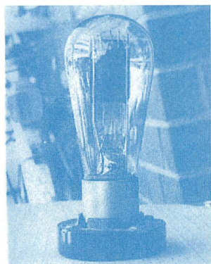
▲写真2 ナス管。写真はカニンガムのCX-381整流管。
