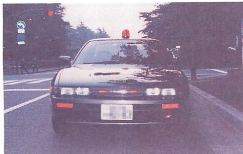
▲フロントグリル内には、赤レンズの前面警光灯を装備。バンパーに右側には、所属を示すステッカーが張られている。
