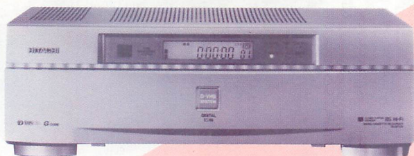
▲日立から発売されたデジタルCSチューナー内蔵D-VHSビデオデッキ7B-DF100。デジタルCS放送からの信号をそのままデジタル記録する記録装置といえる。DVのように「画面をデジタル変換して記録する高画質ビデオ」という位置付けではない。
