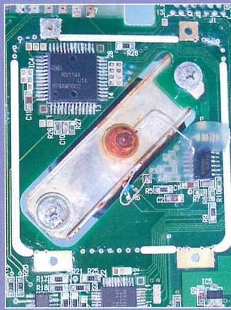
▲センサ出力はフラットパッケージのOP-AMP ICへ入力される。
