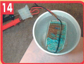
▲劣化が激しいため、端子電圧は約1V程度にしか復帰しなかった。残念！
