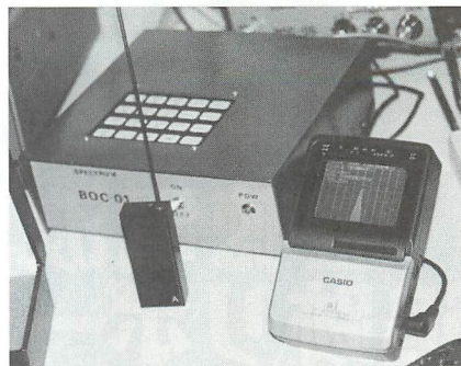
盗聴波の波形の特徴をスペアナでチエックすると、きれいな山の形に。
