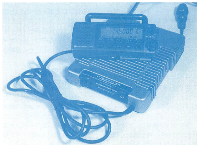
▲ハンディ機C510専用のリニアアンプだったCPB510はC5750にも接続可能。これで最大送信出力20W。電源供給やアンテナとの接続はCPB510側で行うので、C5750との接続はケーブル1本でOKだ。
