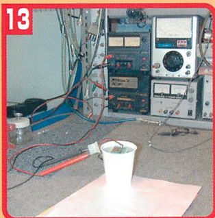
▲バッテリーは完全放電していたので、食塩水に浸して強制充電してみた。
