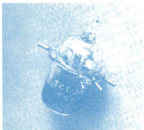
▲写真22 これはUFO用の真空管です。ウソですヨ! これ、親指より小さい真空管。エーコン管と言います。これは955(VT-121)。傍熱の3極管で、V、UHFのコンバーターやラジオゾンデなど軍部でも多用されました。親指位の大きさですが、C級増幅で出力0.5Wも出るんですよ。
