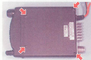
▲4つのビスを外し、底面側ケースを開ける。
