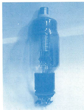
大電流を流せる水銀整流管2B28。
