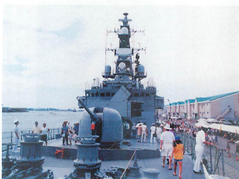
▲50口径3インチ連装速射砲。
