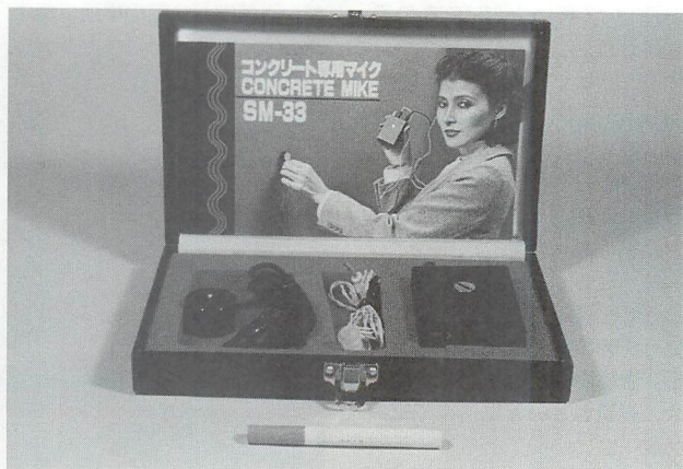
▲コンクリートマイクセット。 性能は意外と良く、マンションの壁などでも隣の部屋の音が良く聴き取れる。
