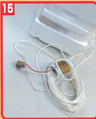
▲劣化が激しいため、端子電圧は約1V程度にしか復帰しなかった。残念！
