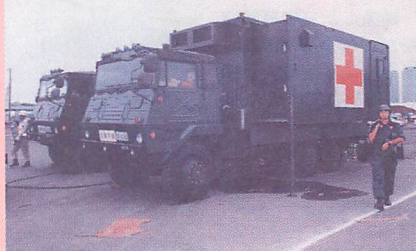
▲陸上自衛隊高射学校の野外手術システム。この車両のシステムは、手術に必要な機能を4分割し、手術車・滅菌車・手術準備車・衛生補給車としてシステムを構成。
