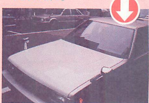
▲アクションバンドでは、穴を埋めるのではなく、ボンネットごと交換！費用はかかるが、きれいな仕上がりがとなる。なお今回はボンネットの色がボディーと違うので後から色を塗りなおさなければならない。
