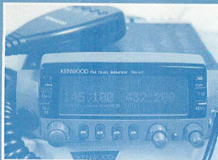
▲ケンウッドの144/430MHz帯モバイル機、TM-V7。改造後、クロスバンドレピーター機能を働かせることができる。
