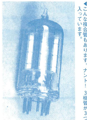
◀写真23 サブミニチュア管。サインペン位の太さです。現在なお、各方面で多用されています。
