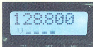
▲エアーバンド帯ではAM受信になる。128.80MHzの羽田空港ATISを受信中。ちなみに、周波数表示下はSメーター。「V」はVHF帯を表している。
