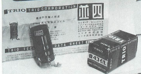
▲写真18 並四コイル。基本的に並三コイルも同じ。ストレート用コイルに再生巻線を追加したもの。
