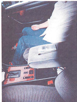
▲PHSには外部アンテナ入力端子が付いていないので、車内では変換機の横に端末をセットする。
