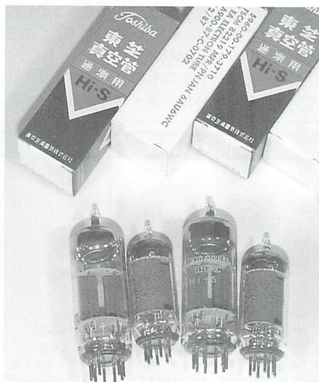
▲写真-1 12BH7Aと6AU6。メーカーは何でもOK! 6136という球もOKで、これは6AU6の高信頼管。
