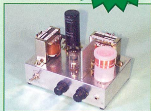
▲自作コイル+ポリバリコンという構成。自作の雰囲気を重視したと編集部員Aは語る。シャーシーサイズは150×100×40mm。
