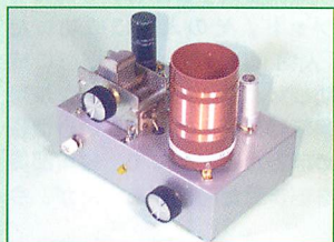
▲リッチなパーツで満足度(思い込み?)を追求したCの作品。コイルとバリコンが大型なので、シャーシーサイズは200×120×60mm。
