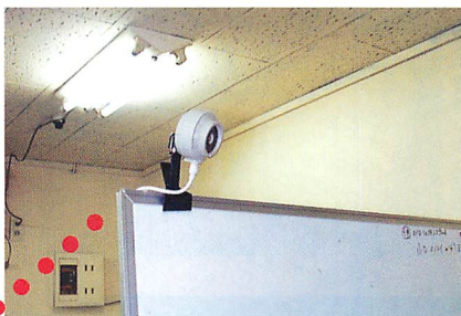
▲ビデオカメラはクリップではさめるところなら、簡単に取り付けられる（ただし、屋外では防水加工が必要）。
