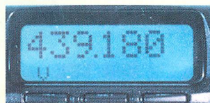
▲439MHzでは自動的にレピーターモードになり、送信は-5MHzとなる。レピーターモードの表示がないのにちょっと違和感を感じる（PTTを押すと434MHz台表示になるので、実際は不都合はないが…）。
