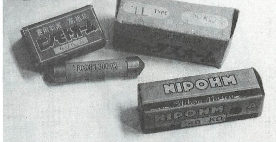
▲写真9 1ヶ1ヶ箱に入っているのはコンデンサばかりではなく、抵抗も高価な部品。リード線はなくてガラス管フューズのようにソケットにハマ込んで使います。
