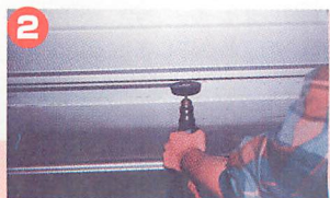
▲使い方のコツは、高い回転で使うのではなく、トルクを生かして、力で剥ぎ取るという感じで使う。写真でもわかるように、キレイに塗装面をキズ付けることなく、早く(!)簡単に(!)剥すことが可能!!
