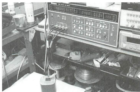
▲写真-8 これはLUXのチョークコイル。5Hの公称だが、安藤の校正済みLCRメーターで測定したところ、4.5Hしかなかった (I=0.1A f=120Hz)。
