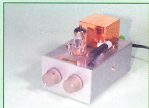
▲バーアンテナ+ポリバリコンをベースに小型化と見栄えを重視(?)した編集部員Bの作品。シャーシーサイズは80×120×50mm。
