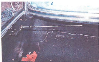
▲収納時は、アンテナを横に倒すだけの簡単操作。
