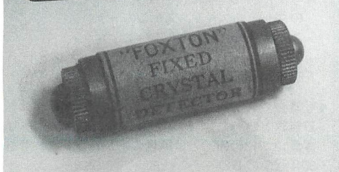
◀写真10 これぞ本物の鉱石検波器“FOXTON”。これもソケットを使用します。中身は黄鉄鉱の塊に針が点接触していて、これがダイオードのマークの起源。
