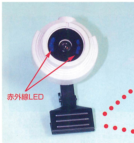
▲CCDビデオカメラは赤外線領域も感度が十分ある。レンズ脇の赤外線LEDの照射で数m先まで明るく照らし出す。また、音声収録用マイクも搭載している。
