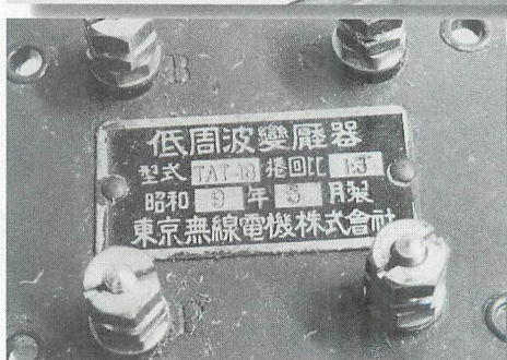
▲写真15、16 写真14のレシーバーを鳴らすためのマッキングトランスがこのトランス。 この漢字読めますか？ “ていしゅうはへんあつき”です。ナント！ 昭和9年5月製の1：3低周波トランスです。
