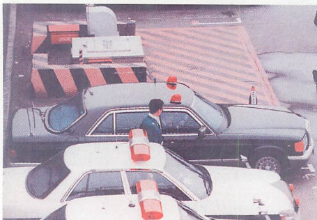
▲警護車両の中で唯一、反転灯を装備せず代わりに赤灯を2個載せている。アンテナはルーフサイドに2本とトランクリッドとトランクに3本ものアンテナを装備。
