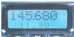
▲電圧表示中。モバイル運用ではバッテリーチェックに利用できる。
