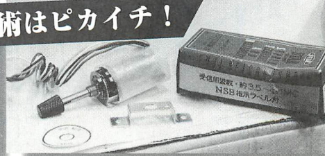
▼写真22、23 これもNSBチューナーですが、写真39のものは外付用なのに対し、これは組み込み用のものです。取付後は9.5~10MHzが聞こえます。ちなみにこのスターというメーカーは、ハム用のSR500やSR700などの素晴らしい受信機をリリースしていたのですが、20年位前に八重洲無線に吸収されてしまいました（コイルメーカーとしては大変優秀で、個人的にはトリオや松下のコイルよりも好きでした）。このスターの技術によって八重洲の銘機と呼ばれるFT-101（スラグチューンと呼ばれる同調機構）が生まれました。
