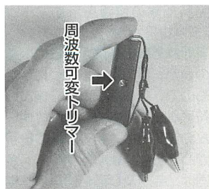
▲FM放送帯で電波を出す電話盗聴器（周波数可変トリマーがあるのが特徴）。FM放送帯のタイプは電波型式がワイドFM（WFM）だ。
