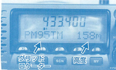
▲グリッドロケータを表示中。右の「158m」の数字は高度を示している。
