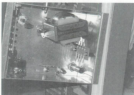
▲写真7 電解コンデンサの手前の小さなフィルムコンデンサがフロートングアース用のコンデンサ。これのおかげで感電しない！漏電ブレーカーも落ちない！
