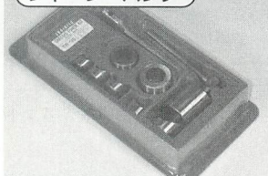
▲写真1 真空管工作の三種の神器ともいべき工具。真空管用ソケットを取り付ける丸穴を開けるもの。キレイに早く開けられる。
