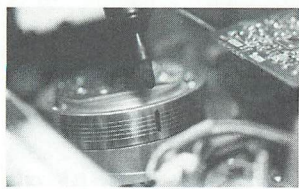
▲マジックインキでヘッドに汚れを付ける。
