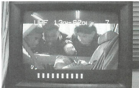
▲FTM-50からの電波を受信中。DVDソフトの場合、発色のよさや解像度などの品位の良さは十分伝わる。ただし、電波で送信する関係上、若干のノイズは入る。飛距離を延ばすには受信側のアンテナを工夫しよう。
