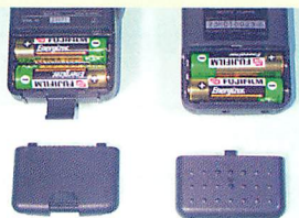
▲バッテリー収納部分のロック機構があるIC-R2に軍配。しかも気密度をあげるべくゴム製Oリングを採用している。AX400Bにはない。
