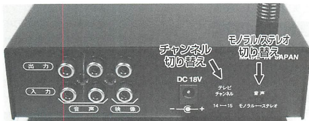
▲FTM-50裏面。映像ソースを入力すると、それを送信。チャンネルはUHF帯14/15チャンネル切り替え可能、音声もモノラル/ステレオ切り替え可能だ。
