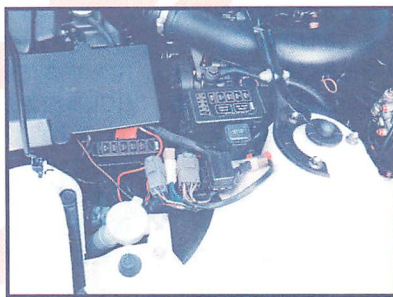
▲レーダー・散光灯・無線機などと、電装品が多いので、特別な電気配線が施されている。
