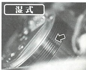
▲クリーニング液を使う湿式クリーニングテープでは、ある程度インクを落とすことができた。
