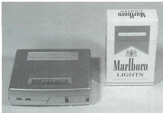
▲現状でカラーバーストコピーガードに対応する唯一の機種、プロスペックのVSP777V2（価格29,800円）。コンパクトで置き場所に困らない。
