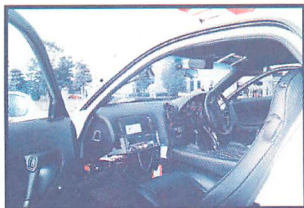
▲レーダー装備車なので、助手席にはレーダースピード取締装置が取り付けられている。
