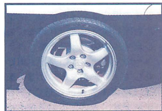
▲タイヤとホイールは、軽量225/50R16タイヤと8インチリムの超軽量16インチホイールの組み合わせ。ブレーキは、フロントに4ポットキャリパーを配した4輪ベンチレーテッドディスク+4センサー3チャンネルABSを装備。
