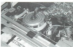
▲高速で回転するヘッドにクリーニングテープが接触し、汚れを落とす。
