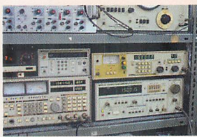
▲SGを2台用意。一台を希望受信波、もう一方を妨害波に見立てる。
