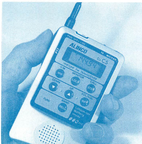
▲トーンエンコーダーやトーンスケール機能を利用すれば、クロスバンドレピーター機能を持つ無線機と組み合わせ、DJ-C5をワイヤレスマイク代わりに活用できる。
