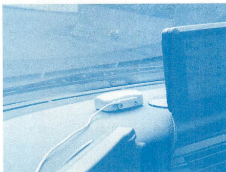
▲GPSレシーバーは高感度。ダッシュボード上に置いて衛星からの電波を受信できた。
