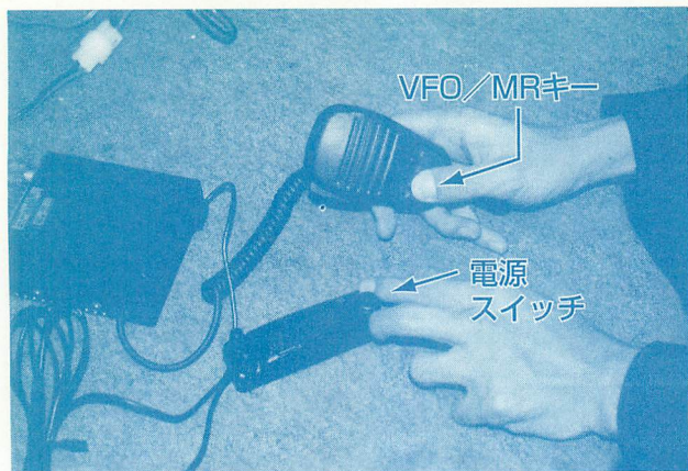
▲マイクの「VFO/MR」キーを押しながら電源オンで、メモリーオンリーモードになる。
