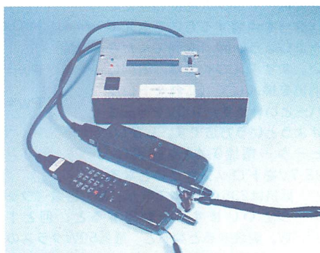
▲データコピーの時はクロス側にスイッチを変更し、それぞれのケーブルに携帯電話を接続し、暗証番号を入力すると、コピー開始!
