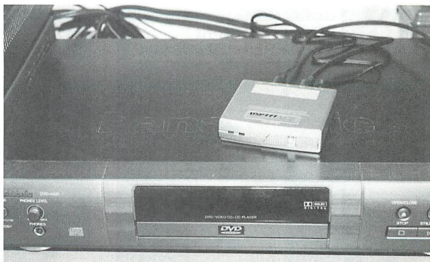
▲VSP777V2の接続は簡単。再生機器の映像出力と録画機器の入力端子の間に入れるだけ。
