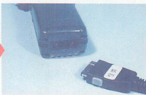
▲検索側のコネクタを携帯電話に接続。自動的に0000から検索・照合を開始。
