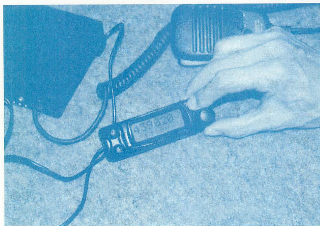
▲メモリーオンリーモードにすると、メモリー周波数でしか表示しない。オンエアする周波数がほぼ決まっているなら、このモードにするのもいい。業務機のような感覚で使えるのが魅力では。
