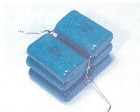
▲フィルムコンデンサを並列接続して所要の容量を得る。
