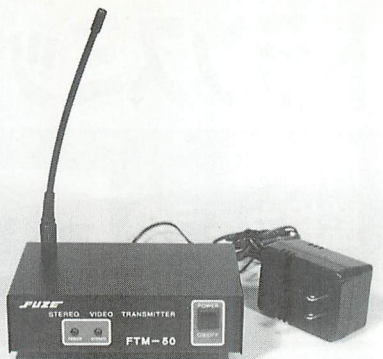
▲スクープブランドで販売しているビデオトランスミッターFTM-50。入力された映像を電波(UHF帯)で飛ばす。
