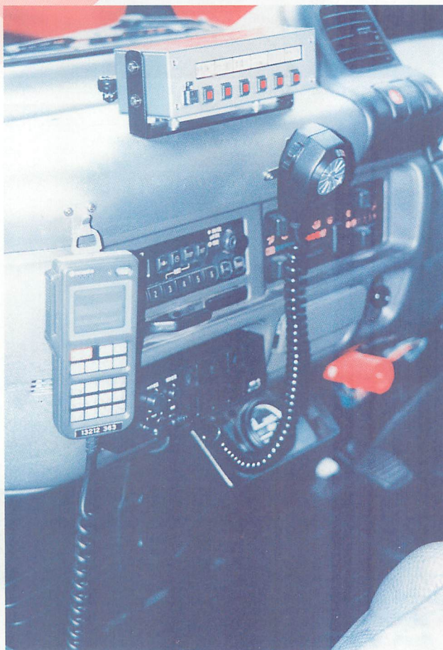
▲6連スイッチボックス(上)と埋め込みの電子サイレンアンプ。
