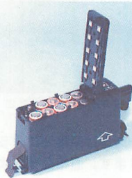
▲ポータブル運用の際には電池パックを使用。単3ニッカド電池を使用する。1.5Vマンガン電池やアルカリ電池を使用するときは必ずダミー電池を1本入れる。
