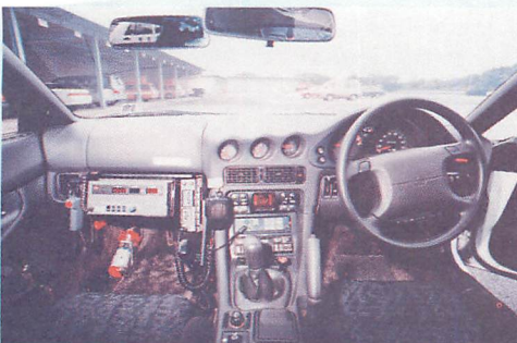
▲助手席に、レーダー装置と警察無線機が取り付けられているので、足元はかなり窮屈。サイレンアンプはバトライト製。
