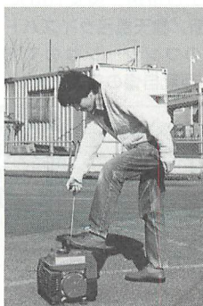
▲燃料とオイルの比率を正確に計算して給油を行う。
