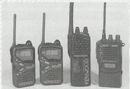
▲422MHzFMの電波を用いる特定小電力トランシーバー。近距離連絡用無線だ。
