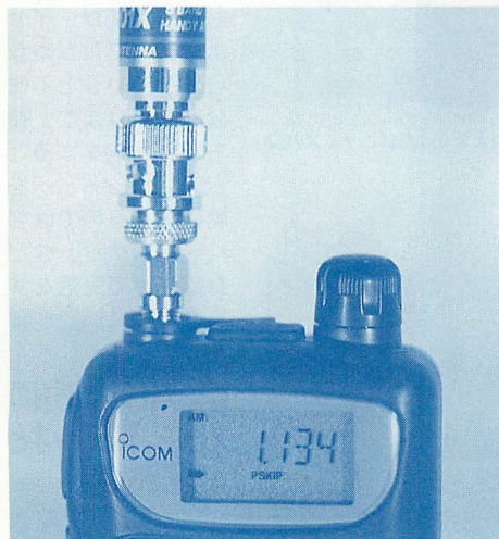
▲レシーバーはアンテナの選択が重要！ 市販の広帯域アンテナでは中波帯が受信できない場合が多い。
