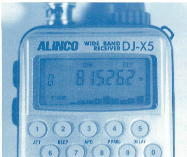
▲DJ-X5の優れた機能の一つ、9チャンネルスコープ機能。この機能を使うことで、受信している周波数以外にも、どこで電波が出ているのかが、耳ではなく目で知ることができる。
