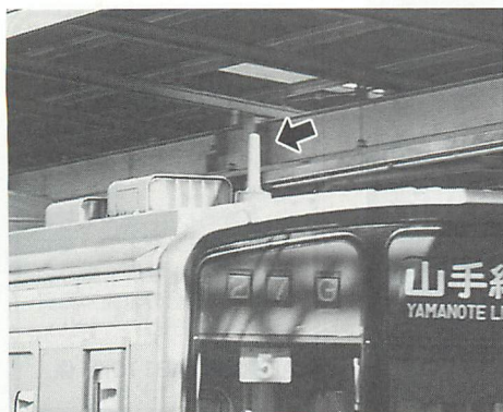
▲首都圏の列車無線に導入されているAタイプは、複信方式で、同時通話が可能。見分けかたは、運転席の上に付いているアンテナの形状が、Bタイプと比べると細いのが特徴。
