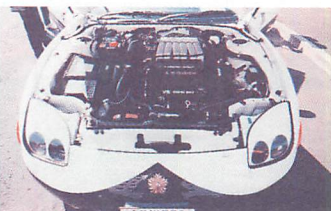
▲V6、3.0iDOHCツインターボ、ツインインタークーラーエンジンは、最高出力280馬力、最大トルク43.5kg/mの性能を持つ国産エンジン最高クラスのスペックを誇る。
