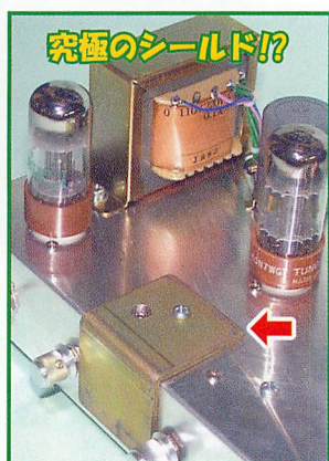
▲電源ハムを避けるため、シールド板を取り付けた。電源トランスとシールド板の位置関係の様子。磁束方向の考察とテストの結果、この位置に収まった (詳しくは本編参照)。
