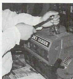
▲エンジンが「カブリ」気味だったので、プラグを外して調整・清掃を行う。
