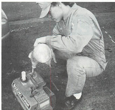
▲燃料とオイルの比率を正確に計算して給油を行う。
