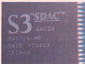
▲オンボードビデオには、S3社製のチップが搭載。スペック的には少々ツライかもしれない...
