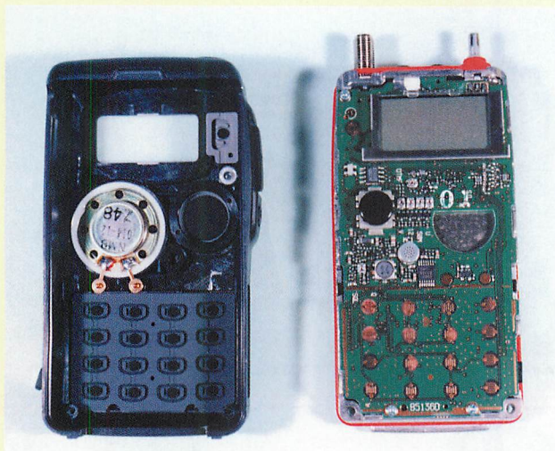
▲IC-T81の内部。ジャンパー線やケーブルがまったくないのは見事としかいいようがない。スピーカーはスプリング式の接点で基板と接する構造。操作性の悪さとは対照的に設計には思慮深さを感じられる。
