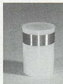
▲図にあるように90~97回密に巻く。10ターンのタップ出しを忘れずに!
