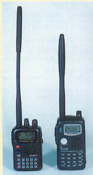
▲ヤエスの50/144/430MHz機、VX-5(左)とアイコムの50/144/430/1200MHz機、IC-T81(右)。どちらもローディングコイル入りの長いホイップアンテナが特徴。
