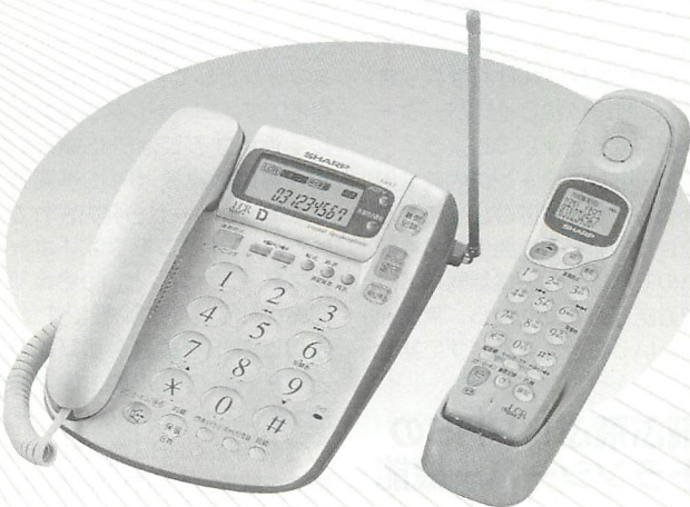
▲コードレスフォンは380MHzFM、出力10mWの立派な無線システムだ。
