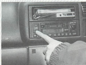
▲カーラジオの周波数を調整して、一番感度のよい周波数に設定。
