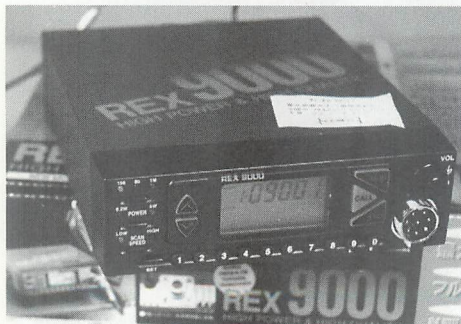
▲モービルタイプのパーソナル無線機、REX9000。操作や設定はハンディタイプのREX90と共通しているが、異なる部分もある。キーの数が多くて一見使いにくそうだが、実はキーが多いゆえに設定は簡単な。
