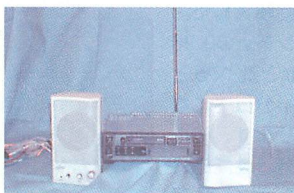
▲電源、スピーカー、アンテナを接続して完成!見た目はあまり良くないが、コンパクトにまとめることができる。
