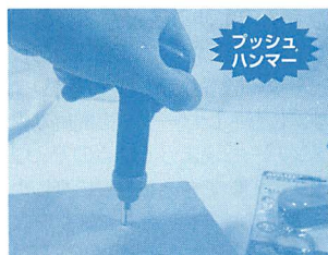
▲プッシュハンマー (950円)。先端透明パイプに釘を入れ、押し込むだけ。片手でも簡単に扱えるのがうれしい。
