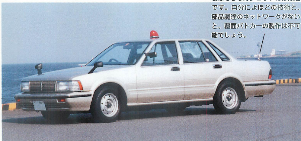
▲3ℓ用の大型バンパーに交換し、ドアモールを外した。3ℓのセドリックでドアモールが付いていないのは覆面パトカーだけ！
