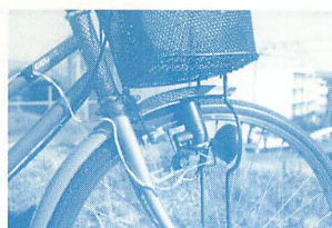
▲発電機への配線（車体側にはみのむしクリップで挟む）
