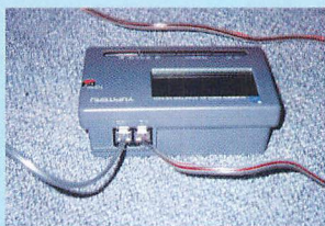
▲電話回線コードを『YE-ND1』の“回線”口につなぎ、電話機に差し込んだモジュラーコードを“電話機”口に接続。
