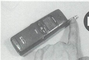
▲リーベックス製「クリスタルキャッチ」。800MHz、1.5GHzに対応。ボタンを押すと…。
