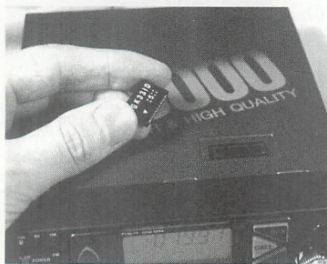
▲REX9000では、ROMの差し込み口が上面パネルにある。ここにデータを書き込んだROMを挿入する。くれぐれも新品の生ROMを差し込まないこと。送信できない上、再び抜くことができなくなるので注意！
