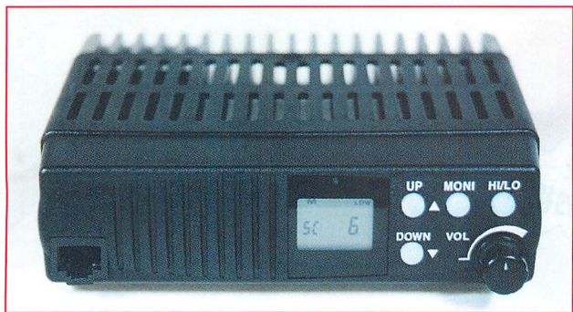
▲正面パネル。スイッチの数は少なくシンプル。周波数をメモリーして使うタイプなのでダイヤルもない。業務用ベースの無線機と思われる（メモリー周波数は最大100ch）。
