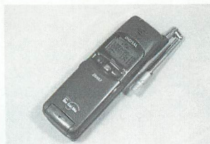
▲光るアンテナも数多くある。これは折り曲げることで邪魔にならないようになっているタイプ。
