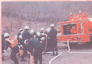
▲水のう給水装置で10t水槽車から補給。
