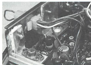
▲RFパワーアンプ部の様子。リアパネルに熱結合されている。
