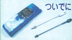
▲付属のアンテナを光るアンテナに変更した。ボディに合わせて光色は青。
