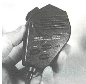
▲マイクにはリセットキー（REX9000では『END』キー）とアップダウンキーが付いている。初期設定さえ済ませれば、主な操作はマイクで十分。また、マイクにはスピーカーが内蔵されている。
