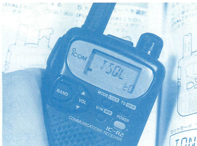
▲ムムム…セットモードにトーンスケルチ設定メニューを発見。IC-R2は受信機なのにトーンスケルチ受信ができるのだ。
