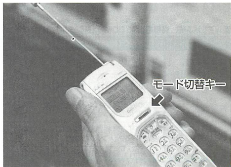
▲ドッチーモの要である携帯電話とPHSの切替が簡単に操作できるよう、目立つ位置に大きくモード切替キーがある。
