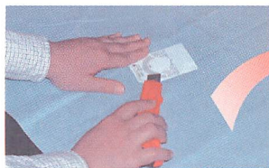
▲カードの裏をカッターで削るとプリント基板を見ることができる。
