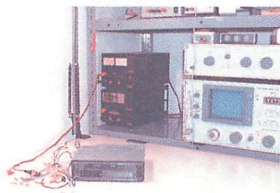
▲配線ミスがないか電源を接続して最終チェック。
