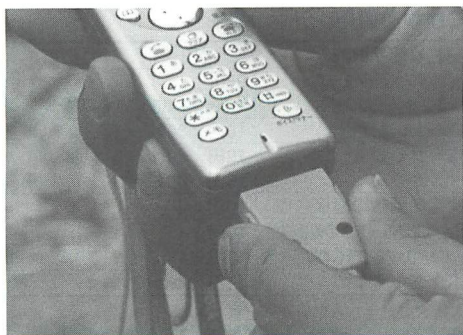
▲ポケットボードなどの情報機器と携帯電話は背面のコネクターを利用して接続する。
