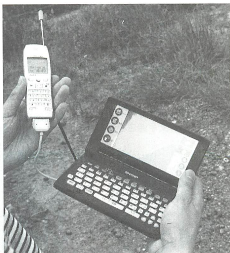
▲シャープの「コミュニケーションパル」はEメールだけでなく、インターネットを見ることも可能。背面のコネクターの形状が一致すれば携帯電話を選ばず接続できる。筆者はツーカーセルラー東京の携帯電話で活用している。
