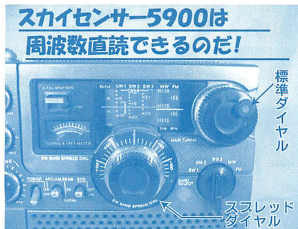
▲スカイセンサー5900の画期的なところは短波帯の周波数が読めるところだ! 標準ダイヤルとクリスタルマーカスイッチで校正し、10kHz単位を目盛りのあるスプレッドダイヤルで微調整する。
