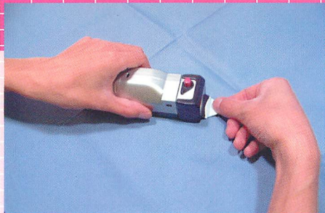
▲フィルムを引き出すには方向と力加減が難しい。平面と水平に引くこと。
