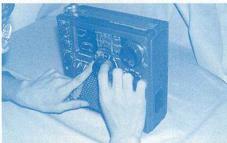
▲最後は周波数校正作業。スプレッドダイヤルを左側に回しきって、ダイヤル上の白い点と緑色の線を合わせる。JJYを受信して調整の正しいことを確認したら作業完了!
