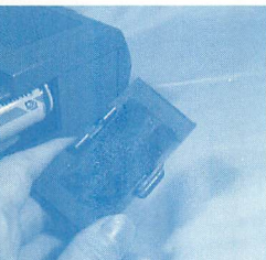
▲電池ケースのフタの裏側にはスポンジが付いているが、劣化し、さらにノリでべたべた。これらもうにかしたい。
