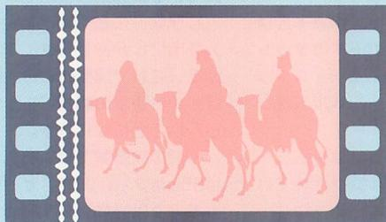
この部分がサウンドトラック。映画の音声光学式に記録されている。音声の強弱が、幅が広くなったり狭くなったりする帯として記録されている。この部分にランプを当て、フィルムの反対側に受光器(cds)を用意する。すると、サウンドトラックの幅の変化が電気信号に変換される。35mmフィルムでは2トラック設けられている(作品によって1トラックの場合もある)。
