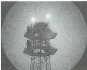
▲スターライトスコープを使用した映像。わずかな光源を科学的に増幅させて明るさを増していく方式だ。
