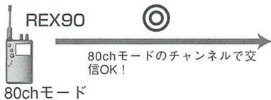
158chモードで待ち受け中のREX90を80chモードのREX90で呼ぶと80chモードの通話チャンネルで交信となる。
