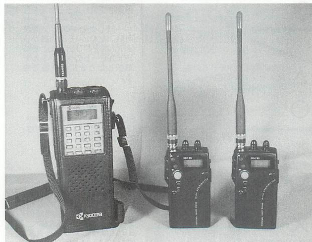
▲マルハマのREX90からREX90を呼び出した場合のモードと周波数の関係を実験。一般80ch機との互換性も合わせてチェックした。REX90同士では、待機側が80chモードでも呼び出し側が158chモードなら、待機側も対応して158chモードに切り替わった。
