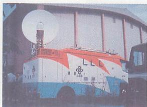
▲島根県が導入した衛星中継車。スーパーバードBを介して県庁内の防災センターと結ぶ。ちなみにこの中継車だけで2億円もする。
