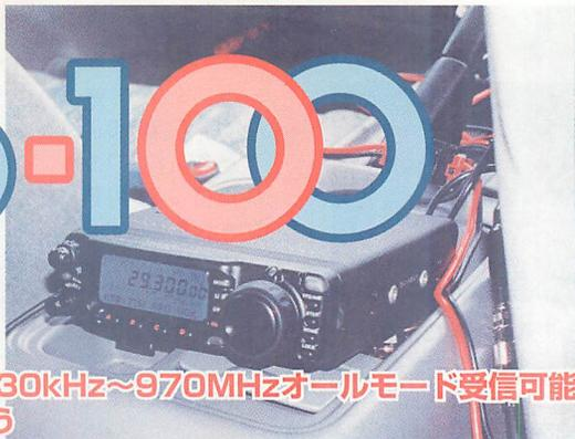
**HF~430MHzオールモード機+30kHz~970MHzオールモード受信可能！
