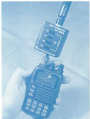
▲必要最小限度のキー、独立した音量・スケルチつまみなど、スタンダードらしい扱いのVR-500。表示部が大きいのも感じがいい。アンテナ端子はBNCなので市販のアッテネーターをじゃかに付けられるのもうれしい。
