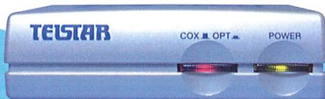
▲TR-46Dを正面から見た様子。向かって右に見えるのが電源スイッチ。「入」の状態だと写真のように緑色に点灯する。左側は同軸入力/光入力切り換えスイッチ。スイッチが押されている状態だと光入力となり、赤く点灯する。
