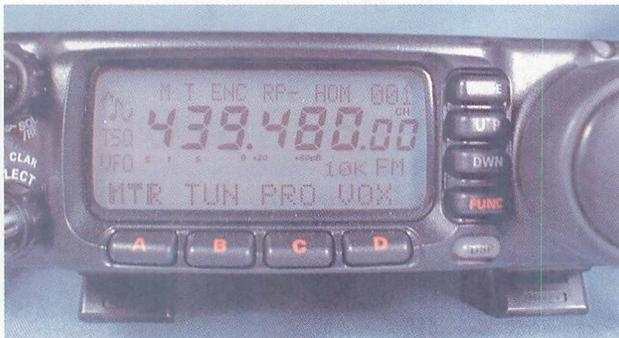
▲439MHz合では自動的にレベーター設定。これは当たり前だが、FT-100ではトランスケルチもDCSも搭載されている。V/UHF帯FMモードの機能も充実しているのだ。
