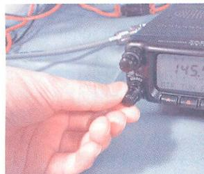
▲FM帯で、例えば20kHzステップの周波数変更をするときは、左下にあるSELECTツマミを利用する。これを使うとカチカチと設定ステップ単位で周波数が動く。
