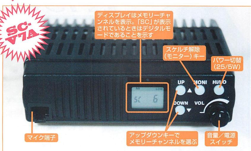
▲SC-V7Aはいたってシンプル。アップダウンキーでプリセットしたメモリーチャンネルを選ぶだけ。メモリーチャンネルには送/受信周波数、デジタル/アナログモードを書き込める。100チャンネルまでメモリー可能。
