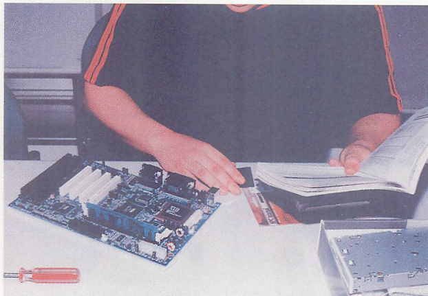
▲マシンを組み立てる前に、説明書を読んでマザーボードのショートピンを設定しよう。
