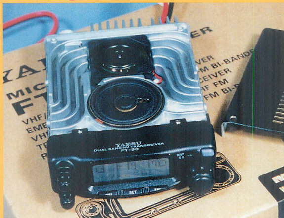
▲FT-90Hのサイズは、FT-90と同様。フタを開けてみると、ダイキャストフレームの形状の変更など改良点が見える。
