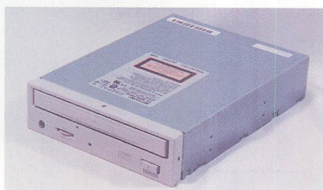
▲CD-ROMドライブ。40PのIDEで、IDE0>HDD>CD-ROMの順番でつける。ショートピンをSLもしくはスレーブと書かれている方にMAもしくはマスターと記述されている所から移そう。
