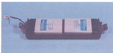
▲バッテリーケースは充電式から乾電池式改造することが可能。
