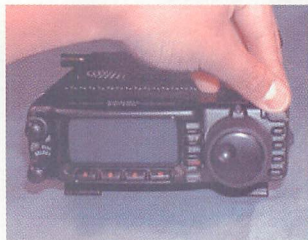
▲ パワーキーを押して、「UP」「DOWN」キーでバンドを選択する。後はダイヤルで周波数を決定する。簡単に送信することができる。
