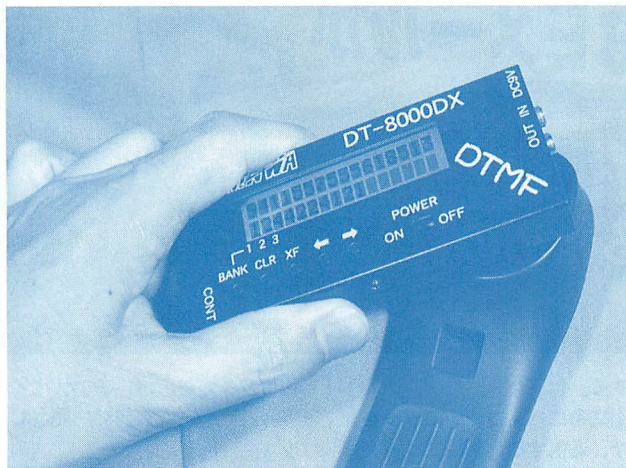
▲コンパクトサイズの多機能DTMF解読器DT-8000DX。マイクを備えるので、スピーカーや受話器に近づけるだけでDTMF信号を解読する。
