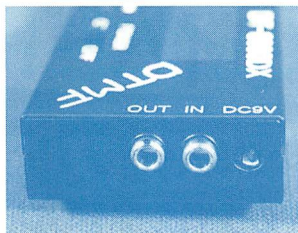
▲受信機や録音テープからの再生音はライン入力端子を利用してダイレクトに入力することもできる。
