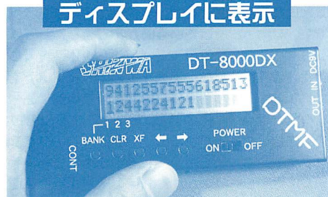
▲入力されたDTMF信号はディスプレイに次々に表示される。最大96文字をメモリーできる。
