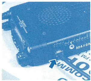
▲マイクコネクターが右側面にしかないのが気になる。セッティングの制限になることも考えられる。
