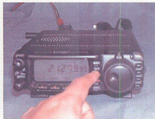
▲ パワーキーを押して、「UP」「DOWN」キーでバンドを選択する。後はダイヤルで周波数を決定する。簡単に送信することができる。
