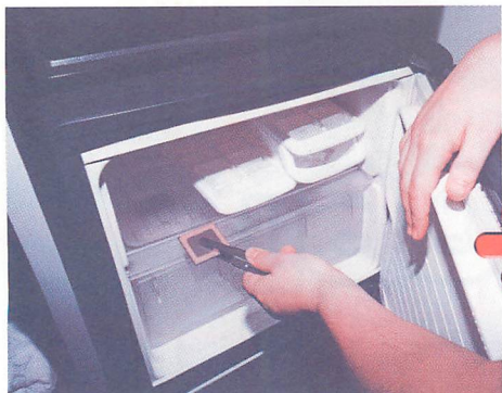
▲熱で動かなくなったCPUを冷凍庫で冷やす。結露が怖いですが簡単にCPUは壊れないので気にしやいけない。
