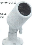
CW-BC200RW (レンズ・取付金具付) 防滴型・屋外設置可能 価格¥38,800 1/3インチCCDインターライン方式 25万画素、380 TV Lines、0.1Lux (F2.0) 電源 / 12V DC、100mA サイズ / φ23×49mm
