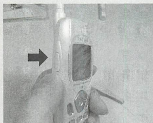
▲PHS-J80側面にある「PS」キー。通話品質が悪くなったら押してやる。より近くに基地局があれば、そちらに切り替わり明瞭な通話ができるようになる。
