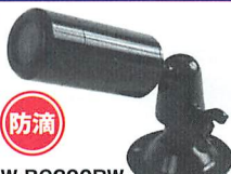
CW-BC200RW (レンズ・取付金具付) 防滴型・屋外設置可能 価格¥38,800 1/3インチCCDインターライン方式 25万画素、380 TV Lines、0.1Lux (F2.0) 電源 / 12V DC、100mA サイズ / φ23×49mm
