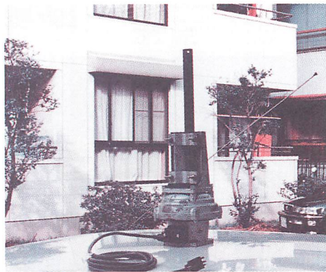
▲AV & 無線車製作のために用意したローテーター。12V用のもので、車載で使われていた業務用らしい。放送中継車用かもしれない。
