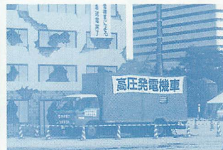
▲高圧発電機車 緊急性の高い施設には高圧発電機車自ら現場に赴き、送電の復旧を待つ。
