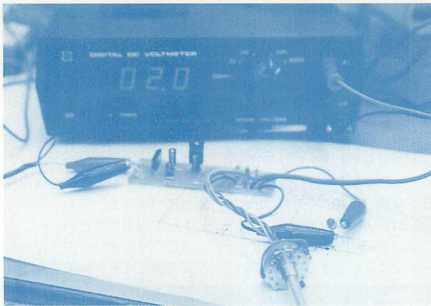
▲2V用赤色発光ダイオードも何mAでどのくらいの明るさか簡単にテストできて便利。
