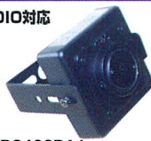
CK-BC400PA1 (レンズ・取付金具付) 超小型ピンホールカメラ 価格¥24,000 1/3インチCCDインターライン方式 25万画素、420 TV Lines、0.05Lux (F2.0) 電源 / 12V DC、100mA サイズ / W30×H30×D28.5mm
