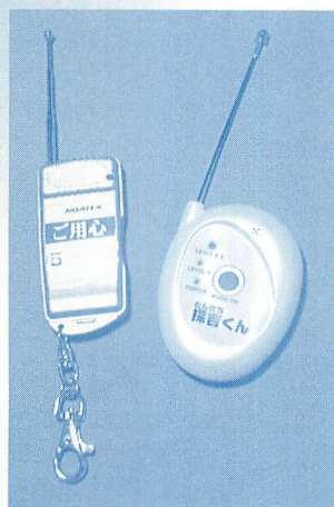
「ご用心」(写真左) 探知距離5m 探知周波数3〜3000MHz アンテナ93mm 「探吉くん」(写真右) 探知距離およそ10m 探知周波数76〜770MHz アンテナ155mm
