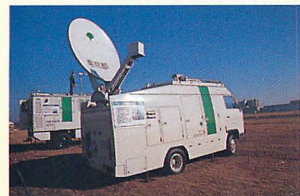
▲東京都保有の衛星通信車。災害発生時に現場へ出動し、衛星を経由して映像を対策本部へ送信します。
