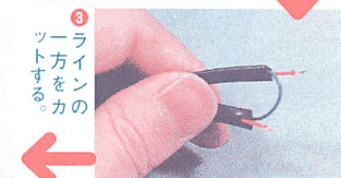
③ ツーラインをカットする。 ④ ラインを切った部分にクリップで電話盗聴器を挟み込む。これでセット完了。電話線を電話機とモジュラージャックの間にいれると盗聴器がスタンバイ。電話で通話すると盗聴器が動作する（盗聴器は非認定品なので、セットすると違法行為になるので注意）。
