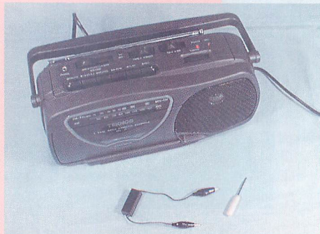
▲ミサキコーポレーションの電話盗聴セット。電話盗聴器と専用の自動録音式ラジオカセットからなる。
