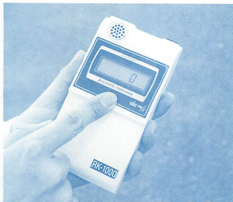
▲センサー部に息を吹きかけると、アルコール濃度に応じた数値が表示される。
