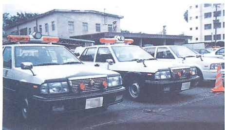
▲2台のレーダーパトカー。レーダーは、トランペット型（松下製）を使用しています。
