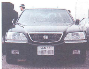
▶正面。このタイプは幹部公用車として使用されていたので、助手席ナビミラーが付けられていない。グリルの中には、前面警光灯が入っているが、グリルの隙間が大きいせいもあってか、とても目立っている。
