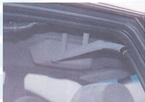
▲反転灯のケース。室内と同じ色に統一されており、違和感が感じられない。水抜きホースもホンダ純正方式ではあるが、反転灯付の車両製作はホンダとしては初めてだと思われるので、それなりの苦労があったと推測される。
