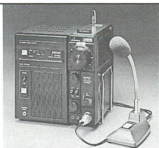
▲専用電源とスタンドマイクで固定運用にもベストフィットした。専用電源にはオプションのリニアアンプもセットできた。
