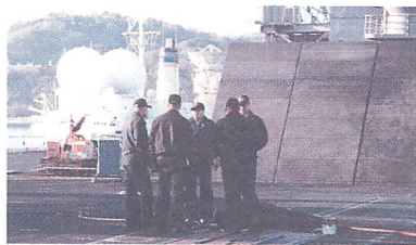
▲カタバルトの整備中なの、中を開いて色々作業をしていました。後方に斜めに色々しているのはJBD（ジェット・プラスト・ディフクター）と呼ばれ、発艦する艦載機から出る排気が、発艦を待つ後続機に影響しないようにするためのものです。普段は畳んでありますが、発艦機がカタバルトにセットされると起き上がります。
