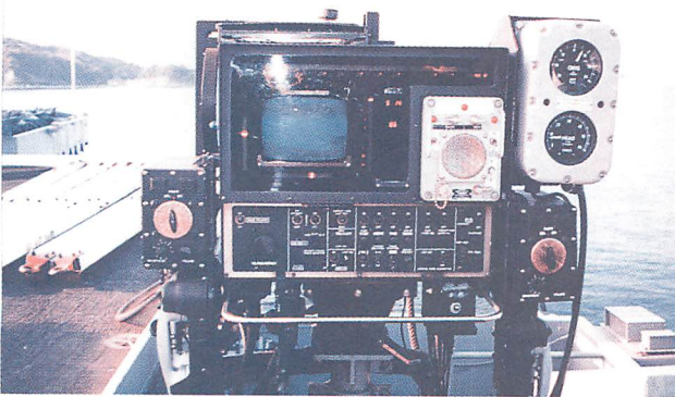
▲FLOLSの制御装置。左側画面で着艦する艦載機をモニターして誘導します。
