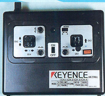
▲レボリ्यूターの送信機。27MHzのAMモードの電波でコントロールする。4ch制御の本格派のものだ。
