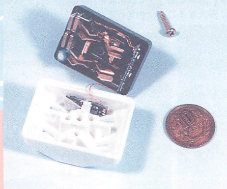
▲2又コンセントの内部に発振器が組み込まれた偽装タイプの盗聴器。もっともポピュラーな盗聴器だ。
