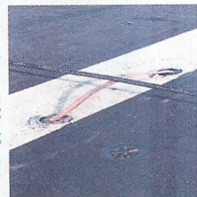
▲中央にあるバーは、艦載機が着艦しやすいように、アレステイング・ワイヤーを甲板から浮かせる役目をする。
