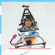
▲無線仕様で飛ばす場合は、レボリ्यूター本体底部にバッテリーを取り付ける。
