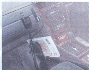
▲警護車としての性質もあつたか、なかなか車内を見ることができないのでこの写真は貴重だ。サイレンアンブは警護車・警衛車専用のパトライト社製SAP-500BPを使用しているが、この車両にはマイクが付けられていない。無線機は助手席足元に置かれており、室内の色に合わせた特別ケース内に入っている。写真では見えないが、警護時には複数の無線機を使用するため、コンソールBOXにも無線機が入るようになっている。
