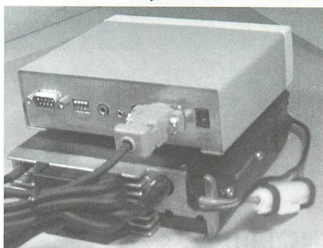
▲TNC-55のRADIO端子とFT-8100のDATA端子の接続。
