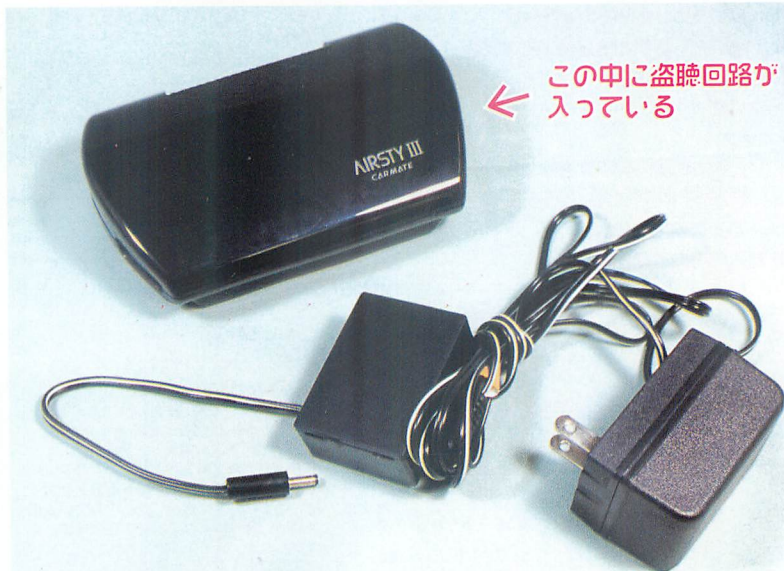
▲シンワムセンの最新型デジタル盗聴器。外見はカー用芳香剤だ。充電式になっている。
