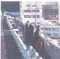
▲カタバルトの整備中なの、中を開いて色々作業をしていました。後方に斜めに色々しているのはJBD（ジェット・プラスト・ディフクター）と呼ばれ、発艦する艦載機から出る排気が、発艦を待つ後続機に影響しないようにするためのものです。普段は畳んでありますが、発艦機がカタバルトにセットされると起き上がります。
