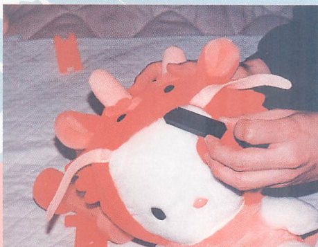
▲代表的な盗聴方法が集音タイプの無線式盗聴器を利用するもの。マイクで室内の音を拾い、電波で音声を送信する。盗聴器は小型なのでどこにでも仕込むことができる。プレゼントでもらったぬいぐるみに盗聴器が入っているかも…。
