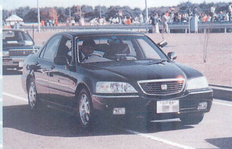
▲警護活動中のレジェンド。TLアンテナ2本に、助手席ナビミラーがついており、警護車としての標準装備をしている。
