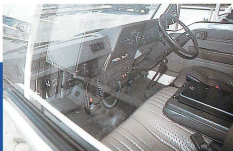
▲移動オービスの車内。無線機とサイレンアンプが装備されています。
