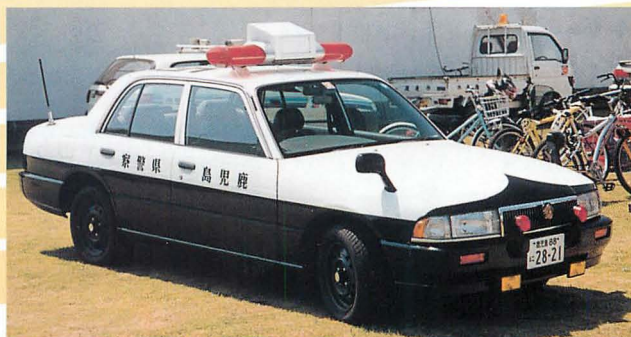
▲前後から測定できる最新レーダー(NEC製)を搭載するクルーのパトカー。アンテナはTL型を使用。
