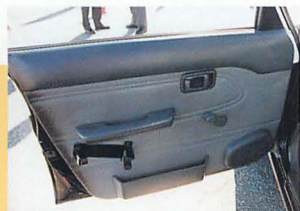
▲助手席ドアには、警棒格納装置が設置されています。
