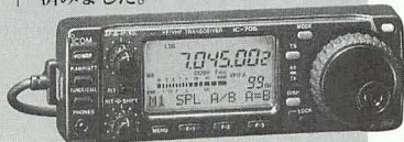
▲アイコムのHF+144MHzトランシーバー、IC-706。その後バージョンアップを重ね、現行機種IC-706mk II Gでは430MHzまで搭載している。長年使っている筆者のIC-706はFM帯で送信しなくなっていました。しかし、簡単なメンテナンスで復活。同様の症状が出ている人がいたら試して欲しい。
