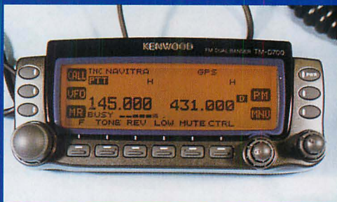
▲TM-D700のディスプレイ。2バンド同時受信可能だ。運用中の周波数表示が大きく表示される。
