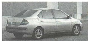
▲電車と同じ回生ブレーキを採用することによって、余った電気を自己のエネルギーに変換し、ハイブリッド化を実現したトヨタプリウス。
