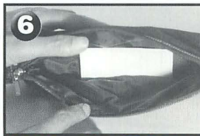
▲映像チェックをして問題がなければ、マジックテープを使ってカメラを固定します。
