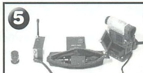
▲実際にカメラをペンケースにセットして、映像がきちんと映るか、チェックします。ここで糸くずなどが映り込むようでしたら、穴の直しをします。
