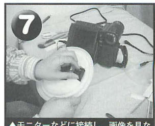
▲モニターなどに接続し、画像を見ながら、レンズにケラレがないかを確認しながら正確な位置に固定します。
