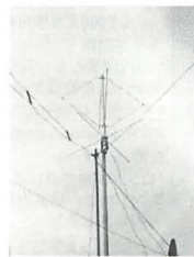
写真1・筆者の使っているDXONE PRO。隣りに建っている逆しやスロープ・アンテナと比較すると、中波以下では抜群だが、短波では同程度だった。
