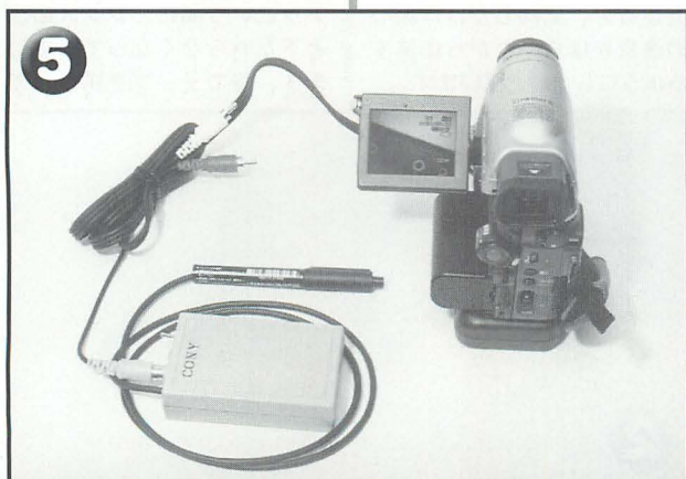
▲キャップにカメラを固定するときには、映像をチェックできるようにモニターに接続しておき、画像が真直ぐになるように調整もします。キャップのフックを目印にし、カバンの口に差し込んだときの状態に合わせ、位置を決めます。
