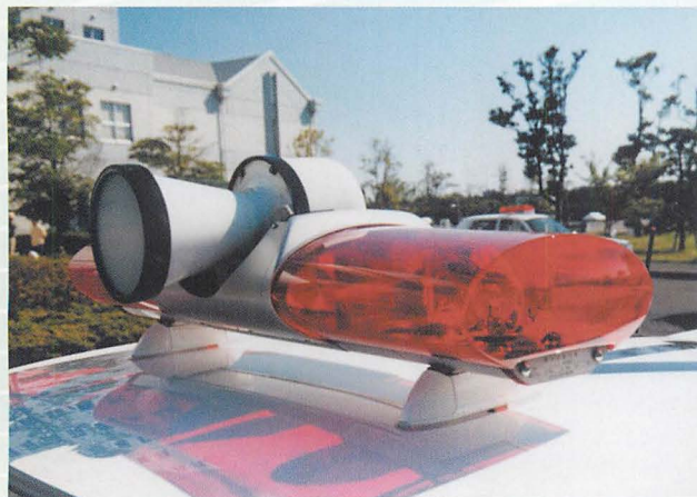
▲GTOから移植されたレーダーユニット（松下製）
