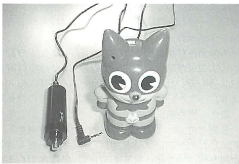
▲これが完成したハンズフリーホン。外部ノイズの影響を防止するには、金属ケースに入れるべきだが、オリジナルティ重視なのでプラスチックのキャラクターに組み込んだ。エコーもあり、多少携帯電話の電波ノイズに影響されるが、ハンズフリーホンとして十分利用可能（キャラクターはニャンダーかめん）。
