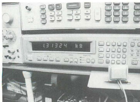
▲磁気シールド型オーディオチョークの直流抵抗を測定。約1.3KΩで、タムラの2KΩよりGood!
