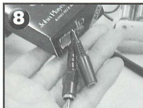
▲箱の下に穴を開けてケーブルを出す。
