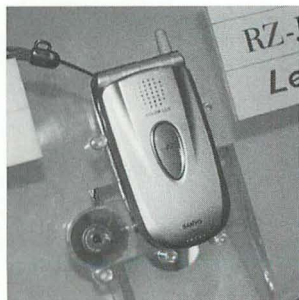
▲J90を閉じた状態。本体上部にワイドレンジスピーカー。中央のH™マークが7色に光る「イルミネーションエッジ」。
