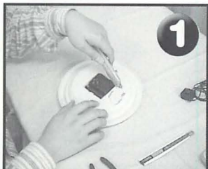
▲プラスチック製ですので、カッターで裏ブタを切り取ります。
