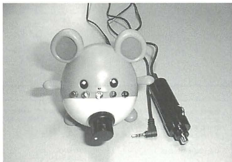
▲ポケモンキャラクターのマリルに組み込んで完成のハンズフリーホン。丸いキャラクターなので、LEDやボリュームの穴の加工が難しい。いかに小さく作り、そして上手くキャラクターに組み込むかがポイント。
