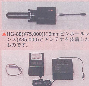
▲バッテリーパックBP-1300はACアダプターで充電しておきます。
