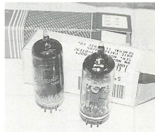
▲左は6GM6、右は真空管1本でスピーカーが鳴るレフレックス用Higm管6EW6。
