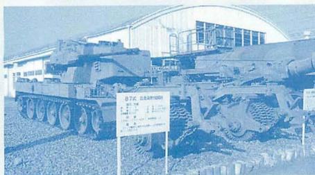
試作車の前には何故か92式地雷原処理ローラーが装備されている。
