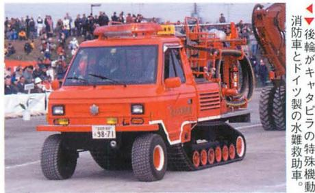
▶後輪がキャタピラの特種機動消防車とドイツ製の水難救助車。
