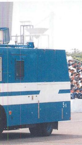
▲新塗装のタイプ。後輪上部が水タンクとなっている。上のカバー内には給水用ホースが入っている。
