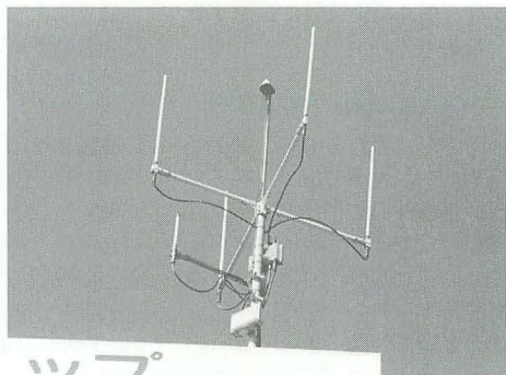
▲写真2 アンテナ中央頂部にあるのがGPS受信用と思われる傘型アンテナ。下部は周辺の基地局と同期情報をやりとりする為の専用アンテナと思われる。DDIポケットの通話品質が高度に維持されているのはこのアンテナの存在によるところが大きい。
