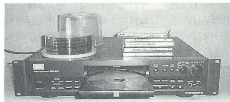
▲CDR-850 (¥159,800)。業務用機なので、SCMCフリーでコピーは何度でも可能。また音楽専用のCD-Rを使わずに書き込みが可能なので、メディアも安上がり。強力なレーザー光で書き込むので、データの安定はピカイチ。それゆえにCDのマスター作りにも使われている。
