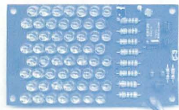
▲大光量が必要無い場合は、赤外線LEDを使うと良い。赤外線タイプなのでフィルターが要らない。
