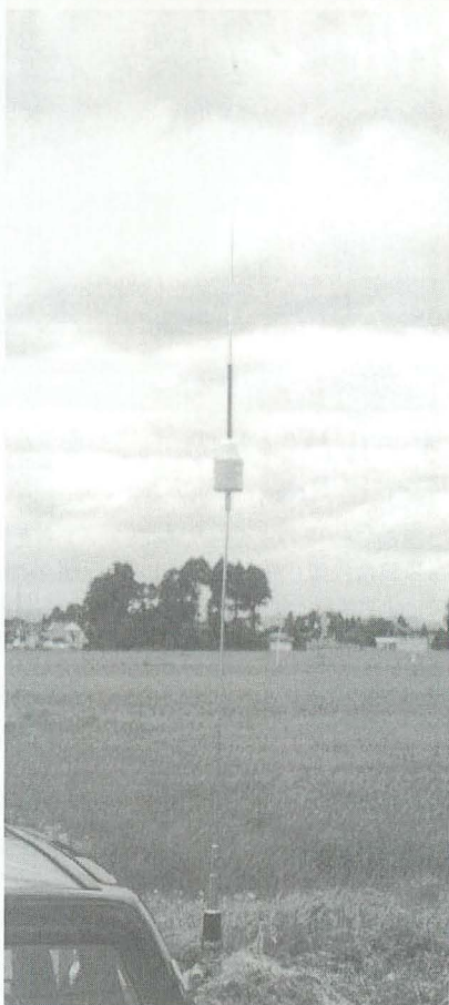
▲10MHz用コイル。エレメントはロッドアンテナで長さが調整できる。
