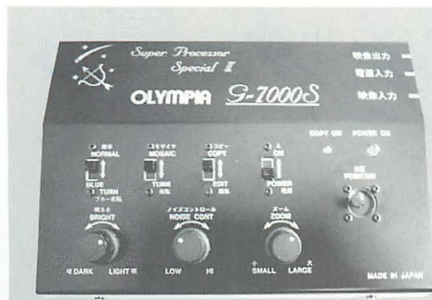
▲スーパープロセッサ-G-7000S (¥29,800)。モザイク除去機能も持つ編集機で、ビデオ端子だけでS端子はないが、検証ではVHSはもちろんDVにもダビングができた。
