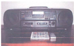
▲音楽を録音する時の使用例。オーディオケーブルを本機のLINE入力ジャックとラジカセの外部出力ジャックに接続し、後は録音ボタンを押すだけでだ。
