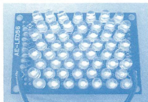
▲デジカメで撮ると、赤外線光はボワヘンとした紫調の色で写るので発光しているのが判る。
