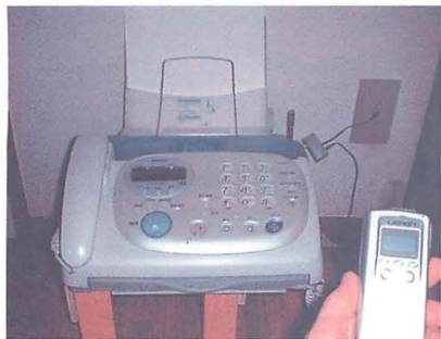
▲電話機から音を拾う時は、本機をこれぐらい離しておけば、ハウリングをしないで録音することができる。接続方法は、オーディオケーブルと本機をアダプターに繋ぎ、その後アダプターに電話機の本体と受話器を接続すれば完成! 簡単である。
