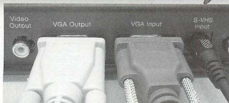
▲VGA端子を用いて、パソコンの本体とモニターの間に本機を設置した。テレビ（ビデオ）からの入力はS端子を使うことにした。
