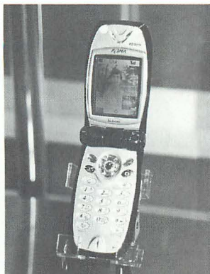
▲FOMAテレビ電話型端末「P2101V」。内部ソフトに不具合が発生した為、試験サービス導入が約1ヶ月遅れた日くつきの端末。写真ではわかりにくいが折りたたみ部分の右側に回転式カメラが装備されている。
