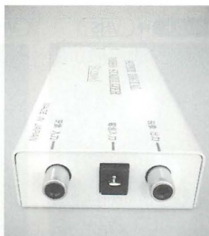
▲接続用端子はコンポジットビデオ端子が1系統のみで、S端子はない。写真中央にある端子は電源接続用で、付属の12V/ACアダプターを使う。
