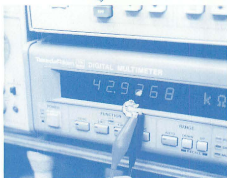
⑤ SW付ポリウムは？ なぜか43K \Omega （実測）でした。メーカー推奨値は30K \Omega ですが、20K \Omega ～50K \Omega で何でもOKです。
