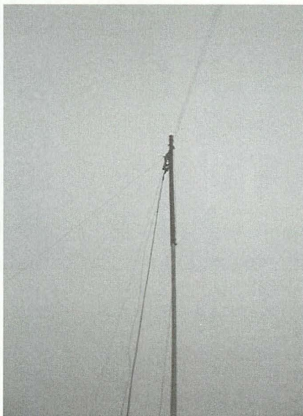
▲ローバンドのアンテナは波長が無いので、効率のよいアンテナとなるとかなり大型となる。畑などの広大な土地が無いとフルサイズのアンテナを建てることは困難だろう。
