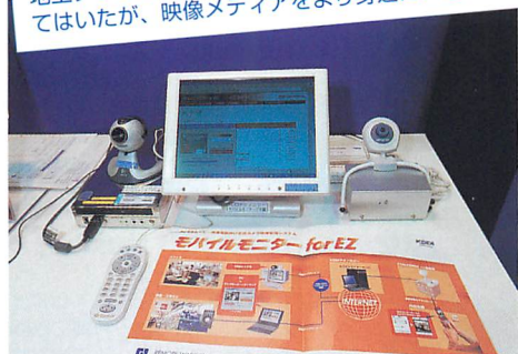
▲auの「モバイルモニター for EZ」。PCに接続したカメラ画像をEZムービーで見られる「定点カメラ映像配信システム」。撮影した画像を、PCがインターネット経由でKDDIのサーバーに送り、その画像をEZムービーでダウンロードするしくみになっている。カメラとソフトのセットで発売予定で、Windowsのみ対応とのこと。
