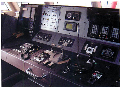
◀ 操舵室です。左からレーダー、水中ソナー、エンジンコントロールと舵輪、モニターと監視モニター2基などがレイアウトされています。
