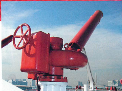
▲みやこどりは、この船で3代目です。この放水砲を含め、消防ポンプ車約25台分に相当する最大毎分51,000リットルの放水能力があります。
