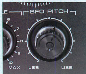
▲SSB受信時、正確な復調ができるようBFOピッチツマミが備えられている。こだわりが感じられる部分だ。
