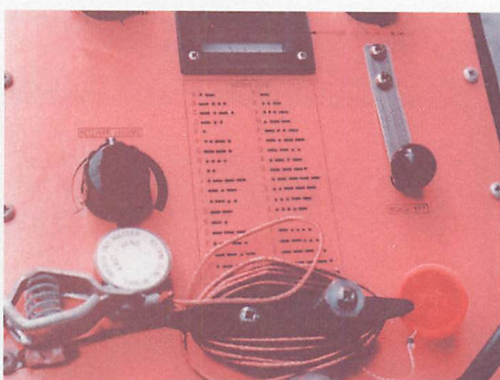
▲写真10：メインメーターの下には電鍵とモールス信号表、ボリュームなどがある。
