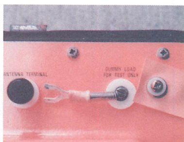
▲写真6：試験用のダミーロードまでついている。
