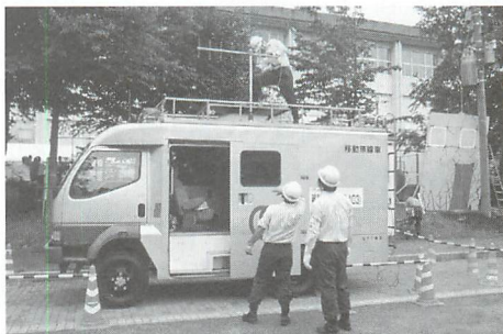
▲写真は防災訓練時のNTTの移動無線車。アンテナを立てていますが、災害応急復旧用無線か、災害用緊急多重無線での回線確保になるようです。この車両への連絡用にアナログ150MHzが使われます。
