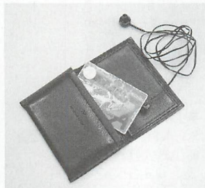
▲ラジオのお薦め「カードサイズラジオ」。定期入れや名刺入れに入れて、常に持ち歩ける。リチウム電池使用のAM専用なら、長時間使用可能だ。
