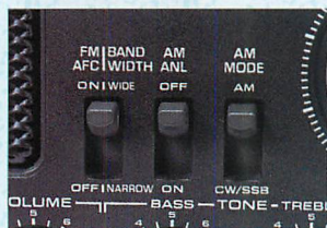
▲AM、CW/SSBを切り替える、モード切替キーに注目（一番右のキー）。単なるBFOスイッチとしていないところが通信型受信機らしい。
