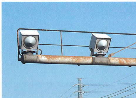
▲この取締機は円錐形のレーダーアンテナを装備。垂直偏波を放射している。他に平面アンテナもあり、その場合は水平偏波だ。円錐型は松下、水平型は三菱製とのウワサだ。
