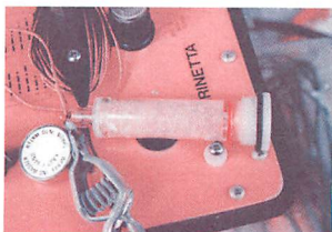
▲写真17：無線機内部を乾燥させるシリカゲル付き。
