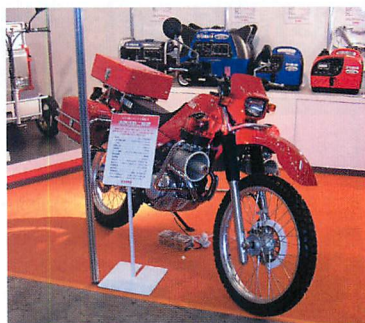
▼ニッキの屋外展示では、MistDragonという完全完結型消防バイクを展示していました。バイクにホースとタンクとポンプを搭載して、規模の小さい火災ならバイクだけで消火してしまうという、頼もしい消防バイクです。
