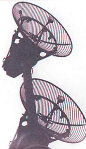
▶▶車両背後にある太い通信ケーブルと、風圧や重量の軽減のためメッシュ状になったパラボラアンテナ。
