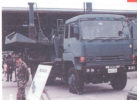
◀◀このパラボラアンテナの車両は、味方機に攻撃目標情報を伝送するための中継装置です。
