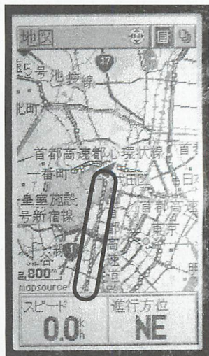
▲表示される液晶画面を見ると、地図と矢印で現在地と向きがわかり、目的地までの最短距離が直線の太い線で表示されています。
