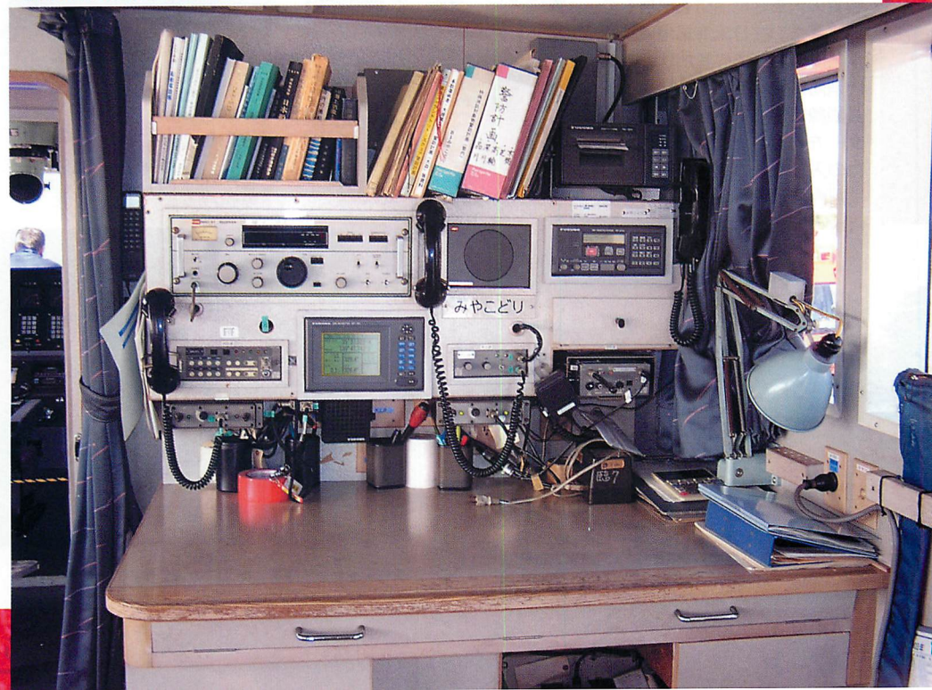
▼艦橋に設置されていた無線卓。船舶らしく、消防車とはちょっと違う無線機類がラックにきれいに収められ、本棚には船舶系の書籍が並んでいました。
