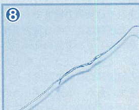
▲ループ部分を半田付けして電氣的に一本の輪になるようにします。
