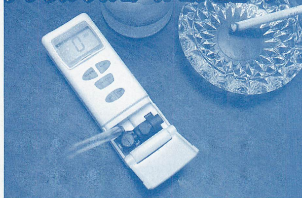
▲簡単にアルコール濃度が測定できる「デジタルアルコールコンピューター」。パネル下部のノズルに息を吹き込む。単4電池4本で稼働する。
