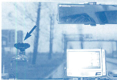
▲検証するレーダー探知機は、助手席のフロントガラスに設置。フル性能を発揮させるために、シガーライターからの電源供給を行った。
