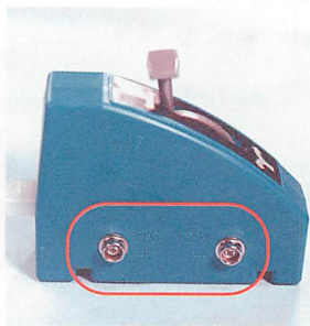
▲カトーの「ポイントスイッチ」のパワーパックとの接続は、“スナップ端子”を使用している。
