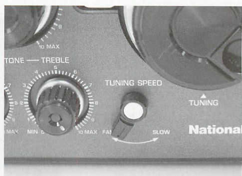
▲メインダイヤルの左下にはチューニングスピード切り替えスイッチがある。この切り替えでダイヤルのギア比が変わり回転スピードが可変する。SLOWにすると微妙なチューニングが可能だ。
