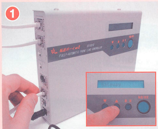
▲電話回線を2本、それぞれ転送ボーイMKⅡに接続し、設定を「GATEWAY」にします。
