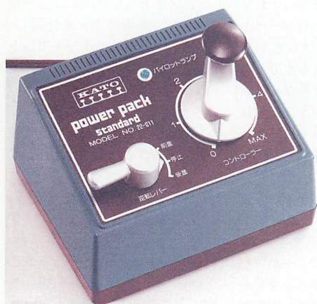
▲カトーのエントリーモデルパワーバック、品番22-011「パワーバック スタンダード」(5,500円)は、車両走行用に700mA、アクセサリ用側面端子には100mAの出力を持つ。
