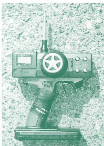
▲27MHz帯のAMプロボ（送信機）です。ハンドル式コントローラーで、車の操縦に適したプロボ、出力は500mW（0.5W）。
