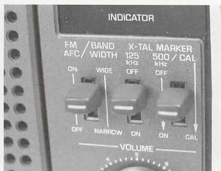
▲ダイヤル校正はマーカ信号を発生させて行う。3つのスイッチの中央が125kHz間隔のマーカ信号のスイッチ。右端のキーは500kHzのマーカスイッチ。右端のキーはスプレッドダイヤルのロックを兼ねる。
