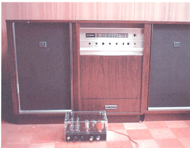
▲完成したアンプを元の本体と比べると…。保護カバーを含めたサイズはW250×H140×D170mmと、とても小さくなり、置き場にも困らない。
