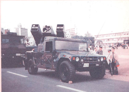
▲93式近距離地对空誘導弾車両、近SAMです。車両前方のアンテナが独特です。車両の発射台は高速で回転して、ヘリコプターなどのすばやい動きにも対応して迎撃できます。
