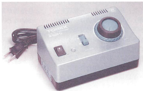
▲トミックスの上位モデル、品番5502「TCSパワーユニットN-1000CL」(9,800円)。出力は車両走行用・アクセサリ用で1,200mAの余裕の高出力。さらに、信号機や踏み切り用のTCS端子に、ヘッドライト・テールライト、室内灯を常時点灯させるCLシステムが内蔵されている。
