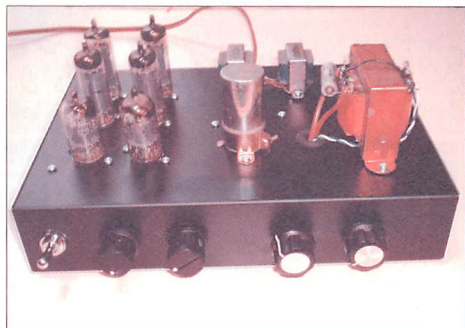
▲取り付け完了！ このままでも使用可能だが、真空管保護などのために、これからアクリル板上部を覆う。
