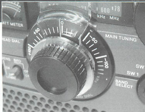
▲10kHz単位を目盛りが付けられたスプレッドダイヤル。手探りから周波数直読へと、受信方法そのものを変えたのだ。
