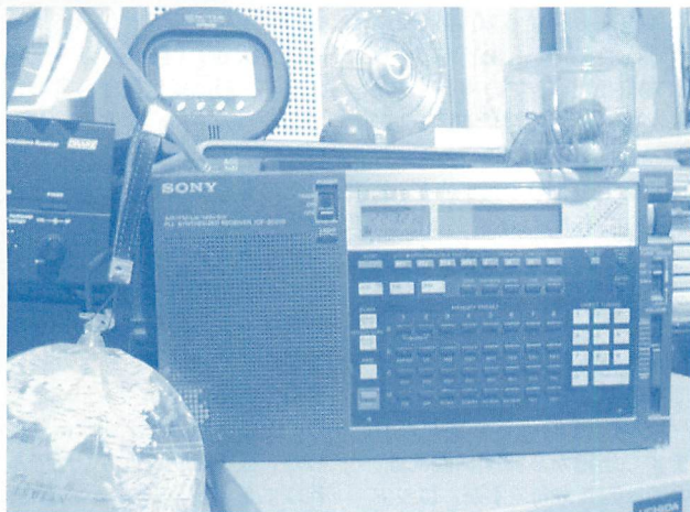
▲写真3：私のシャックで今でも活躍するICF-SW2001D。同調のやさしさ、感度の良さ、同期検波による近接局の排除機能など、素晴らしい製品です。
