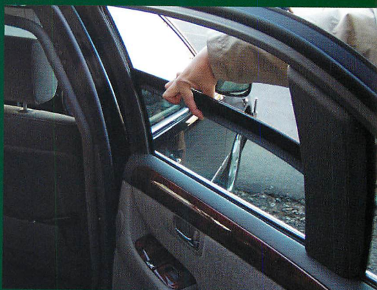
▲後部座席のウィンドウは厚さ20mm、二重構造の防弾ガラスだ。
