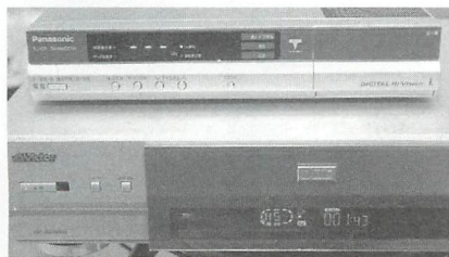
▲iLINK接続をすると録画モードの表示が「AUT」(オート)になり、放送形式に合わせて自動的に録画モードが決定される。ハイビジョン放送が始まると自動的に「HS」モードとなる。
