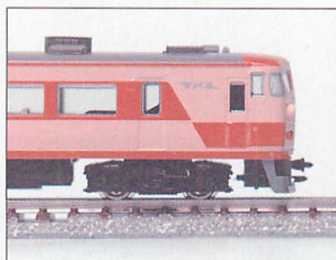
▲伸縮カブラーを装備したカトーの先頭車には泣き所がある。伸縮カブラー（連結器）のユニットが大きすぎて正規の位置だと台車が干渉するために、先頭部の台車が後方に下げられている場合が多いのだ。左は伸縮カブラーが標準装備の157系「あまぎ」セットの先頭車。右はお召しセットの先頭車で、ダミーカブラーが装備されている車両。扉の位置と台車のセンター位置を見比べてみると、一目瞭然だ。なお157系の場合、「あまぎ」セットがお召しセットの1年以上も前に発売されているため、お召し編成のためにわざわざ改良したことになる。
