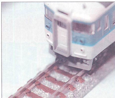
▲トミックスの密連形TNカプラー。実車の密着自動連結器をよく表現している。
