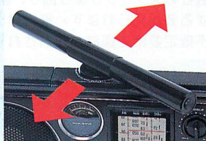
▲クーガシリーズ最長のジャイロアンテナ。矢印の方向に指向性がある（強く電波を受けられる）。
