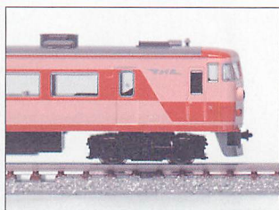
▲伸縮カブラーを装備したカトーの先頭車には泣き所がある。伸縮カブラー（連結器）のユニットが大きすぎて正規の位置だと台車が干渉するために、先頭部の台車が後方に下げられている場合が多いのだ。左は伸縮カブラーが標準装備の157系「あまぎ」セットの先頭車。右はお召しセットの先頭車で、ダミーカブラーが装備されている車両。扉の位置と台車のセンター位置を見比べてみると、一目瞭然だ。なお157系の場合、「あまぎ」セットがお召しセットの1年以上も前に発売されているため、お召し編成のためにわざわざ改良したことになる。
