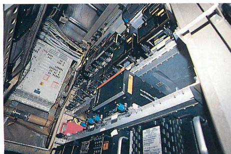
▲B777の心臓部であるコンピューターなどの電子機器が置 かれる部分。ユニットごとにラックに収まっているので、 不具合のあるときはユニット単位で差し替える。
