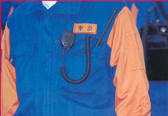
▲胸ポケットに入られていた携帯機。スピーカー・マイク前面に新たにボタンが設けられている。緊急発信スイッチは従来どおりコード脇に設置されている。
