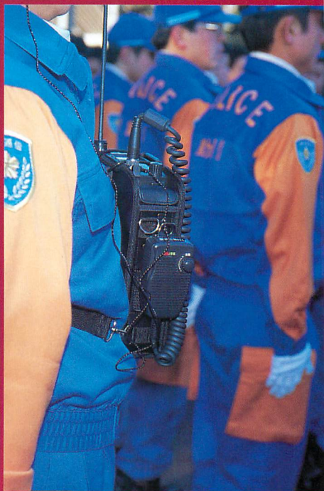
▲ポータブル機のスピーカー・マイクには音量調整が設けられている。マイク上面にはコールサインが貼られている。
