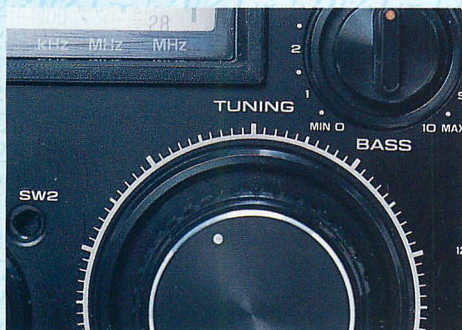
▲チューニングダイヤルには白い点が付けられ、ダイヤルの周囲には目盛りが付けられているが、周波数直読できるわけではない。あくまで目安に過ぎない。
