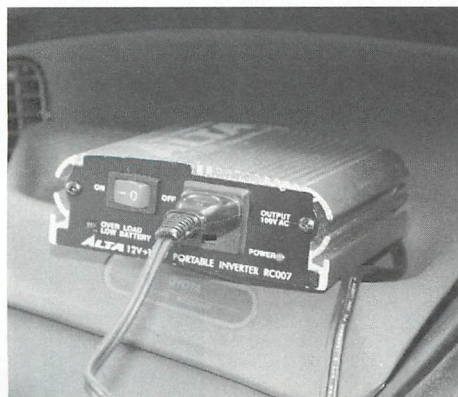
▲チューナーの電源はAC100Vなので、インバーターを用いて、DC12VをAC100Vに変換する。
