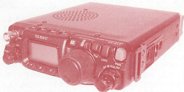
▲可搬型無線機、バーテックススタンダードのFT-817は短波帯の電波を出せる持ち運び可能な無線機。これで世界中に届く電波をどこでも出せるようになった。
