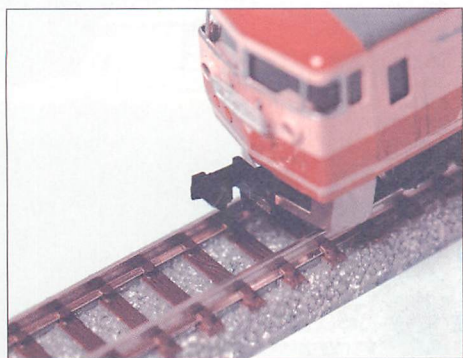
▲Nゲージの共通規格のカプラーが、写真のアーノルドカプラーだ。お世辞にもリアルとはいえない。機関車や貨車、一般客車では、このタイプが主流だ。写真の車両は、マイクロエースの前身、しなのマイクロの157系。
