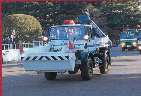
▲災害救助に威力を発揮する、多目的災害対策車。メルセデスベンツのウニモグがベースだ。
