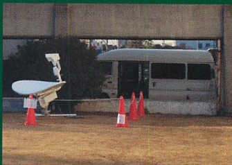
▲会場敷地内に設置された衛星中継のアンテナ。その後方には中継車が止まっていた。
