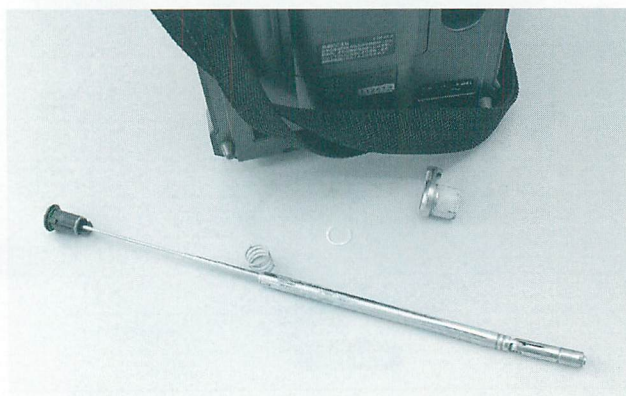
▲アンテナはロックレバーごと抜けてしまった。基部そのものが崩壊しているようだ。ただ、ロッドアンテナは錆汚れだけで、ほとんど無傷だった。
