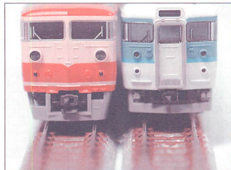
▲カトーの密連形伸縮カプラーとトミックスのTNカプラーを比べてみた。同じ若干サイズが異なり、そのまま連結が出来ないようにになっている。
