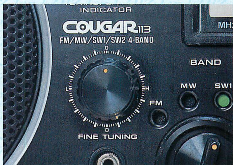
▲周波数を微調整するためのファインチューニングツマミ。グルグル回転するが、可変する範囲は一定（最大可変範囲までいくと最小に戻るようになっている）。
