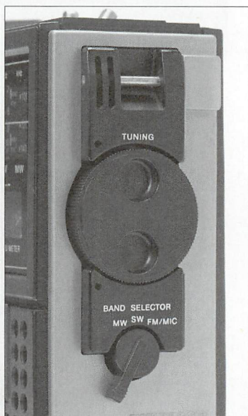
▲メインダイヤルは右側側面に配置されている。直径は4cmという大型のものだ。
