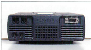
▲送信部には、コントロール部との接続用、マイク用のモジュラージャック、CWのバドルや電鍵用ジャック、外部接続用のシリアルコネクタがある。また吸気口も見える。
