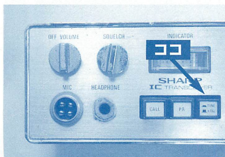
▲Sメーター下にプッシュ式のスイッチが3つ並んでいます。この一番右側を押すことによって、2つの選局ツマミの操作を切り替えます。
