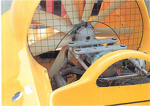
▲エンジンは後部のファンを回す。そのファンの生み出す後流は、前進させるだけでなく、船を浮かべるためにも利用される。
