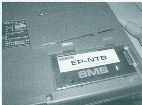
▲ジャンクの方には、発売当時、非常に高価だった8MのRAMが搭載されていた！コレももちろん移植する。
