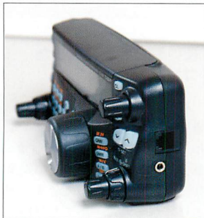
▲コントロール部には、送信部との接続用とイヤホンジャックしかコネクタがない。
