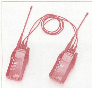
▲DJ-R20D純正オプションのレピーター ケーブルをセットしたところ。長 さは80cmあるので、2台を離して設 置することも可能だ。
