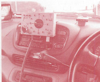
▲自動車のコックピットに見やすく信号強度計をセッティングしたところ。
