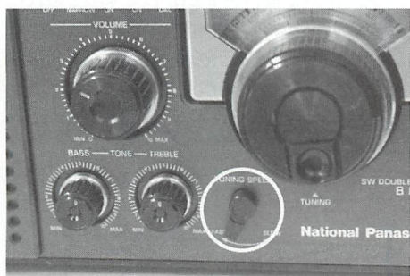
▲ダイヤルと周波数スケール部分。糸かけプーリーとギアの組み合わせの構造になっている。
