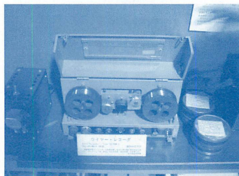
▲写真7：テープレコーダー以前の録音装置、「ワイヤーレコーダー」は、結構コンパクトでした。
