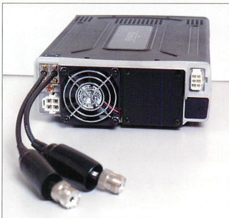
▶電源コネクターやアンテナコネクターが2つ見える。なお、200Wのハイパワーモデルでは、クーリングファンが2つ搭載される。
