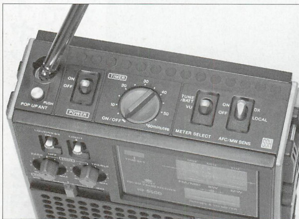
▲本体上面にも操作部がある。真ん中の丸い回転ツマミは60分タイマー。ラジオを聞きながら眠るときに重宝した。発売当時は深夜放送全盛期だったので、タイマーは多機能ラジオの必需品だったのだ。
