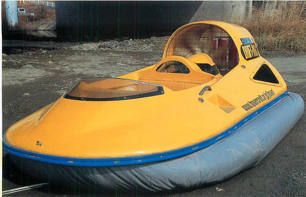
▲2人乗りのホバークラフト「ドリフトMibō」。船舶下部の膨らんでいる部分がスカートと呼ばれる。
