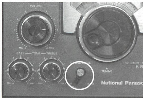
▲チューニングスピードの切り替えツマミの形状が異なるものがある。ツマミの中央にアルミ板が貼ってあるのか、そうでないかの違いだ。
