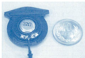
▲片耳イヤホンのドライバーユニット。10円玉とほぼ同じ大きさなので、ケースに穴を開ける際は、10円玉をガイドにするといいだろう。
