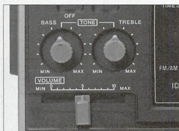
▲ラジオもハイファイ機器のひとつだった当時、音質調整も欠かせない装備。本機にはバス（低音）／トレブル（高音）調整が付いていた。これはその後の機種にも受け継がれる。音質調整ツマミの下にはボリューム（音量調整）がある。スライド式なのはスカイセンサー5500の特徴だ。
