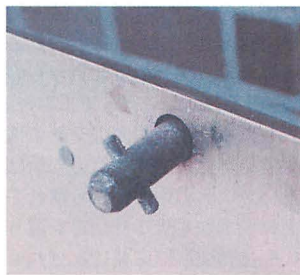
▲シールド板はネジ止めではなく、写真のようなロック機構。90°回すとロックできる。
