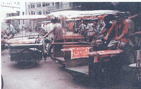
▲中国の交通手段を語るときに欠かせないのが、この輪タク。ただしこの写真に写っている輪タクは、延辺自治州だけに見られる特殊なもので、ご覧のように日本のリヤカーの荷台に、自転車の後ろ半分をくっつけたような構造をしている。これだと荷物も運べるし、人間も最大4人までなら乗れる。荷台部分の作りはまさにリヤカーそのもので、これも日本統治時代の影響らしい。
