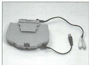
▲両方の変換ケーブルをつけてみた。同じジャックを使わないのは、F型から入力したものを、RCAで出力することもできるからだろう。
