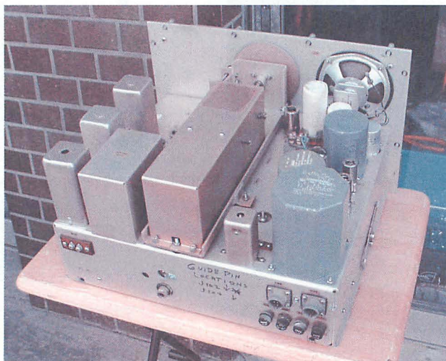
▲キャビネットから引き出すと右手前にはSP-600のような電源トランスがある。
