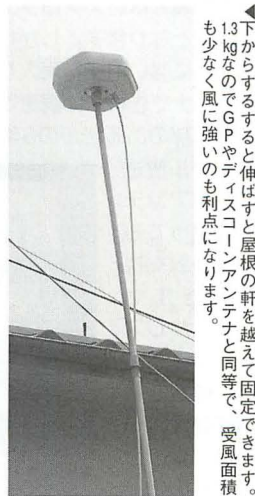
▲アンテナ設置がどれだけ簡単か実証しました。2階のバルコニーに伸縮マストを固定し、先端にアンテナを乗せます。
