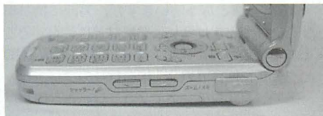
▲本体側面、右側にはカーソルキーがある。本体を閉じたときは、これで音量やチャンネルを操作する。
