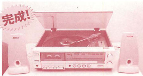
▲「H195」スピーカーの接続コードにはRCAプラグが装着されていたが、切り取って芯線のみにして、JJ-500につないだ。harman/kardonのフラシーボ効果なのか、心地よい音が鳴り響いた。
