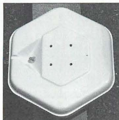
▲裏側には内部の空気の熱膨張による破裂防止の空気穴と取り付け金具のネジ穴と同軸ケーブルコネクターというシンプルなものです。
