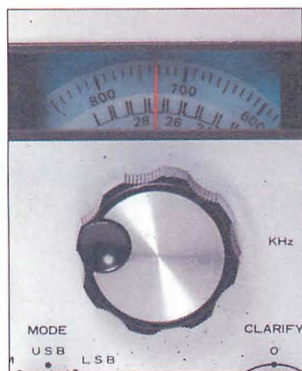
▲メインダイヤルと周波数表示。ダイヤルを回すとkHz台の円盤（外側）が回る。内側のMHz台の円盤はMHzツマミで動かす仕組みだ。MHzの周波数表示は幅があるもので、MHzツマミでおおまかに枠に入れておけばいいという仕組みになっている。
