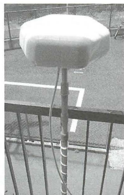
▲アンテナ設置がどれだけ簡単か実証しました。2階のバルコニーに伸縮マストを固定し、先端にアンテナを乗せます。
