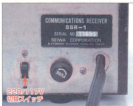
▲電源切替スイッチあり220V、117Vの商用電源に対応する。
