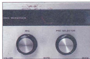
▲MHzツマミ（左）は、周波数表示のMHz台の円盤を回すもの。そのとなりはプリセレクトー（PRE-SELECTOR）ツマミ（右）。プリセレクトーは周波数を合わせてから、最高感度になるように調整する。
