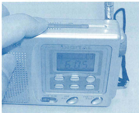
▲短波のバンド切替は上面のスライドスイッチで設定します。
