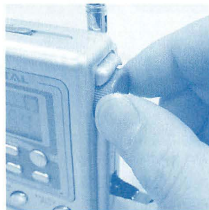
▲選局はアップダウンキーではなく、回転ツマミで行います。中波は9kHzステップではなく1kHzステップで変わっていきます。短波も同様のので6.055などの細かい周波数は表示できません。6.05か6.06で微妙に調節できるようになります。
