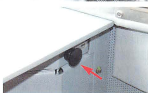
▲KTXは、機関士が一定の操作をしないと警報音を鳴らす装置が備えられている。スピードコントロールレバーの接点、ペダル、運転台端のボタン、一定時間内に決められた操作をしないと警報音が鳴り、放置すると自動的にブレーキがかかる仕掛けになっている。
