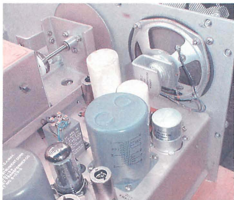
▲中央の丸い円柱形のトランスが出力トランス。直径10cm程のスピーカーは納入メーカーと同じゼネラルインストルメント製。
