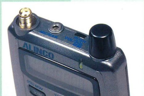
▲上部ダイヤルは、そのまま回せば周波数変更、1回押すとボリューム調整、再度押すとスケルチ調整へと切り替わる。マイク兼イヤホン端子のサイズは2.5mm。アンテナ端子はSMAとなっている。ボタン横の四角い穴は、ストラップなどを通すためのものだ。
