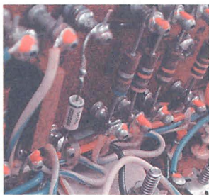
▲換液は真空管ではなくゲルマニウムダイオード1N198 (ラグ板中央) を使用している。
