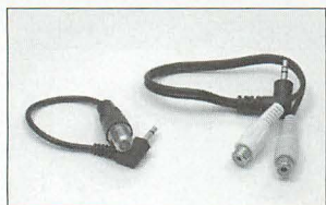
▲付属の変換ケーブル。構造は簡単なので、ちょうどいい長さに自作するのも可能だ。
