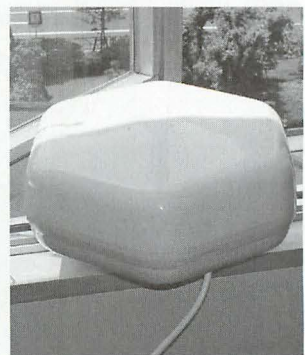
▲受信はこのように窓の部分に置いておくだけで受信できました。八木では窓から外に出しても受信できませんでした。
