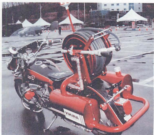
▲屋外展示コーナーでみつけた消防バイクです。日本のミストドラゴンに比べると格段に大きく、迫力があります。ホースと車体格納の水タンクへのパイプが印象的です。
