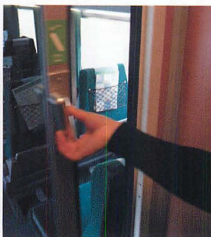
▲半自動式のドアは、レバーを下げることでドアが開く。荷物を持っていると開けにくい。しかも、センサーが鈍く、立ち止まっているとドアにはさまれる！
