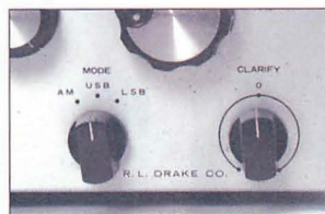
▲メインダイヤル下にはモード切り替え（MODE）ツマミ（左）、受信周波数微調整（CLARIFY）ツマミがある。SSB（CW）の受信も可能で、アマチュア無線や業務無線の受信にも活用できた。
