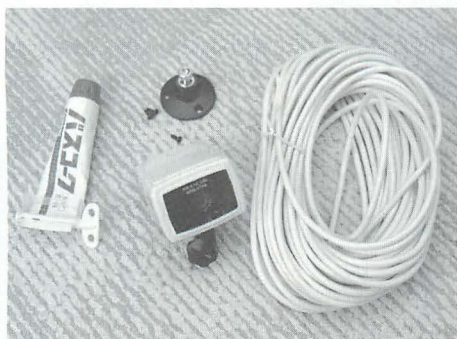
▲購入した増設カメラ「CA-151」。屋外設置のため「AIタイプ」を購入。そのまま設置したのでは不具合があるため、改造する。「バスコーク」は必需品だ。
