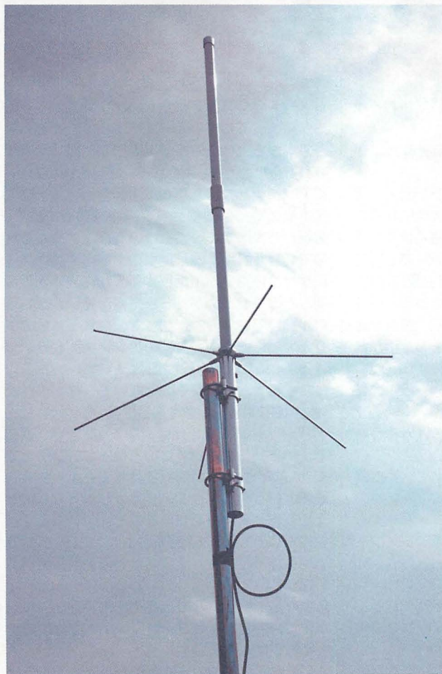
▲ミサキコーポレーションのコードレスホン用外部アンテナ。約1.3m長、6本のラジアルが付く本格的なアンテナだ（アンテナ単体、特価20,790円）。できるだけ高く上げたい。300MHz帯の受信アンテナとしても十分実用になる。
