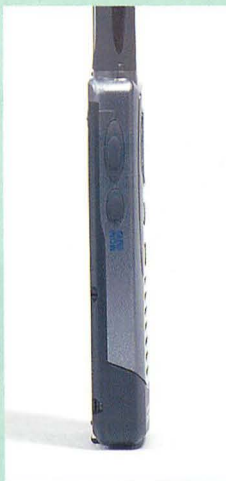
▲奥行きは14.5mmの超極薄。58X高さ96X奥行き14.5mm、重量102.9g(電池、アンテナ込み)になっている。メーカー公表値で幅
