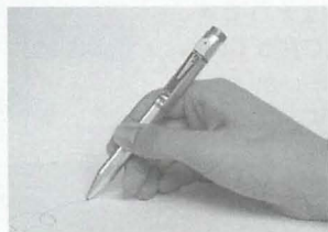
▲ペンとしても使える「P-cam」。赤外LEDを搭載しているので、暗闇でも撮影可能だ。
