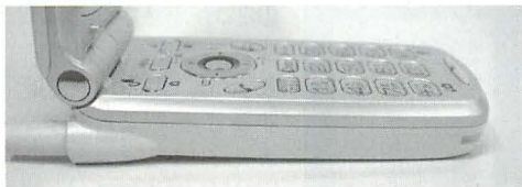
▲本体側面、左側。「J-T010」では、SDカードスロットがあったが、「V401T」には何もない。おそらく、カードスロットの代わりにチューナーを搭載したのだろう。
