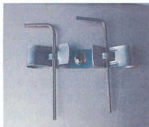
▲バリコン用シールドケースの横には通称菊型レンチと呼ばれる工具が付いている。バリコンのシャフトのカップリングを外すのに使用。
