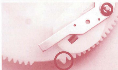
▲○印が音が鳴る原因の「最後の1歯」。上がそのままの状態。特に磨耗しているようには見えなかった。ここに瞬間接着剤を塗って肉盛りし、軸のギアに確実に噛み合うようにした。下がパテ盛り成形後で、かさ上げしているのがお判りになるだろう。この修正で、問題は決着した。
