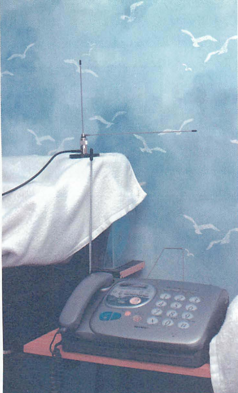
▲親機のそばにプローブアンテナを置く。親機とアンテナの距離、向きにより誘電効果の度合いが変わるため、いろいろ実験して、もっとも良好に通話できる場所を探すといふ。
