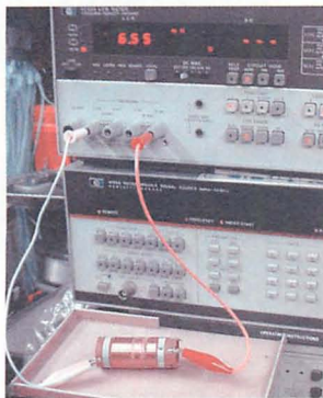
▲写真6: 高1DETコイルのプレート巻線の実測。だいたい6.5mHになっている。
