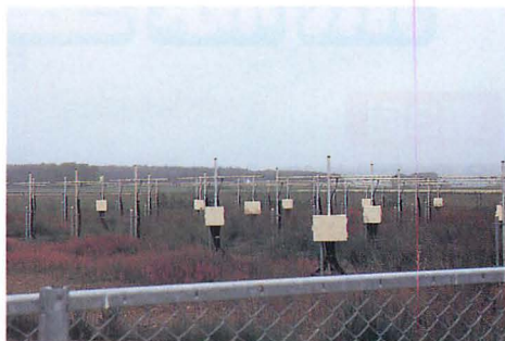
▲上空約100kmまでの超高層大気変動を詳細に観測する「VHFレーダー」。一見、服のないカカシに見えるアンテナが、48本設置されている。
