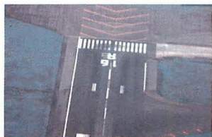
▲16という数字を消して16Rに書き直したのがわかる滑走路エンドの文字。成田空港は長い間1本の滑走路の運用だったが、平行する滑走路が新設されたため、従来の滑走路は16から16Rと名称が変わったのだ。
