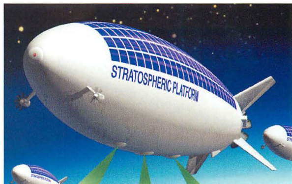
▲成層圏プラットフォームの実用化機の想像図。太陽電池パネルを装備し、約20km上空で静止する。(提供：JAXA)
