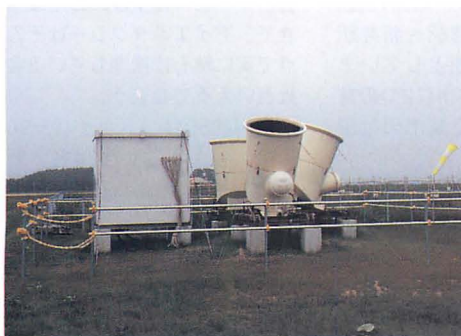
▲ドップラー効果を使って風速の上下成分を測定する「ドップラーソーダ」(音波レーダー)。音波で計測するため、常に「ピーッ、ピーッ」と音を発して、結構うるさい。
