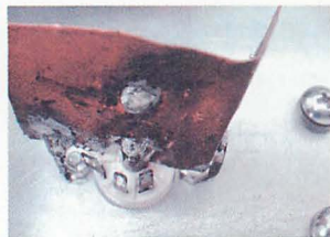
▲写真10：入力1番ピンと出力7番ピンの間に銅板でシールドする。
