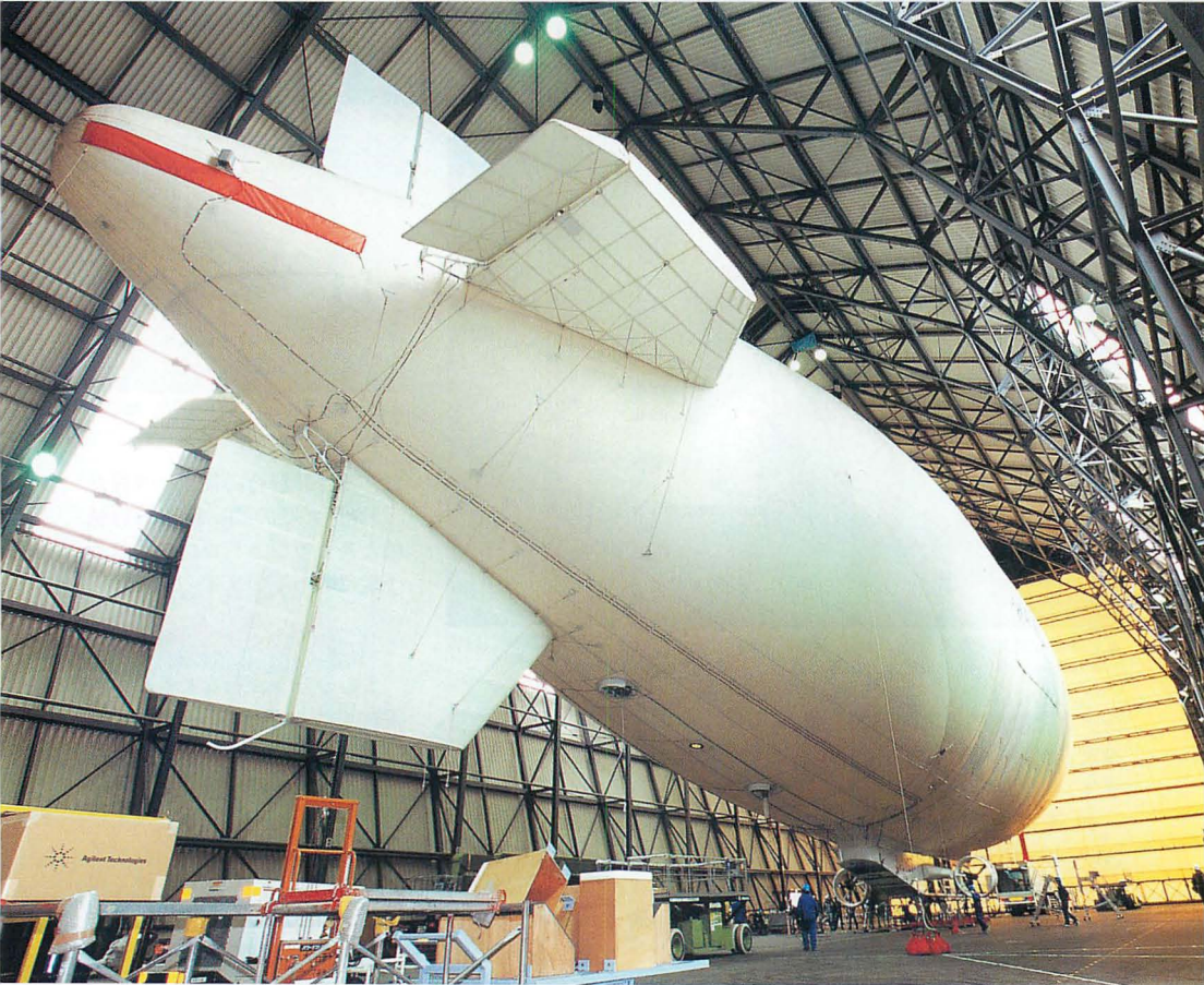
▲後方から見た飛行船。尾翼は垂直・水平とも2枚ずつの計4枚。方向転換と、軽微な上昇・下降は、尾翼で行なう。
