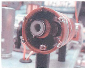
▲写真5: 並四コイルにRFCを入れたら高1DETコイルのできあがり。
