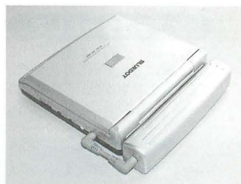
▲本体後部にバッテリーを装着し、接続コードをDCジャックに差し込めば、バッテリー運用スタイルの開始です。
