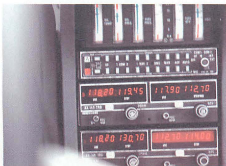
▲無線機の周波数表示に注目。左上のディスプレイの118.20MHzは成田タワー、119.45MHzは成田TCAの周波数。
