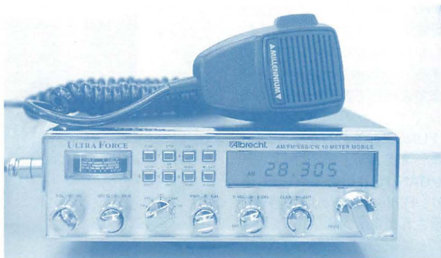
▲10mBANDアマチュア無線としてミサキコーポレーションで新発売された、28MHzオールモードトランシーバー、Albrechtの「ULTRA FORCE」(31,290円)。コマンド入力でHigh-Powered CB帯もカバーする無線機となる。マイクは先月号のCOCKER41と同じデザインだ。
