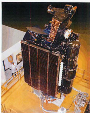
▲打ち上げ前のモバイル放送衛星。大型メッシュアンテナは、右側にコンパクトに折り畳まれて、衛星に抱きかかえられていた。(モバイル放送提供)
