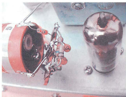
▲写真14：ゲルマニウムダイオードを使った包絡線検波回路。
