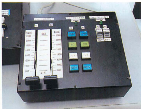
▲右のコントローラーは、プロペラの回転数などを指示する、言わばアクセルの役割を担っている。
