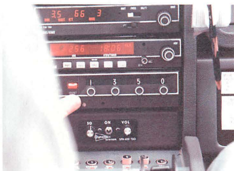
▲成田TCAの指示により、スクークコードをセットしたところ。1350がスクークコードだ。
