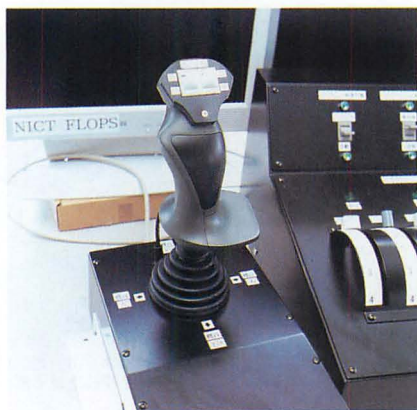
▲センターのコントローラーがメインの制御機。バロネットのバルブの制御やプロペラの角度、速度を調整する。
