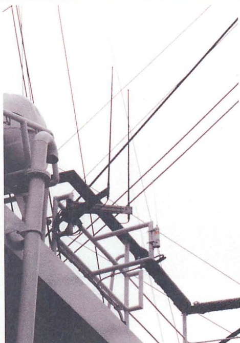
▲日本丸に設置されていた船舶無線のアンテナ、JRC製でした。マストの中央部分にも各2本ずつ設置されています。
