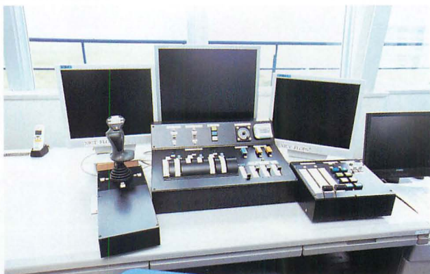
▲飛行管制棟3階に設置されている、飛行船のコントローラー。一見、ゲームのコントローラーのようだ。飛行時には、3面の液晶モニターに、飛行状況を想定して造られたCGが表示されるそうだ。
