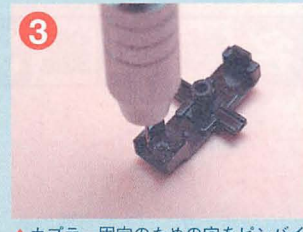
▲カプラー固定のための穴をピンバイスで2個開ける。今回はポケットライン動力に合わせ、アーノルドカプラーをチョイス。カプラーは20個入りで315円だ。
