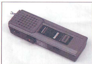
▲付属のトランシーバーは1ch・送信出力50mWとはいえ、単体で使える立派なCB機だ。
