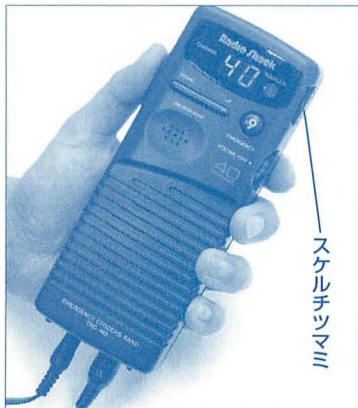
▲曲線的なデザインが特徴のTRC-463。40ch AM 5Wで右側面にはスケルチツマミを装備している。
