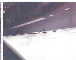
▲地方のバスにはGPS受信アンテナも付いているところもあります。茨城県の日立電鉄バスは150MHz帯無線とGPSアンテナが屋根に付いています。
