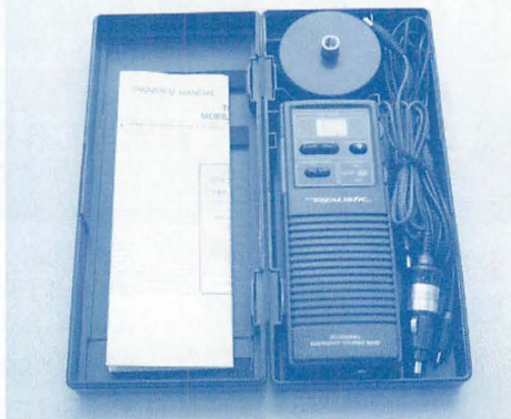
▲プラスチックケースをに収まったTRC-409。無線機本体、アンテナ、アンテナ基台、シガープラグなどがコンパクトに収納されているのがわかる。
