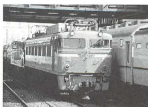
▲直流区間と2つの交流区間を走ることができる「EF81形電気機関車」。寝台特急「北斗星」や「カシオペア」の本州部分の牽引機としても使用されている。
