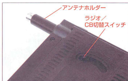
▲ラジオとCBトランシーバーの切替は背面のスイッチで行う。スイッチをCB側にすると(写真の状態)、アンテナホルダーが飛び出し、ロッドアンテナが垂直にしか伸びないようになる(普段、ロッドアンテナは可倒式)。
