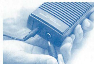
▲アンテナケーブルには、オーディオ機器などでおなじみのRCAジャックを採用。無線を知らないユーザーへの配慮だろうか。
