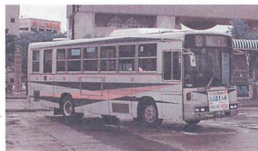
▲地方のバスにはGPS受信アンテナも付いているところもあります。茨城県の日立電鉄バスは150MHz帯無線とGPSアンテナが屋根に付いています。
