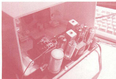
▲裏ブタを開けると、「秘密のバール」があらわに！5球スーパー・トランスレスタイプで、1枚の基板上にコイル、バリコン、真空管などが並べられて小型化されていた。
