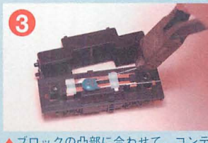
▲ブロックの凸部に合わせて、コンデンサの位置を変え、余った足をカット。これでカプラーを元に戻せば装着できる。
