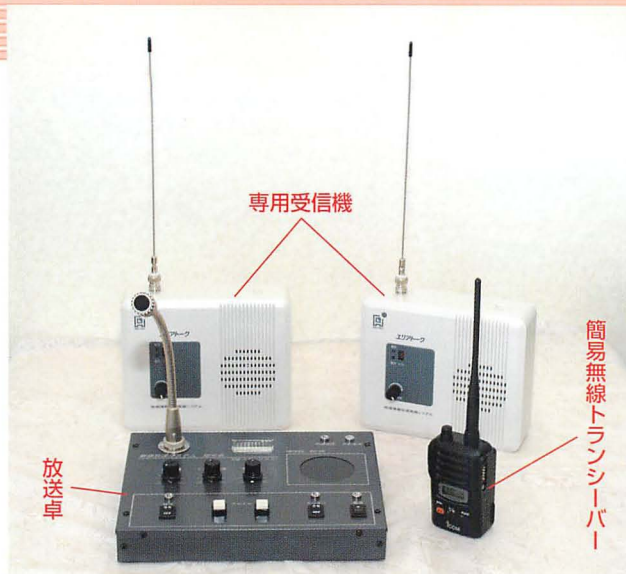
▲エリアトークのシステム。放送用の簡易無線トランシーバー（これは一般の無線機）、専用受信機、トランシーバーに接続する放送卓から構成される。受信機は、トランスケルチが装備され、目的の電波だけ捉えるようになっている。最新機種では、送信側の操作で電源を入れたり、音量を最大にすることができる。非常時に有効な機能だ。放送卓は、簡単なボタン操作だけなので無線ということを意識せず使える。
