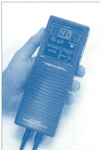
▲40ch AM5Wのハンディタイプ機であるTRC-409。LEDによるチャンネル表示の下に、チャンネル切り換えのUP/DOWNキーとEmergencyキーを装備している。
