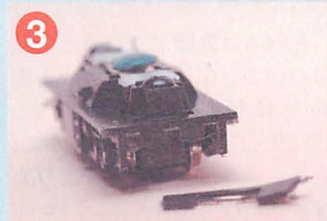
▲スカートを切り取ったところ。この後、切断面をキレイに仕上げる。
