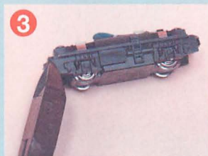
▲スカートの後退角が大きいため、動力の台車部も1mm程度カットする。これで加工が完成だ。
