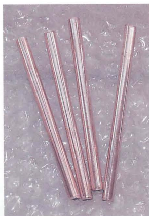
▲8.5cmに切り出した真鍮パイプ。ダイヤモンド屑付きの三角形棒やすりでパイプを削り、1周以上凹みがでるくらいにして手で折るとバキッと取れます。
