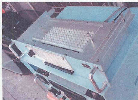
▲写真3：キャビネットからメモリーユニットNW-3443を引き出したところ。64個の水晶を差し込める。
