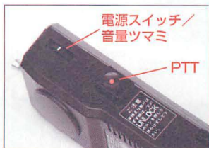
▲付属トランシーバーの側面。電源スイッチを入れればあとはPTTを押すだけの簡単操作。
