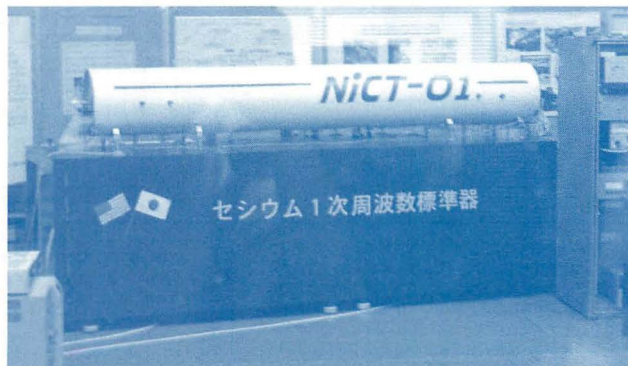
▲写真-7: 日本標準時のもととは、セシウム原子時計で、昔の電波研究所(今はNiCT)で管理されています。2004年7月、NiCT公開日に撮影。
