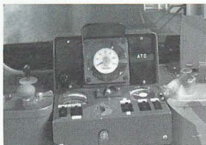
▲ATCが設置された運転台（東京メトロ6000系）。車上信号式を採用しており、速度計の周りにある指標が点灯し、制限速度を表示する。
