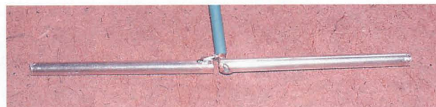
▲カットした真鍮パイプに予備ハンダしておき、同軸ケーブルを芯線/網線ともに直接ハンダ付けします。80ワット程度のコテだと楽に作業できます。
