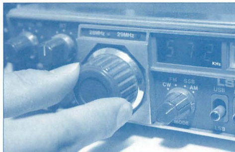
▲周波数はkHz台がLEDによるデジタル、MHz台は選局ツマミの上的LEDランプで表示。
