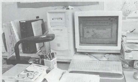
▲受信したデータは、グラフ化され、このパソコンで自動的に10分ごとWebにアップロードされている。卓上蛍光灯の後ろにある黒い小さな箱にA/Dコンバーター「GID-ADC」が入っている。他の観測点は最新改良型の「GID-GV」になっているようだ。
