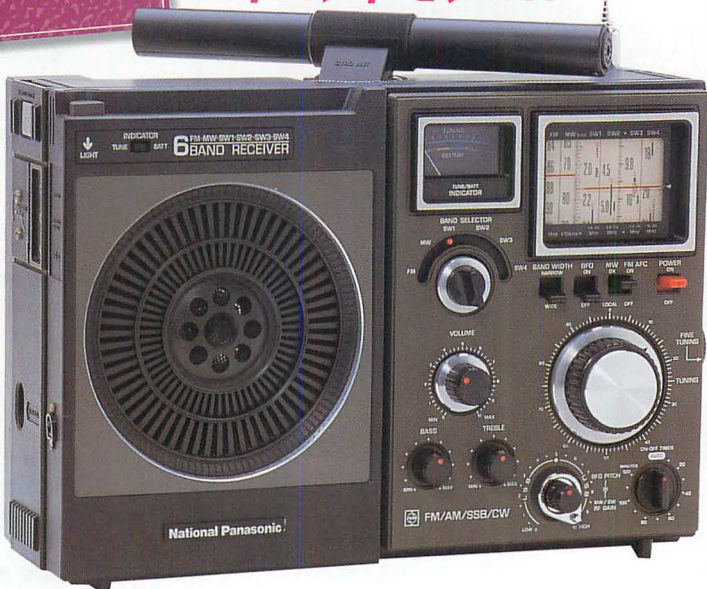
▲松下電器のクーガ118D。クーガ118のマイナーチェンジ機種だ。フィルムスケールが白くなり、ファインチューニングツマミやBFOが搭載されるなど機能アップが図られている。クーガ118は有名だが118Dはあまり知られていないはず。
