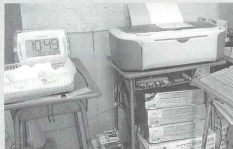
▲プリンターの下に設置されているのが、受信音を録音するタイムラプスビデオ、左の時計と共に記録されていた。記録した波形が何なのかを解析するために受信音を記録していたが、現在は休止中。
