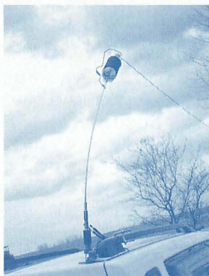
▲私が移動時によく使用している自作の1.9/3.5MHzモバイル用ワイヤーアンテナ。
