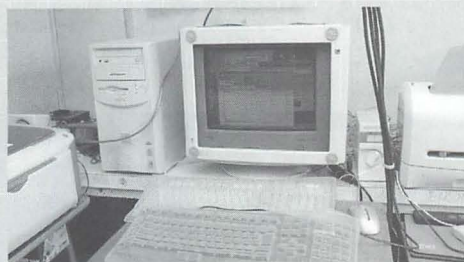
▲受信機が捉えたノイズはすべて音声出力から整流して直流電圧に変換後A/Dコンバーター介してパソコンに送られ、フリーソフト「Gyotoku Multi Version1.0.2」にてデータ収録される。奥に見える受信機はアイコムIC-706MK IIで、これは福井県鯖江市の流星電波観測(HRO)専用の電波を受信しているものだ。
