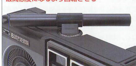
最高感度になるよう回転させる
