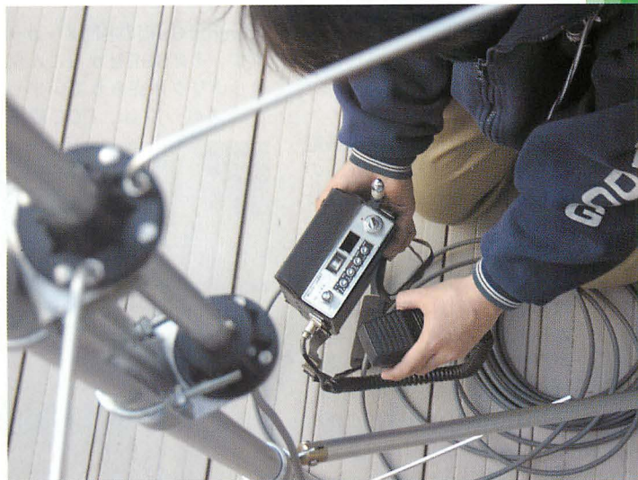
▲完成したGPV-27で受信テスト。ローカル局の電波がいつになく強力に入ってきた。
