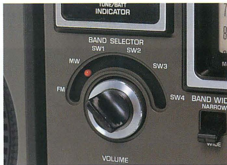
▲バンド切り替えスイッチ。本機はFM、MW (中波)、短波を計6バンドで受信する。短波帯1.6～30MHzは、SW1～SW4の4バンドでカバーしている。
