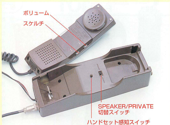
▲ハンドセットを本体から離すと、本体中央部にSPEAKER/PRIVATE切替スイッチが現れる。このスイッチをPRIVATE側にする、ハンドセットからしか受信音が聴こえなくなる。SPEAKER/PRIVATE切替スイッチの下にある突起はハンドセットの状態を検知するスイッチで、ハンドセットが本体に置かれた状態では、受信音が外部スピーカーに流れる仕組みになっている。ボリュームとスケルチはハンドセット側面にある。
