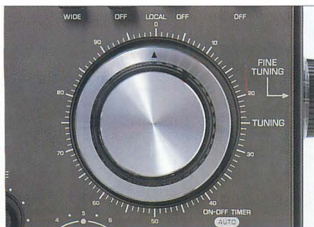
▲大型のチューニングダイヤルは、目盛りが付けられ通信機の雰囲気がある。しかし、これは目安に過ぎず周波数直読ができたわけではない。
