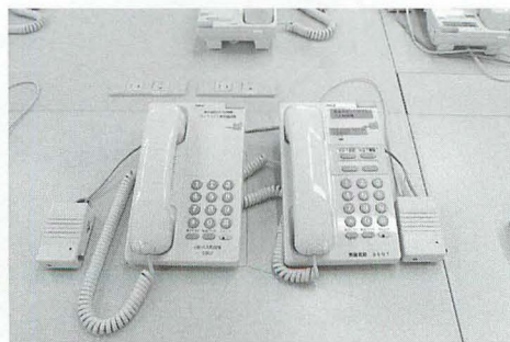
▲通信室の端末。電話機と無線機の両方を兼ねている。それぞれの端末は、各機関専用のホットラインとなっている。
