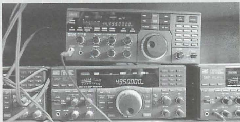
▲行徳高校に設置してある受信機は、日本無線のNRD-525が1台に、NRD-545が4台だ。525はターンスタイルアンテナに、545はそれぞれ八木アンテナに接続されている。すべての受信機はAGCが切つてある。
