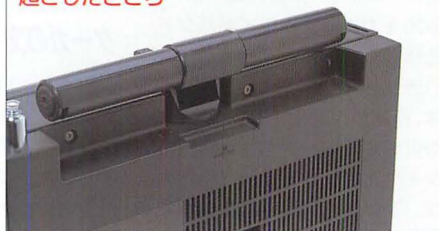
最高感度になるよう回転させる
