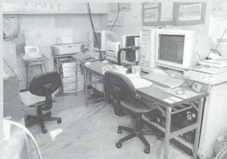
▲地学準備室の一角に設けられている、前兆電波観測の機材。机の下には、屋上のアンテナから送られた電波を受信する受信機が並べられている。
