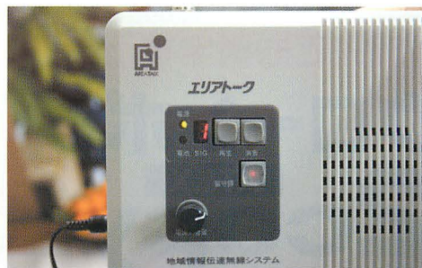
▲「強制録音」モードで送られた電波をキャッチすると、受信機は自動録音。録音が完了するとLEDの数字が点灯し録音済みであることがわかる。「1」は1件録音済みであることを示している。記録は最大15分までできる。
