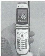
OSにLinuxを採用したN900iL。ワイヤレスLANにも対応し、内線電話と携帯電話の両方をサポートしている。
