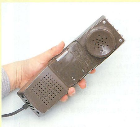
▲PTTボタンはハンドセットの左側の設置されている。左耳で音を聞く人にはよいが、右耳で聞く人には、ちょっとツライ。
