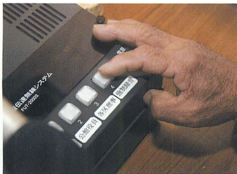
▲「強制録音」キーを押して放送する。すると、受信機側では、自動的に録音モードになり音声をメモリーに記録する。
