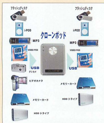
▲USBを介して各種メディアのデータをクローンコピーできる。色々な組み合わせが考えられ、異なるメディア間での転送も自由自在だ。なお、転送可能なUSBメディアはWindowsフォーマット (FAT12・16・32) に限られ、NTFSとMacフォーマットされたものは使用できないので注意しよう。
