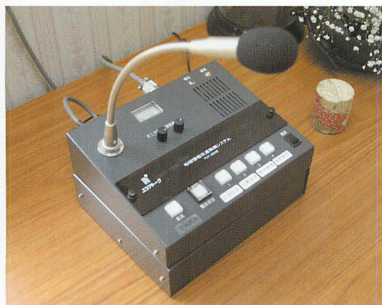
▲エリアトークの送信卓。放送のボタンを押すとチャイムがなって放送スタンバイ、通報が終わったら、もう一度放送を押して放送終了、チャイムがなって停波する。このシンプルな操作方法がエリアトークの特徴。
