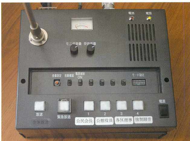
▲最新型エリアトークの操作卓。従来機では全体放送のみだったが、新タイプでは公民会長だけ、公民館役員だけといった相手先を限定した放送を行えるようになっている。また、強制留守録機能、強制的に受信機のスイッチをONにする機能、音量をコントロールする機能などが付いた。こうした操作がワンタッチで行えるのが便利だ。
