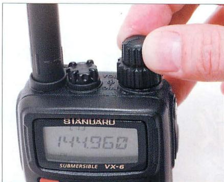
▲メインダイヤルの上部は音声、下は周波数の可変用。ギザギザが指になじんで使いやすい。ダイヤルの隣はマイク/音声端子があるが、普段は防水キャップでふさがれている。
