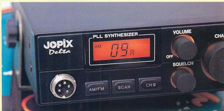
▲マイク端子は5P仕様。CH9にするとA~Fまでの5バンドに切替られる。写真はAバンドの状態、09の表示の右に小さく「A」の文字が見える。
