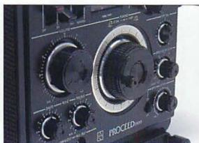
▲チューニングダイヤルは存在感ある大きさ。速度は2段階式で、微妙なチューニングをするときはダイヤルを手前に引き出す(写真右)。すると、ギア比が変わりスローな選局ができる。
