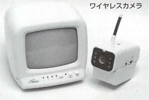
▲ワイヤレス防犯(監視)カメラのセット。カメラとモニターをコードで結ぶ必要がなく設置が簡単。それゆえ普及しているが、電波で画像を送るため、第三者に見られる可能性があることを知っておくべきだ。
