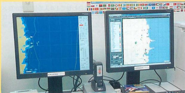
▲田老町がJRCなどに依頼して開発した「GPS携帯電話を使った地域沿岸情報システム」。主に密猟者の監視を行っているが、漁船のGPS携帯電話と同報無線と同じ情報をメールで配信して、防災受信機の役割も持たせている。
