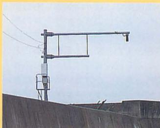
▲田老港に設置された潮位観測システムの検知装置。音波で潮位を測定している。
