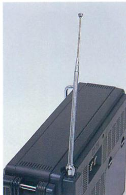
▲ロッドアンテナは可倒式。本機には、中波受信用のジャイロアンテナは装備されていない。
