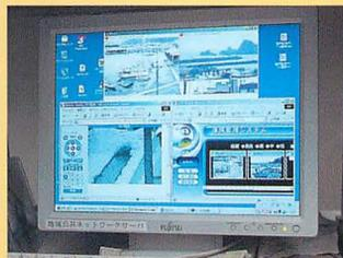
▲防災関係者にのみWebで公開している河川監視システムの映像。松下のWebカメラを流用している。
