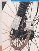
◀ディスクブレーキ/中級～高級のMTBに多く採用。天候の影響をあまり受けずに強力な制動力を発揮する。オイル式とワイヤー式があり、前者が高級仕様だ。そのリアに効果は一度味わうと、もう元には戻れないほど感動する。
