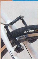
◀Vブレーキ/MTBを代表するブレーキ。ディスクブレーキに肉薄する強力なストッピングパワーを持つ。構造が単純なので、メンテナンスもしやすい。リムとのクリアランスも広いので、泥詰まりなどにも強い。
