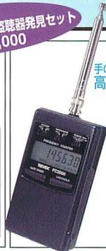
●飛び交う電波をキャッチし、液晶8桁表示のデジタルで表示する。マイクロコンピュータベースの周波数カウンター。自己の送信電波のモニターはもちろんのこと、未知の電波の周波数チェックに最適です(一定レベル以上の電界強度が必要です)・周波数は1Hz～1.3GHzを3レンジで表示・周波数ホール機能付・ディスプレイはバックライト付・電源は単3型4本(別売)
