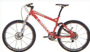
▲路面状況に反応して作動と固定を自動的に切り替え、ペダリングロス排除するというリアサスペンション「LITE BRAIN」を採用。フレームには桁外れの高強度を誇るM5アルミ合金、シマノXTRシリーズをはじめとする最高級パーツなどを使用。[スペシャライズド <http://www.daiwaseiko.co.jp/mtb/>] 写真提供：ダイワ精工サイクル営業課
