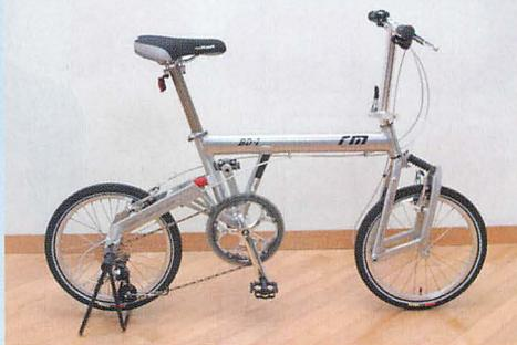
▲登場10年を迎えたミニバイクのベストセラーです。前後には独特のサスペンションを備え、フレームを分割しない方式の折り畳みを採用していますので剛性も高く、18インチの小径タイヤながら安定した走行性能を誇ります。
