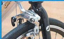
▲サイドプルブレーキ/ロードレーサーやクロスバイクなどに多く採用されるブレーキ。制動力は中庸でスピード調節重視のブレーキだ。
