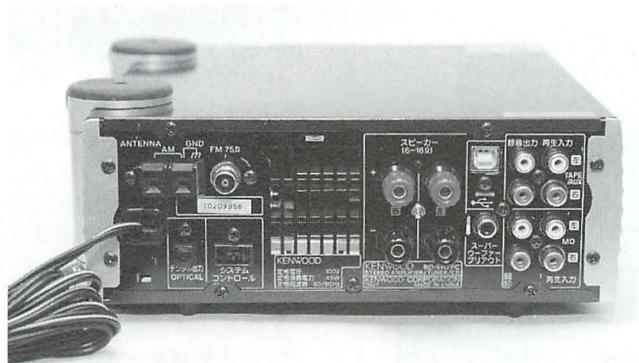
▲「RD-VH7PC」のバックパネル。バナナプラグ対応の大型スピーカー端子に光デジタルアウトプット、外部ウーハー用端子も備えられている。やはり最大の注目点はUSB端子があることだ。
