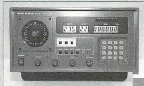
▲大洋無線の方向探知器。いまだにアナログ方式を求める声があるようだが、これはデジタル方式を採用している。
