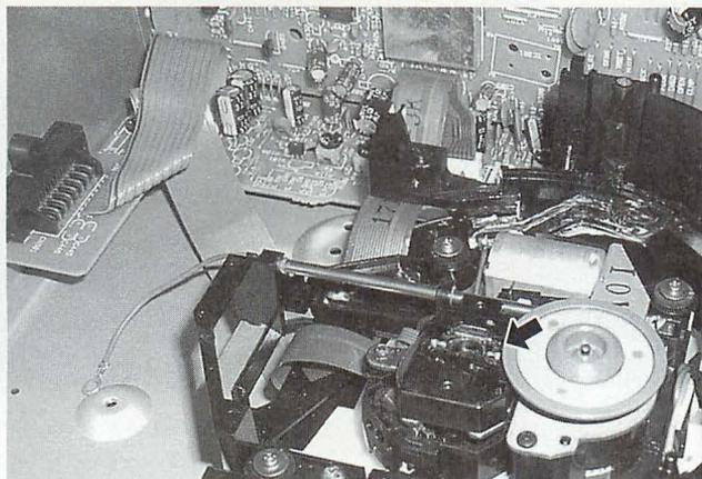
▲確かにCDが動作しないので、CDを分解して見てみると、ピックアップ部のレンズがない!
