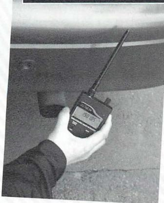
ガレージでは、盗聴発見器を用いて、車に盗聴器を取り付けられていないか調べた。デジタル式盗聴器の電波を感じずアテックスのデジタルバグアナライザーで探る。すると、電波に反応してバグイプレーターがブルブル動作。ディスプレイに1900MHzの数字が現れた。P-HS端末からの電波に違いない!
