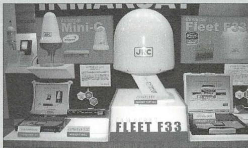
▲GMDSS用機器のラインナップ。中央に見えるレドームの内部はジヤイロによって制御され常に衛星の方向にアンテナが向くようになっている。
