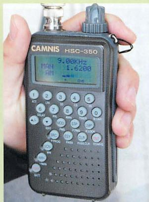
▲中波放送は、スペック外だが、高感度で受信してくれた。1620kHzでは高速道路の路側ラジオの電波が入感。弱い電波を結構拾ってくれる。
