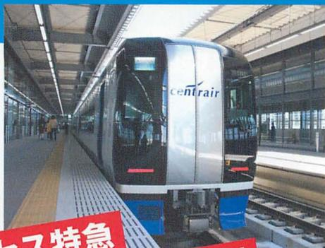
◀3両1編成×2の6両で運転される快速特急「ミュースカイ」。最高時速120km/hで名古屋～セントレア間を最速28分で結ぶ。空気バネによる車体傾斜制御装置が導入され、カーブ走行時の通過速度向上が図られているハイテク車両だ。
