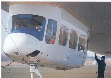
▲ヘリウムガスの充填されている巨大な船体の下部には、ゴンドラが付いている。ゴンドラの定員は14名。船体の大きさからするとかなり小さく見えるが、マイクロバス程度の大きさ。
