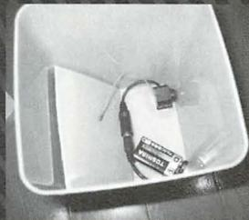
▲公衆トイレのブラシケースに仕掛けられていたワイヤレスカメラの様子。コンパクトで、しかも外からはわからないので、目視での発見は難しい。ただ、ワイヤレスカメラである以上電波を発信するので、コンパクトな盗聴発見器を活用したい。
