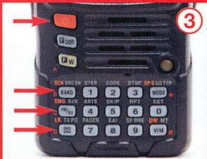
▲続いてコマンド入力。「BAND」+「HM/RV」+「∞」を同時に押しながら電源ON、表示が出るまで押し続ける。これで改造完了。
