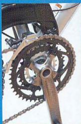
▶MTBでは3枚、クロスバイクでは2~3枚のギアが標準。ギア比が大きいほど多彩なシーンに対応できる。パーツのグレードも多く、クランクと一体型の高級タイプからカラーバリエーション豊かなものまでいろいろある。
