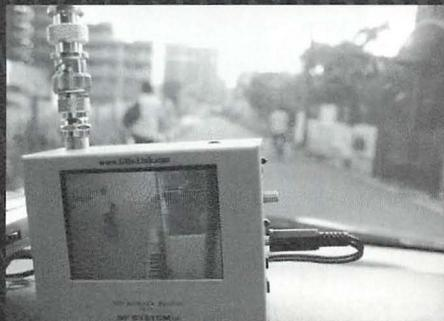
▲一般住宅に設置されている防犯カメラの映像をキャッチ。モニターに自転車に乗っている人が映っている。
