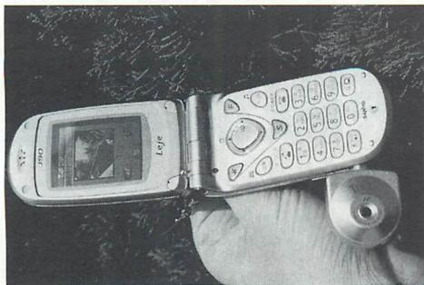
▲トレバを装着し、撮影モードのJ90。トレバは360度回転可能。表示画像を反転させるのにはSキー、撮影はHキーを押す。
