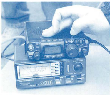
▲7MHzでは1.6程度の数値。給電部が2m程度で無調整でこの数字だから、驚きではある。ちなみにメーカー推奨は、給電部の高さを5m以上にする。
