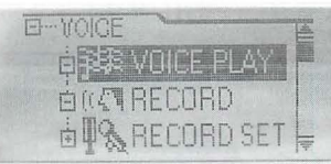
▲ボイスレコーダーモードの表示画面。モードに入ると録音再生などの機能表示になる。
