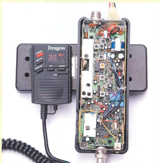
▲内部は1980年代を思わせる作り。ビニールコードも多用している。ボディはプラスチックだが、回路はフレームで保護されているので、かなり強固に仕上がっている。
