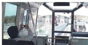
▲コンピューターによる自動運転のため運転士はいない。前方の風景もバッチリ見られる。
