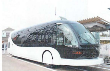
▲曲線的なスタイルが近未来をアピールするIMTS。バスをベースに設計されているが、国土交通省から鉄道事業の許可を受けて運行されている。
