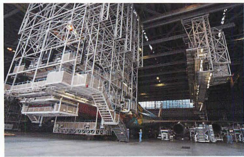
▲整備場に入った機体はドックスタンドと呼ばれる巨大な足場で囲まれる。写真はドックスタンドが外れ、お花ジャンボのボディが見えてきたところ。
