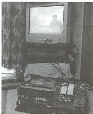
▲テープモードをS-VHSに切り替えると、画像がおかしくなった。本体テープ挿入口下に緑のLEDが点灯している時がS-VHSモードだ。
