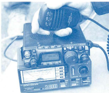
▲28MHz帯では、限りなく1に近いSWR値が…。ダミーロードみたいな数値だが、受信はしっかりできているのだから、ダミーロードなんていうのは失礼だ！
