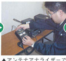
▲アンテナアナライザーでアース後のSWRをチェック。面白いようにSWRが低くなっています。
