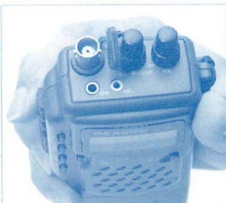
▲アマチュア無線機なので、外部アンテナの接続OK。アンテナとの間にブースターを介することもできる。スピーカーマイク端子も備えている。
