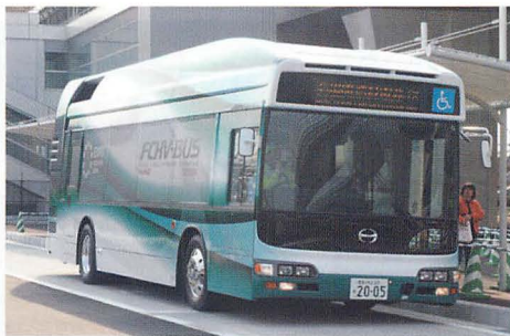
▲屋根に高圧水素タンク、車体後部にモーターや電池を搭載した会場間燃料電池バス。利用者が少なく空いているので移動の裏技としても活用できる。静かな走行音は特筆ものだ。
