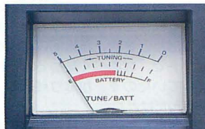
▲Sメーターは0~5の目盛りがふられている。受信報告書に記入するSINPOコードのS0~5をメーター読みできるようにしているのか？
