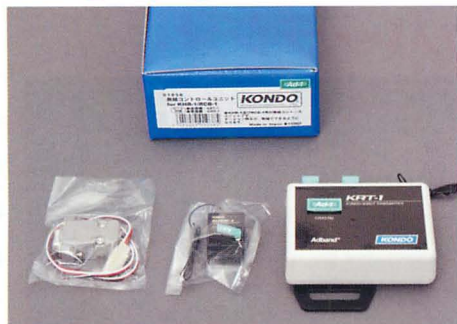
▲無線コントロールユニット。パソコンとの接続を無線によって行なうことができる送受信機のセットで、6波から選択可能 (15,000円)。
