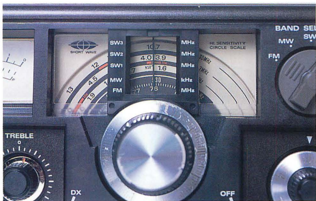
▲ダイヤルは右に回していくと受信周波数が高くなる。一般的なラジオと逆だ。
