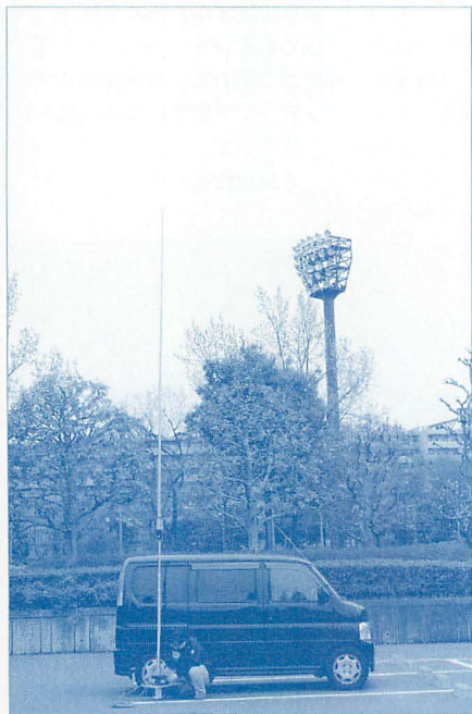
▲タイヤ踏みたて基台を使ってCHA-250Bを設置。基台さえしっかりしていれば、7.13mのエレメントもしっかり自立する。
