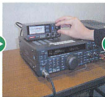
▲バンド内でSWRがどう変わるかSWR計を入れたままでQSO。
