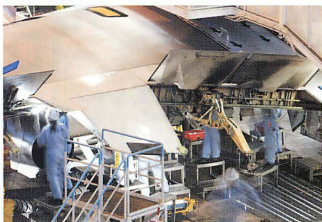
▲フラップが外されると、複雑な構造の主翼内部が見えてくる。そこで行われる作業は意外に細かく根気のいるものだ。
