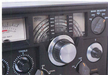
▲ダイヤル周りはメカニカルなイメージを持たせている。ただし、周波数直読機能がなく、あくまで格好よさを追求したのみ。
