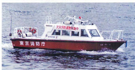
▲デモ航走中の「はやて」です。赤灯と無線アンテナがついたマストが、斜めに倒れます。天井の低い橋などを通過する際にぶつからないようにするための工夫です。
