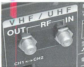
▲アンテナ端子には、買ってきたナットを取り付けて、修理は完全終了。
