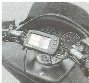
▲ライダーの視点や搭載位置が考慮され、スピードメーターや回転計が見えないようになっている。
