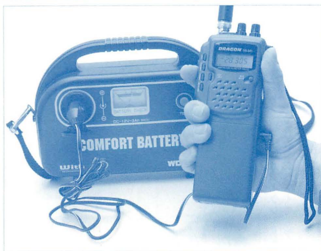
▲DC12Vの外部入力端子を備えているので、ポータブル電源があれば長時間の運用ができる。ハンディ機なのでもとからの消費電力が小さく、こうした外部電源があれば、かなりの時間運用できる。さらに外部アンテナを用意すれば、強力なHF無線システムができあがる。
