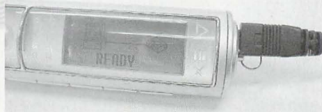
▲専用USBケーブルを使い、コネクタを差し込むとパソコンとの連携モードに入り、「READY」表示が出る。
