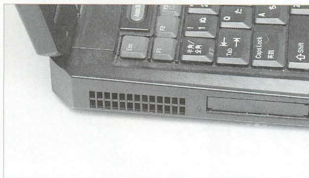
▲高スペックCPUノートの場合は筐体側面に設けられた排熱口から放熱を行う。こういったスペースのため、高性能ノートは必然的に大型にならざるを得ない。
