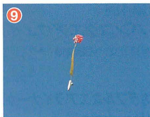
▲上空で、エンジンの逆噴射によりロケットが分離、パラシュートが放出される。安全に降下する。
