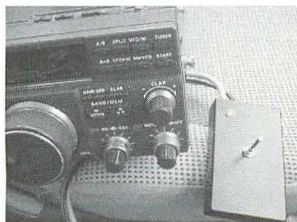
▲AT-300をFT-850で使えるようにした自作コントローラ。
