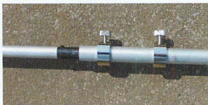
▲エレメントはタッピングビスで留めるが、分解組立が多い使い方では、このような改良留め具を使うとよい。
