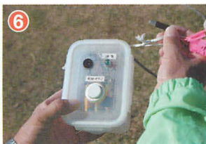
▲エンジンに点火するための電気点火装置。右手に持っているDCジャックが安全装置で、これを端子に挿さないと電気が流れない仕組みになっている。
