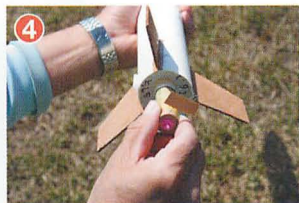
▲エンジンをロケットに装着。エンジン底部のピンク色のパーツはエンジン点火用のイグナイター（電気点火具）。
