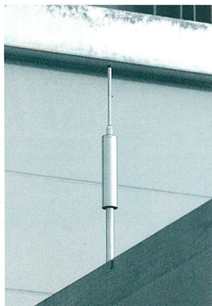
▲会場内警備用無線のアンテナは垂直スリーブタイプ。これが各詰め所に3本ずつ上がっている。
