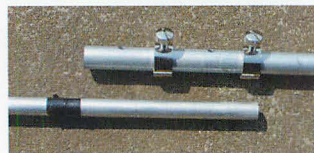
▲エレメントはタッピングビスで留めるが、分解組立が多い使い方では、このような改良留め具を使うとよい。
