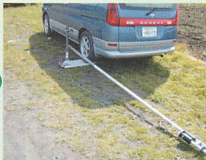
▲アンテナをマストに取り付けた後、マストをボールに差し込む。水平だから作業も楽。
