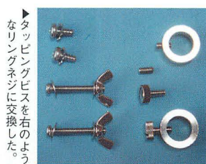
▲こう、工具なしで締め付けることができる。
