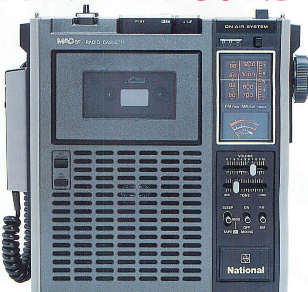
▲松下電器のラジオカセMAC GT(マックジーティー)。側面にカルコード付きマイクが付いていて、無線機っぽい雰囲気。FMトランスミッターを内蔵しているのでミニFM放送をしたり、本機を2台用意してトランシーバーとして活用することもできた。
