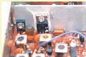
▲終段トランジスタ部、放熱板は本体フレーム部に熱結合されている。
