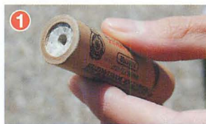
▲これが、モデルロケットのエンジン。20グラム以下の火薬が詰まっている。エンジンの大きさによって、高度やロケットのサイズが決まる。Aタイプと呼ばれる最小のエンジンは約132mの打ち上げ能力がある。価格は3本1,000円。
