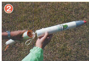
▲ロケットの素材は紙やプラスチック。上空でエンジンが逆噴射し、分離する仕掛けになっている。内部には安全に降下するためのパラシュートが収められている。
