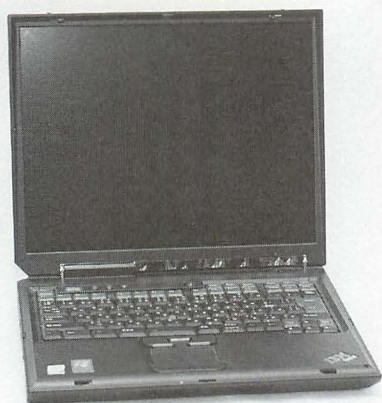
▲IBMのオールインワンノート、「ThinkPad A31P」。コンボドライブに無線LAN、USB2.0とIEEE1394も備えたA5ファイルサイズの巨大ノートだ。
