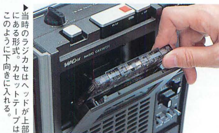
▲大型で使いやすいカセット部の操作キー。早送り／巻き戻しはレバーで行う。
