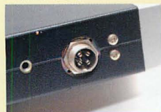
▲4ピンマイクなのでアクセサリも簡単に接続できる。
