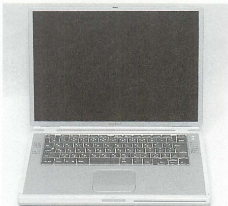
▲近年流行のワイド液晶をはじめて採用したのが、アップルの「PowerBook G4」だ。全体的に薄く作られているため、15インチワイド液晶搭載にもかかわらず、携帯性はよい。
