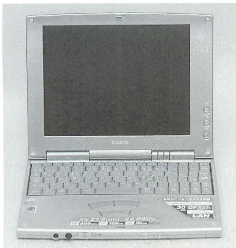
▲ミニノートの代表、A5ファイルサイズのカシオ「カシオベアFIVA」。完全ファンレスでトランスメタ社のCPU「Crusoe」搭載。標準バッテリーで約5時間の駆動スペックを持つ。
